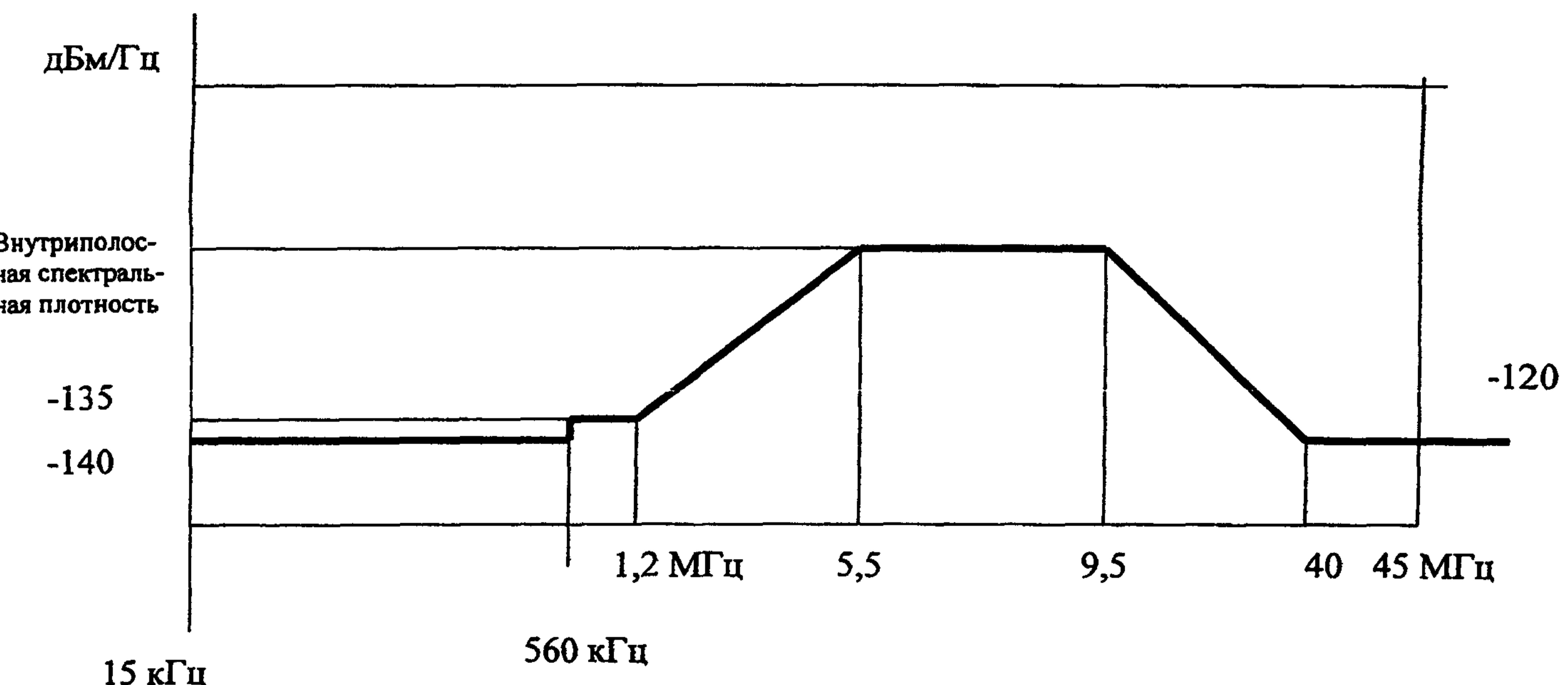
Рис.6.7а. Спектральная плотность мощности выходного сигнала
