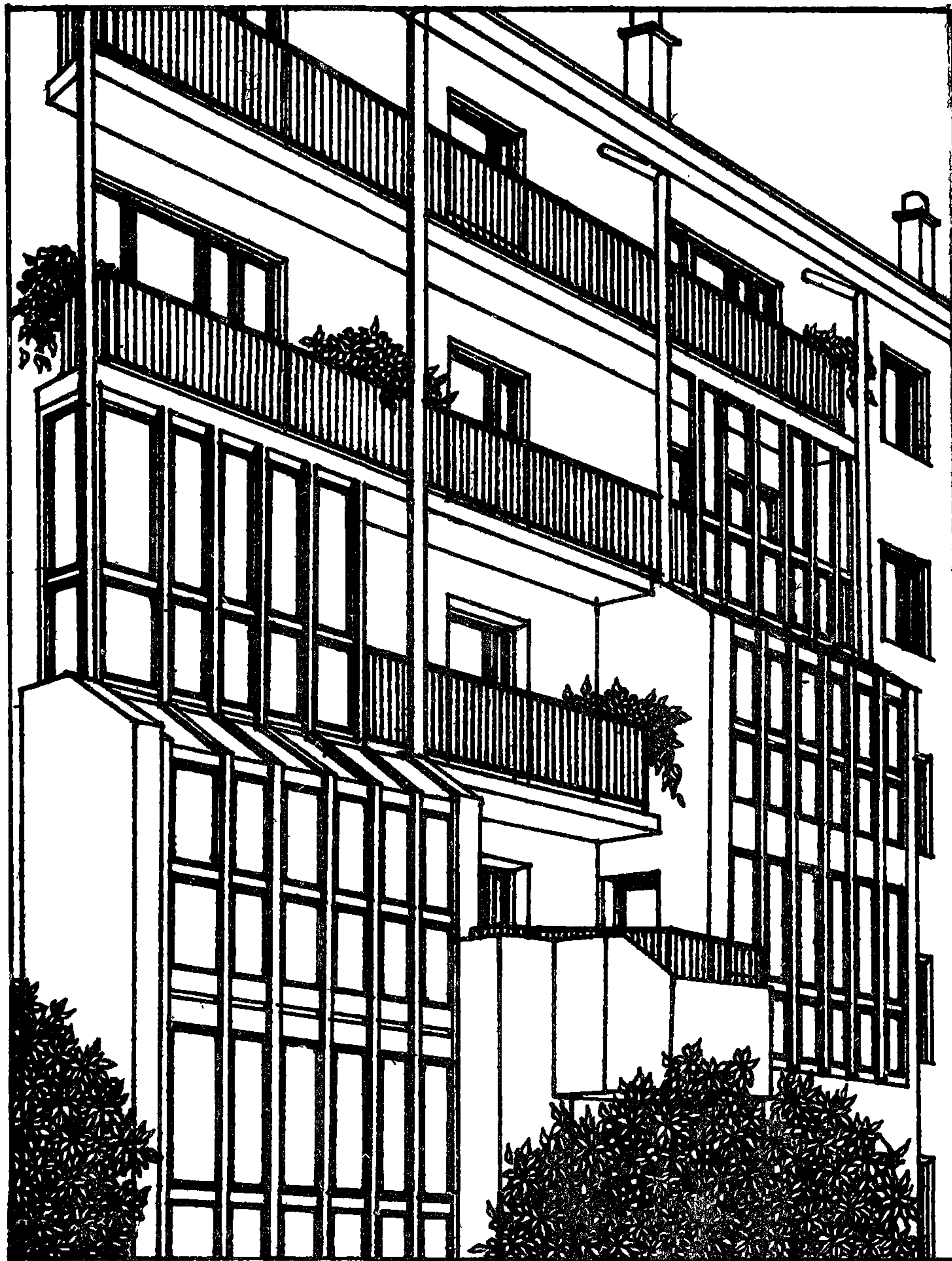
Рис.10. Модернизация фасада. Усложнение пластики фасада за счет сочетания балконов, лоджий и эркеров различной глубины
