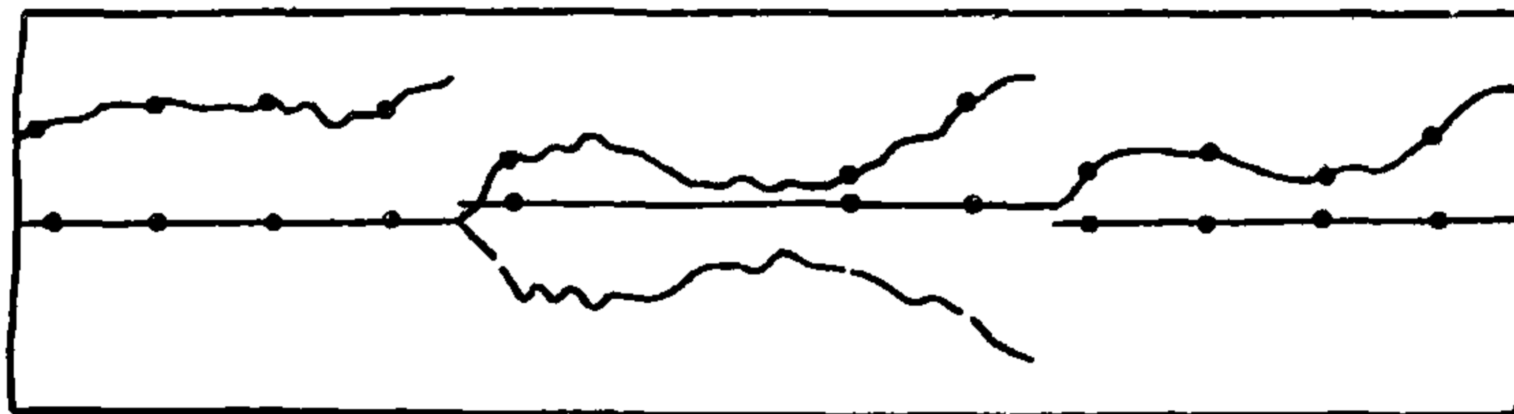
Рис. 11. Статорграмма с отказом одной из подсвечивающих ламп (использовать можно)
