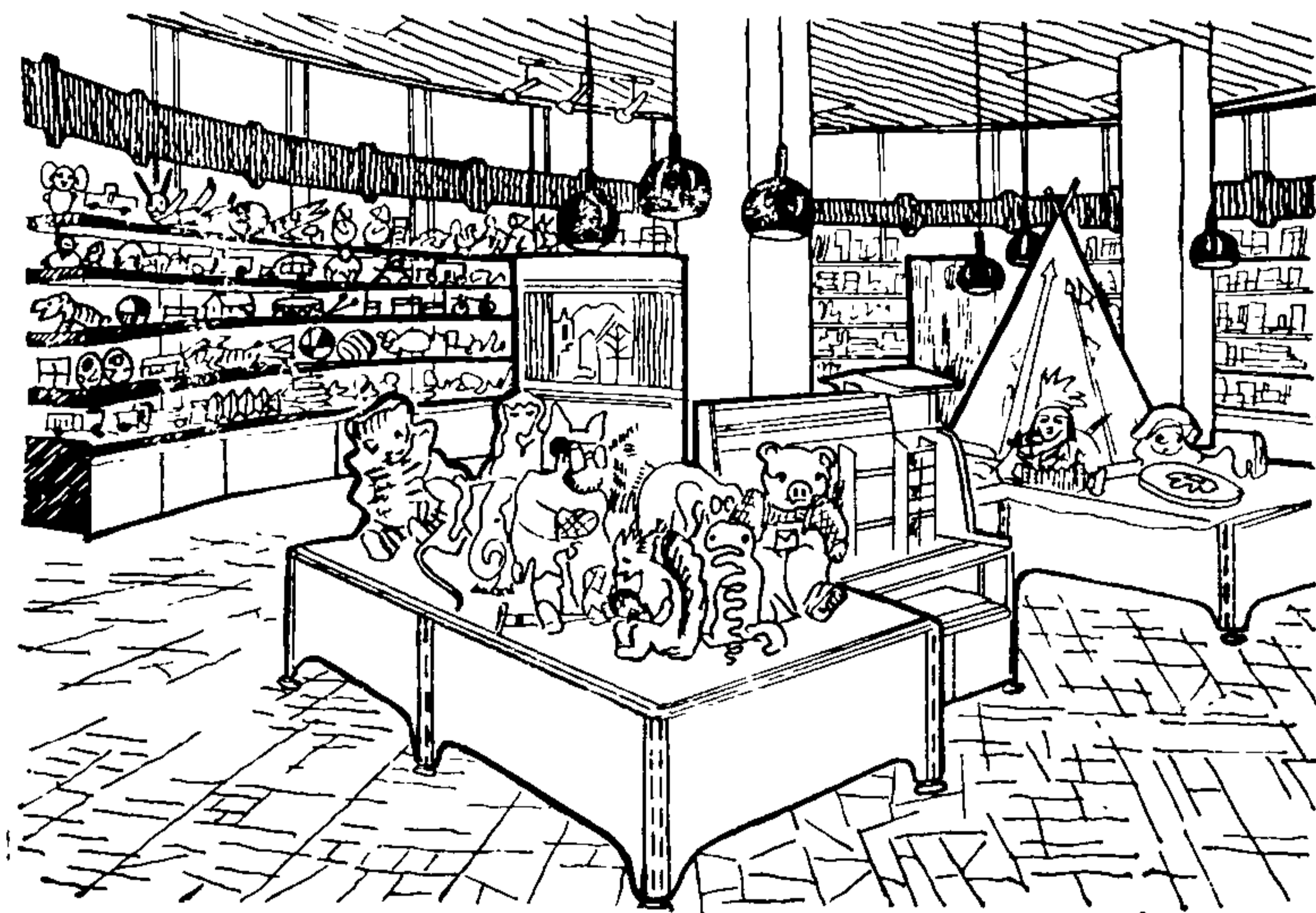
Рис. 35. Пример использования унифицированного оборудования для создания разнообразных группировок мебели в магазине «Игрушки»
