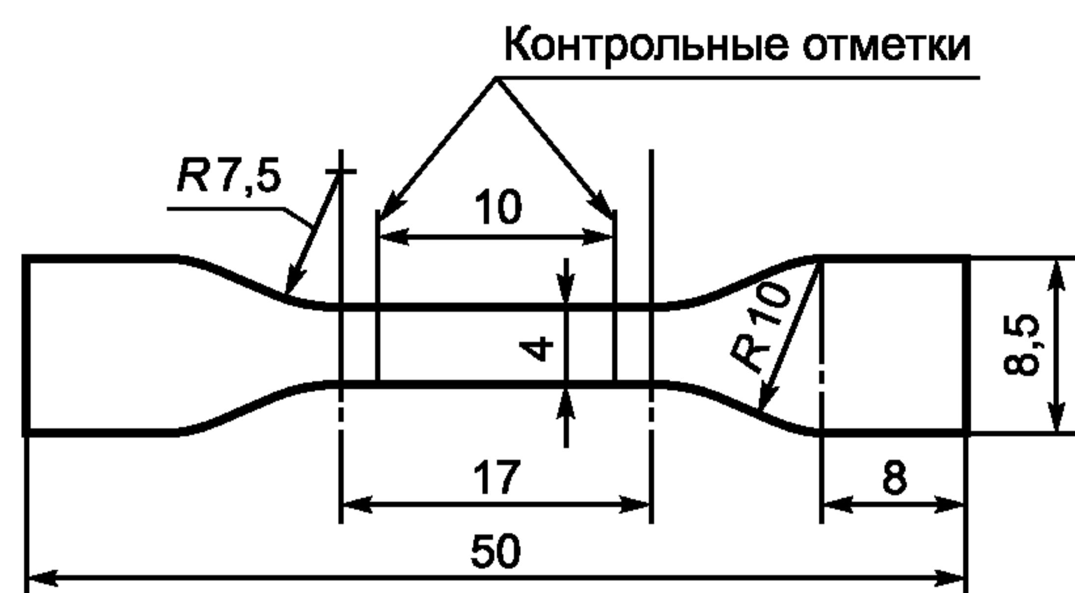
Рисунок 13 — Образец в виде лопатки уменьшенного размера
