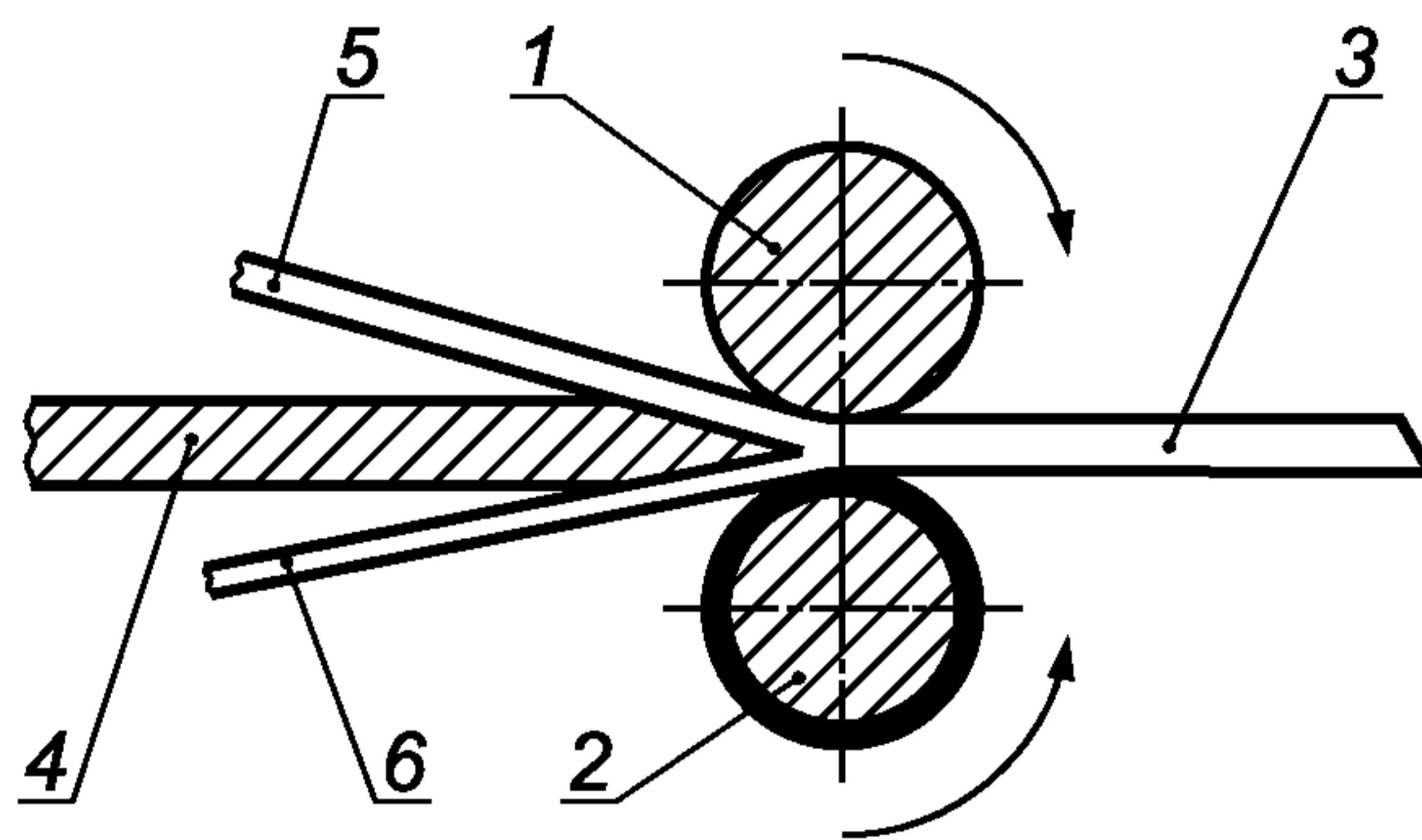
1 — ролик стальной, с проточками; 2 — ролик стальной обрезиненный. Ролики подают полоску 3 на острый стационарно закрепленный или способный перемещаться нож 4 (типа хирургического скальпеля). Полоску режут вдоль на две части: часть 5, из которой вырезают образцы, и часть 6, которая идет в отходы
