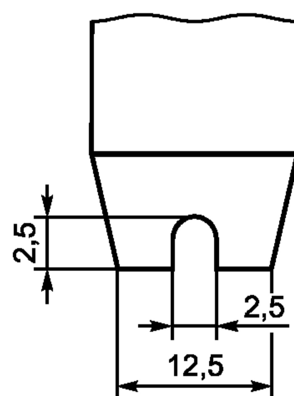
Рисунок 14 — Конец вырубного ножа с выемкой
