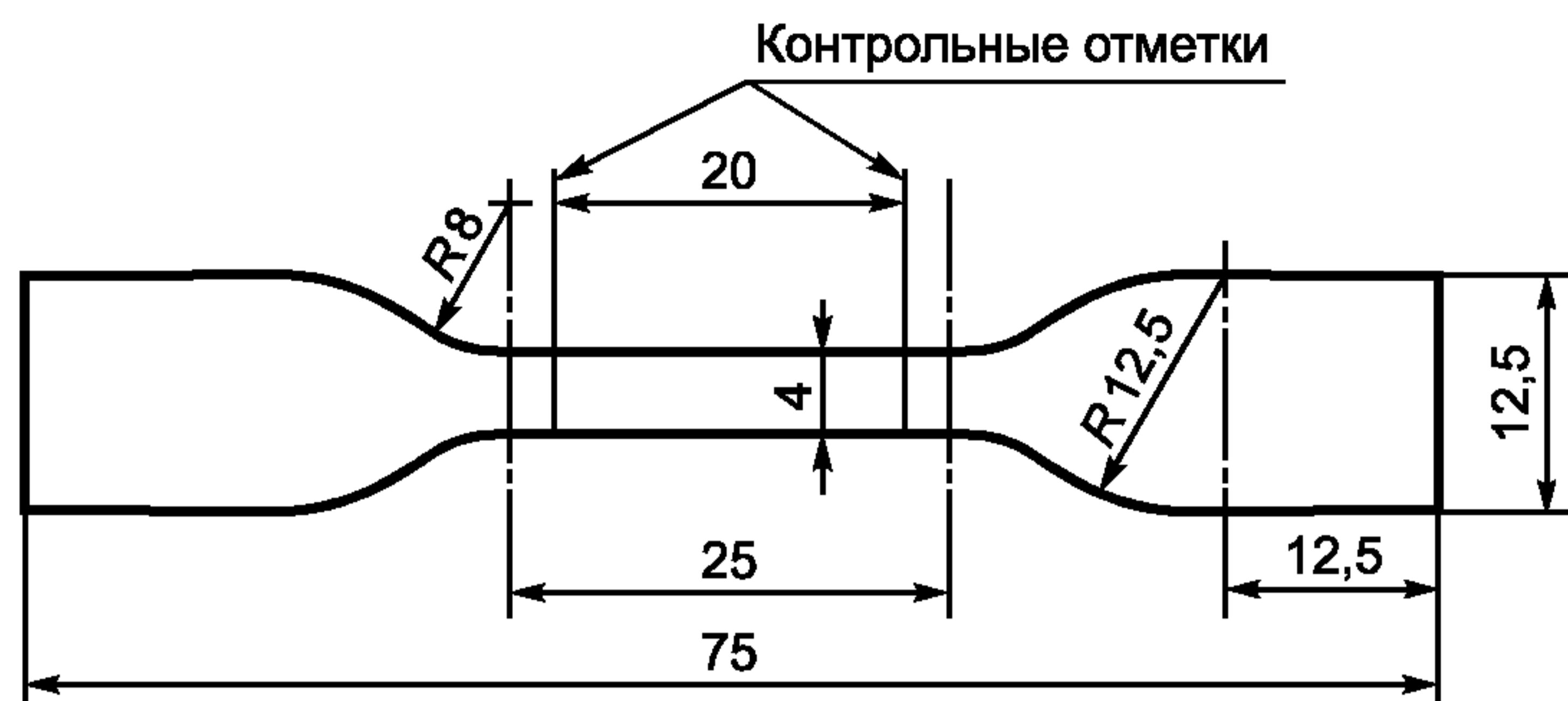
Рисунок 12 — Образец в виде двусторонней лопатки
