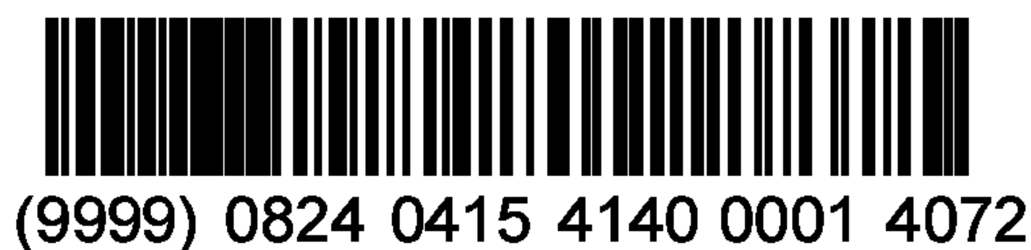
Рисунок 9 — Дополнительная резервная копия данных радиочастотной метки УВЧ Поколения 2 в виде символа штрихового кода GS1-128, включая код CRC-16 и восьмеричное представление для визуального чтения
