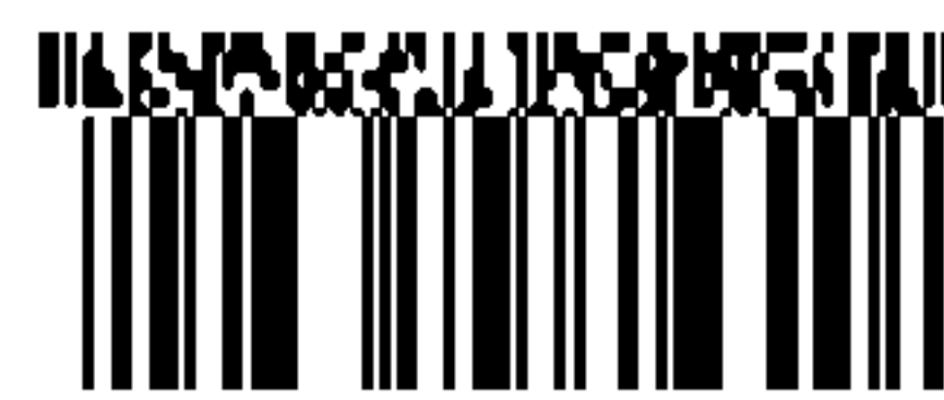
Рисунок G.5 — Композитный символ GS1 с линейным компонентом (слева) и символ GS1 DataBar (справа, пригодный для использования на кассовом терминале), содержащие структуру данных с идентификатором AI (01)
