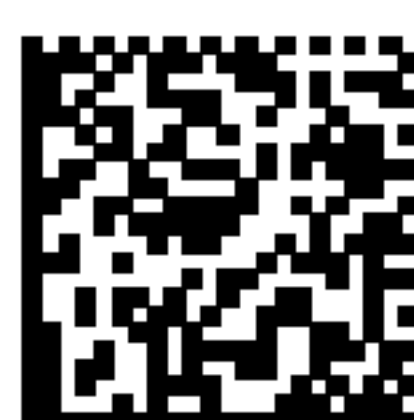
Рисунок 12 — Символ Data Matrix, содержащий полную резервную копию данных радиочастотной метки УВЧ Поколения 2
