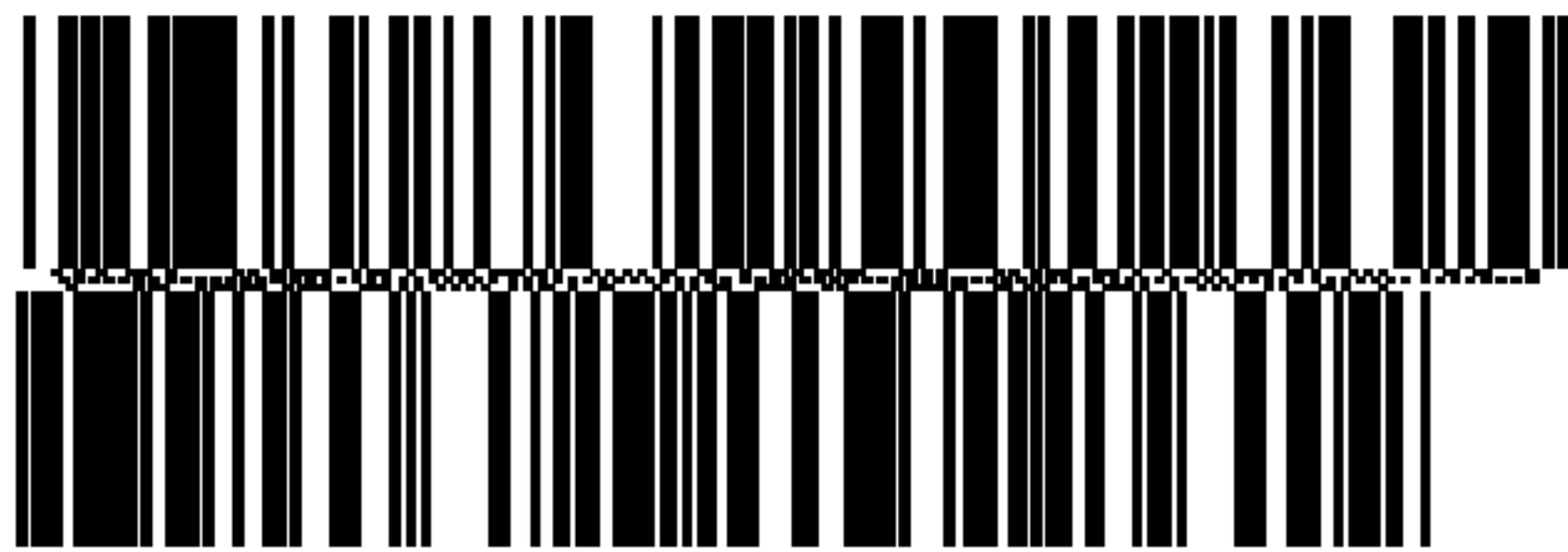
Рисунок G.1 — Символ GS1-128 с кодом CRC-16 и восьмеричным представлением для визуального чтения данных радиочастотной метки УВЧ Поколения 2
