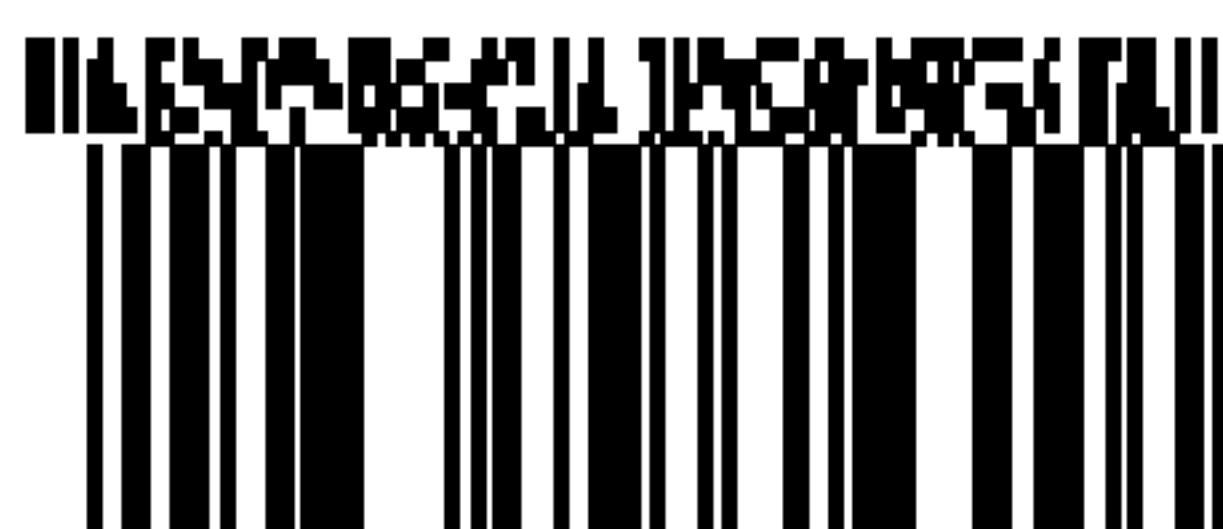
Рисунок 14 — Композитный символ с линейным компонентом GS1 Data Bar, содержащий структуру данных с идентификатором AI(01)
