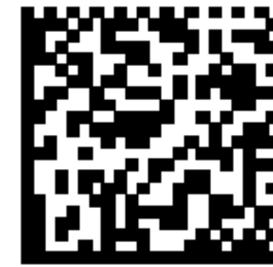
Рисунок G.3 — Символ Data Matrix с кодом CRC-16 и восьмеричным представлением для визуального чтения данных радиочастотной метки УВЧ Поколения 2
