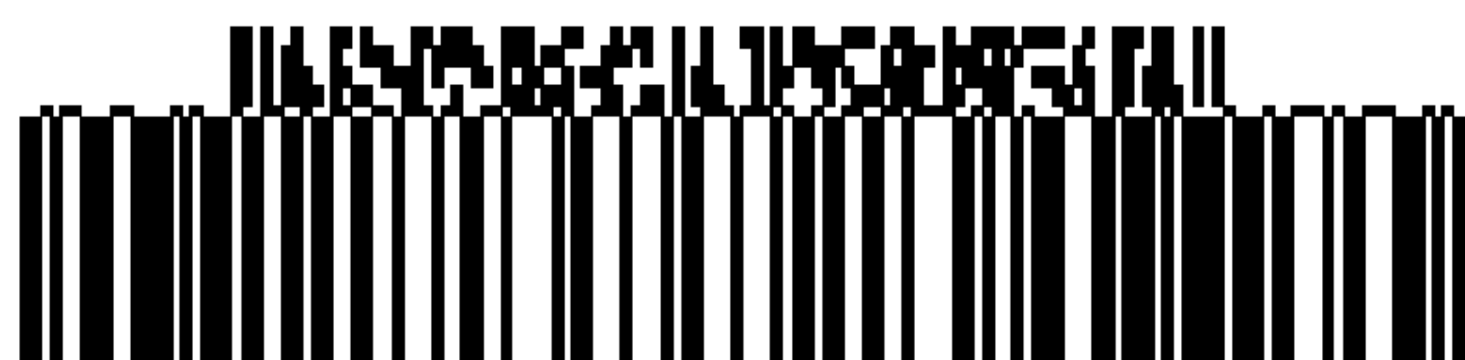
Рисунок 13 — Композитный символ с линейным компонентом GS1-128, содержащий структуру данных с идентификатором AI(01)
