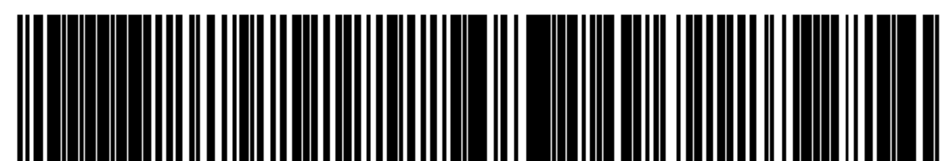
Рисунок 8 — Полная резервная копия данных радиочастотной метки УВЧ Поколения 2 в виде символа штрихового кода GS1-128 с восьмеричным представлением для визуального чтения
