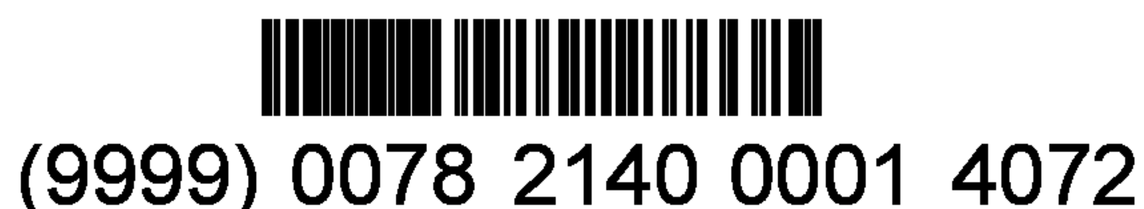
Рисунок 10 — Пример символа штрихового кода GS1-128, содержащего дополнительную резервную копию данных радиочастотной метки УВЧ Поколения 2 без кода CRC-16
