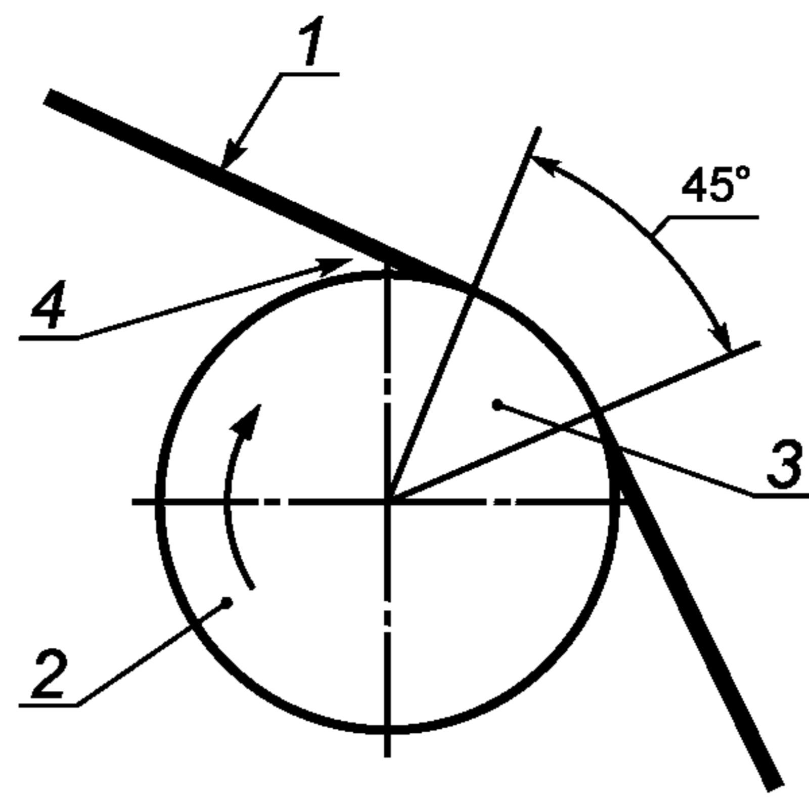
1 — лента материала с покрытием; 2 — направляющий валик; 3 — угол обхвата;
