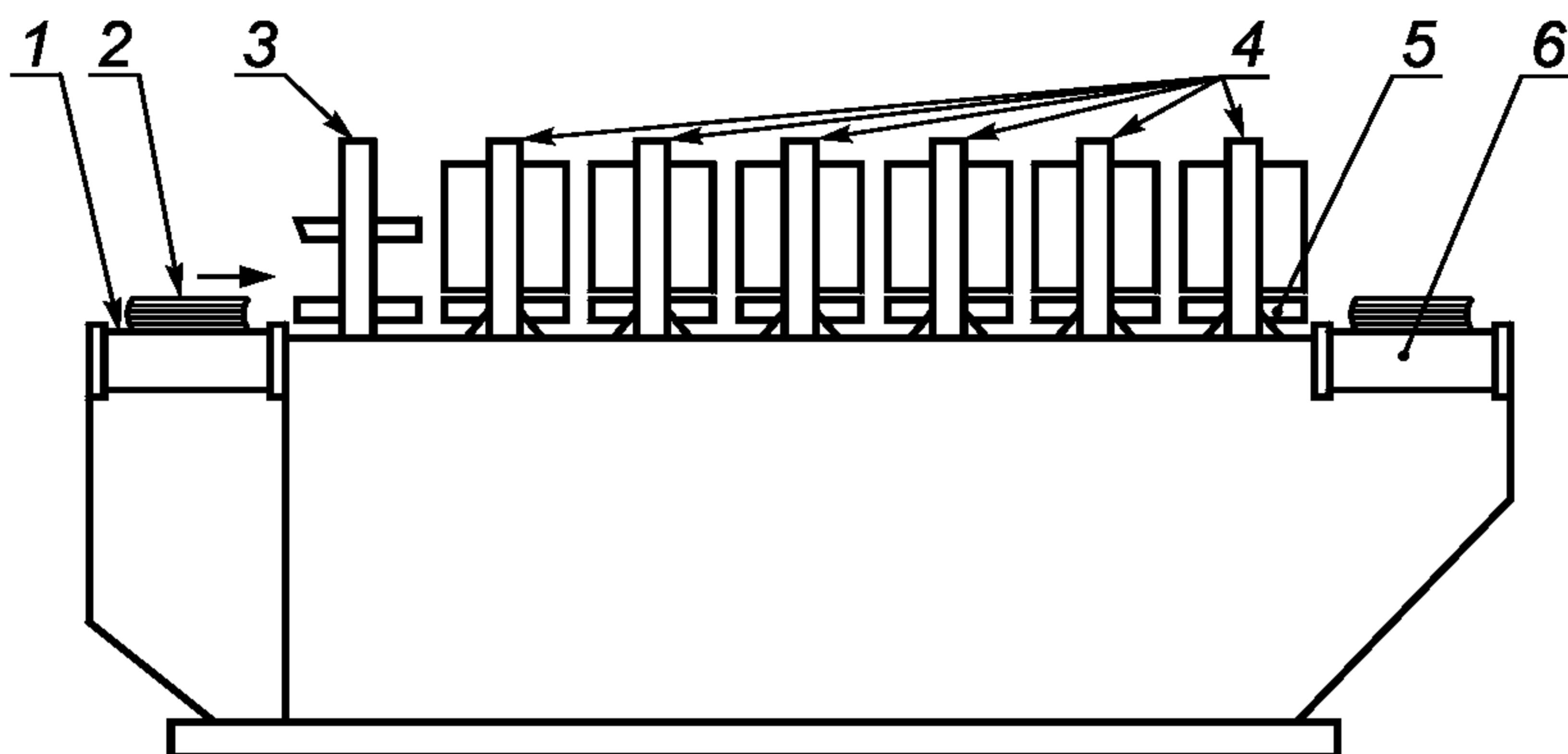
1 — подающий транспортер; 2 — книжный блок; 3 — секция укладки и выравнивания;
