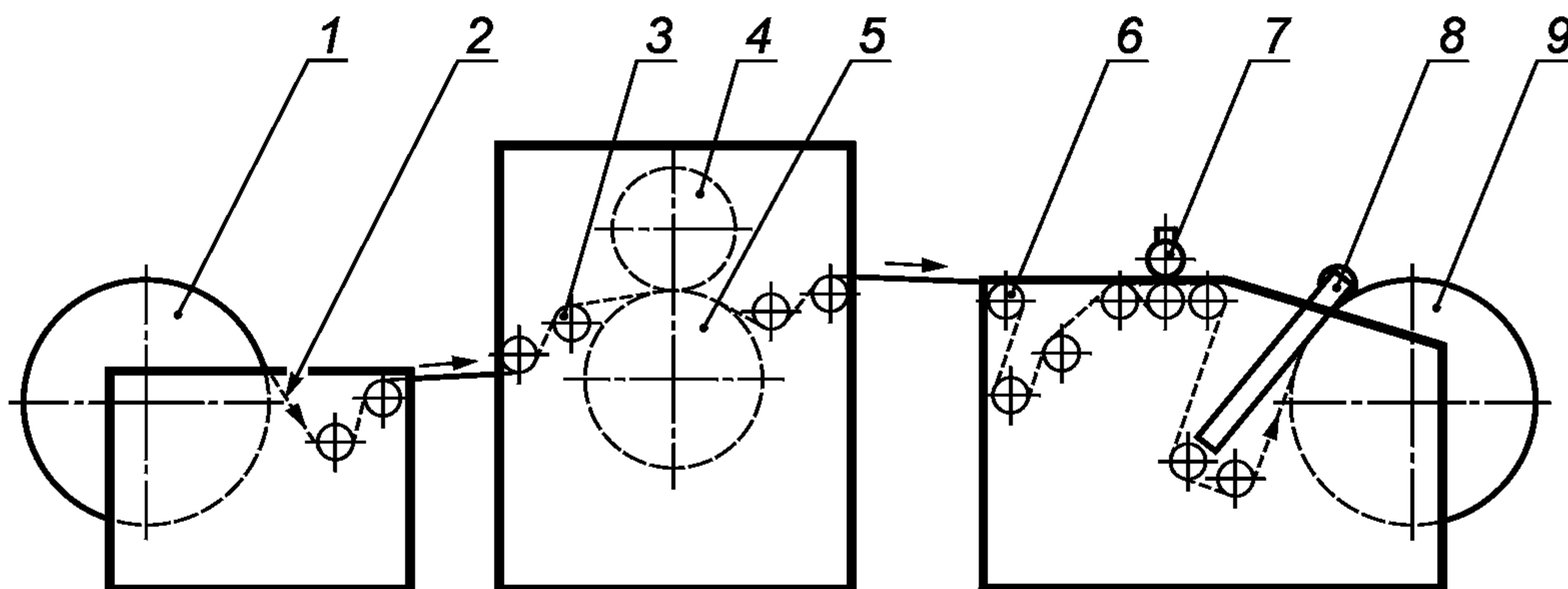
1 — устройство размотки рулона; 2 — бумажная лента; 3 — валик для регулирования натяжения; 4 — тисильный вал; 5 — опорный вал; 6 — направляющие валики; 7 — узел резки; 8 — приводной тянувший валик; 9 — устройство намотки рулона
