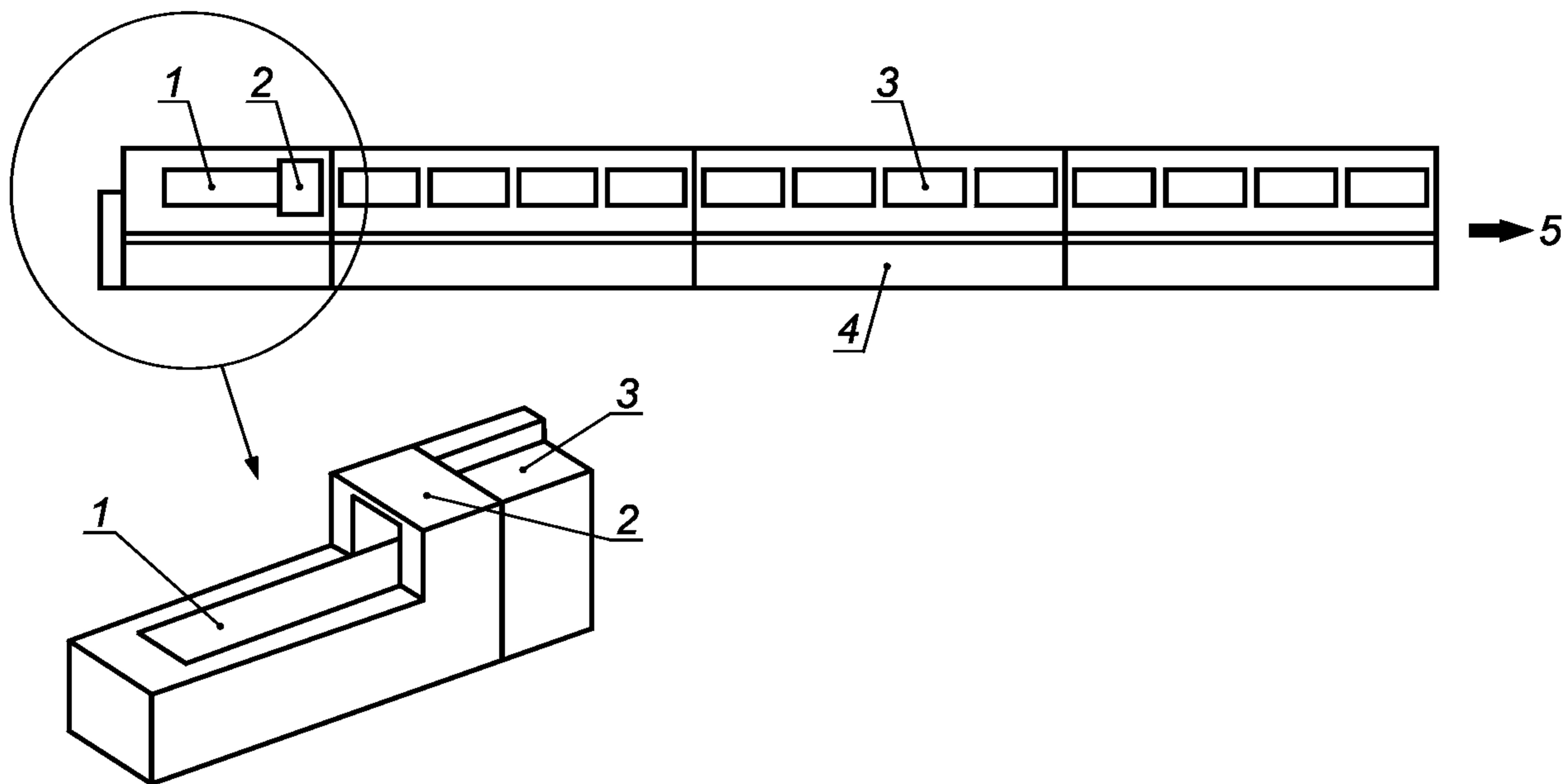
1 — ручная подача; 2 — ограждение тоннельного типа; 3 — самонаклад; 4 — подборочное устройство (транспортер);
