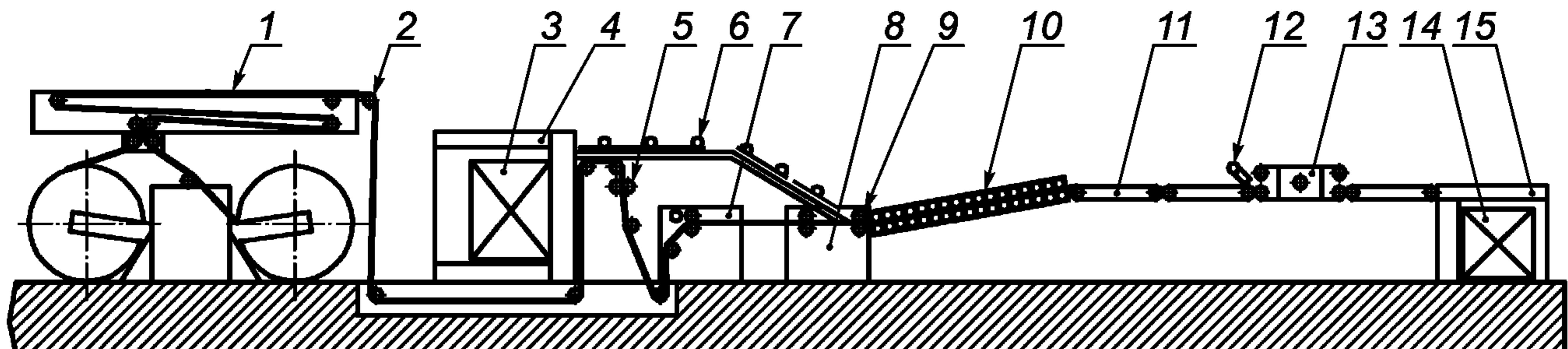
1 — устройство для размотки рулона; 2 — направляющий валик; 3 — стапель; 4 — самонаклад; 5 — дисковые ножи; 6 — листопередающие валики; 7 — kleевая секция; 8 — листорезальное устройство; 9 — ламирующие валы; 10 — обжимной ленточный транспортер; 11 — ленточный транспортер; 12 — упор для формирования пачек; 13 — поворотный транспортер; 14 — стапель; 15 — приемное устройство
