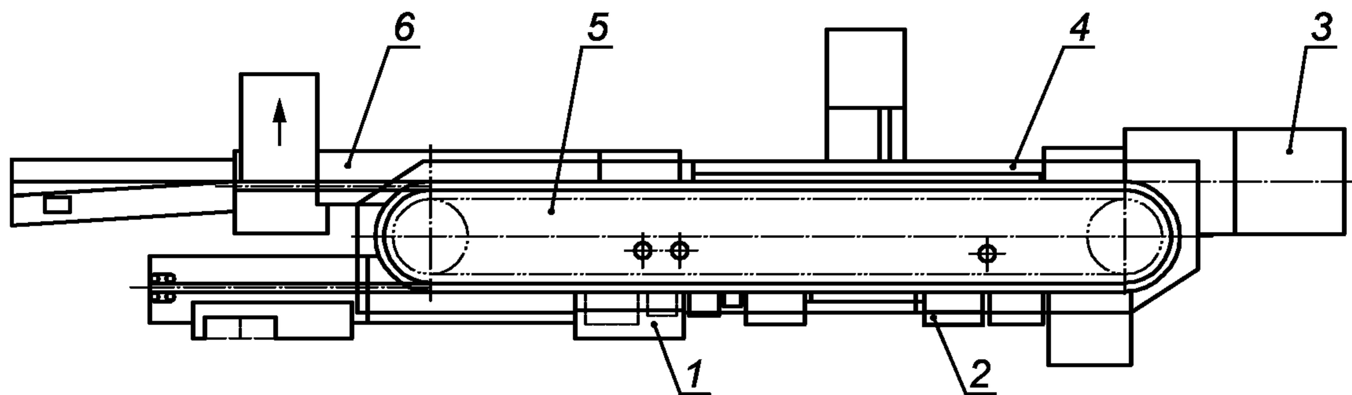
1 — секция фрезерования; 2 — kleевая секция; 3 — самонаклад обложек; 4 — обжимная секция; 5 — зажимы книжного блока; 6 — приемно-выводное устройство
