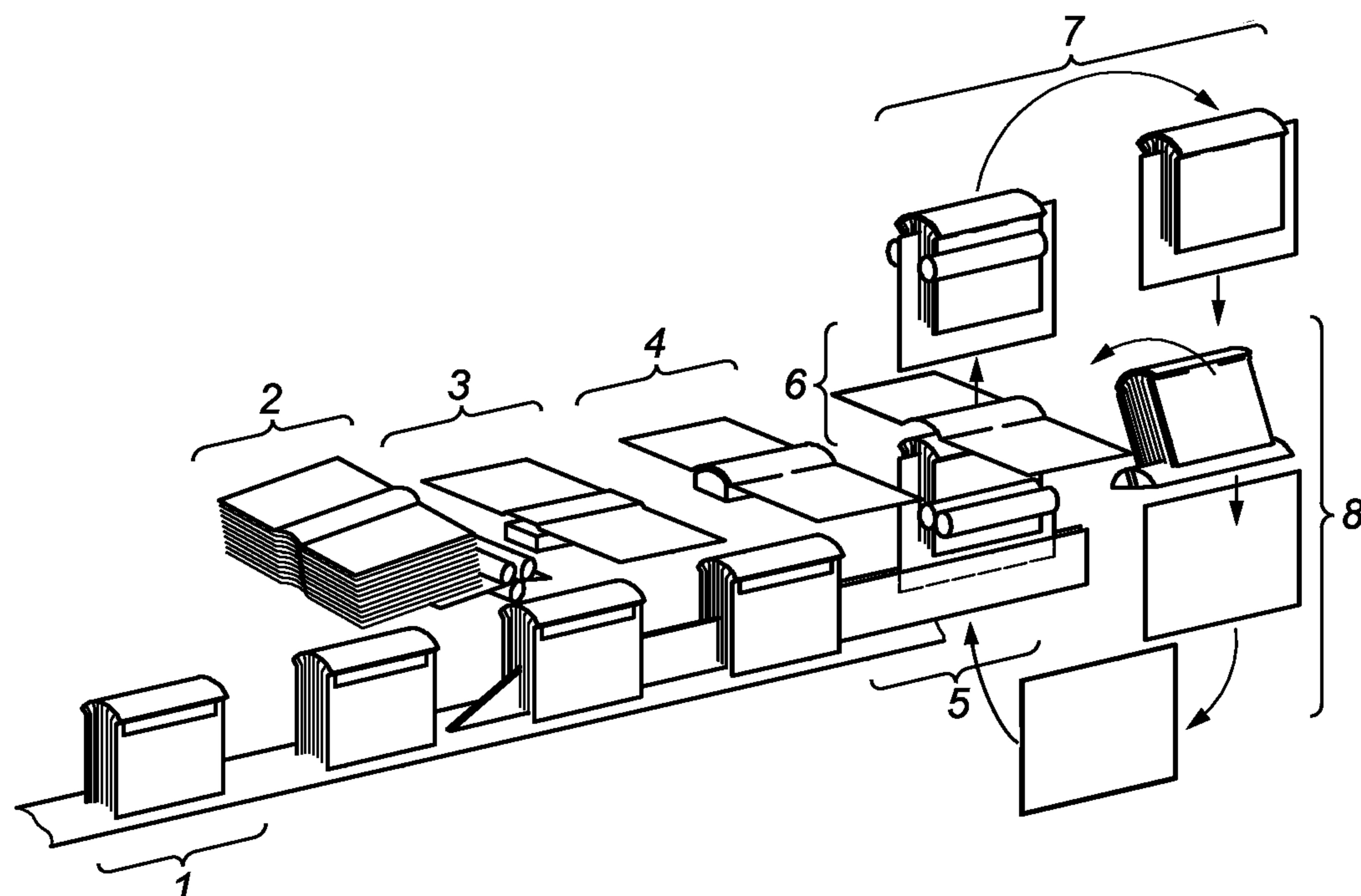
1 — ввод блоков; 2 — самонаклад переплетных крышек (и каландрирование); 3 — секция биговки переплетных крышек; 4 — секция кругления корешка переплетных крышек; 5 — секция промазки kleем; 6 — секция вставки блока в переплетную крышку; 7 — секция обжимки (обкатки); 8 — вывод
