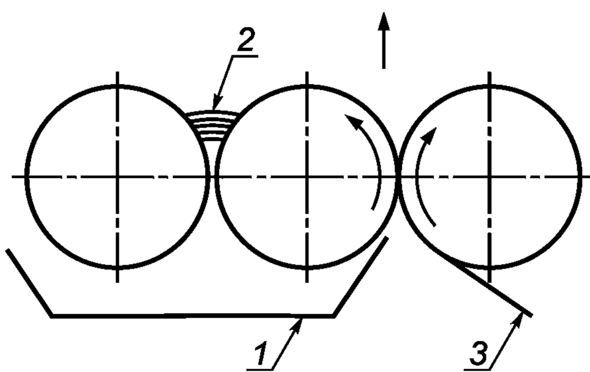
1 — сборное корыто; 2 — дозирующий зазор; 3 — лента материала
