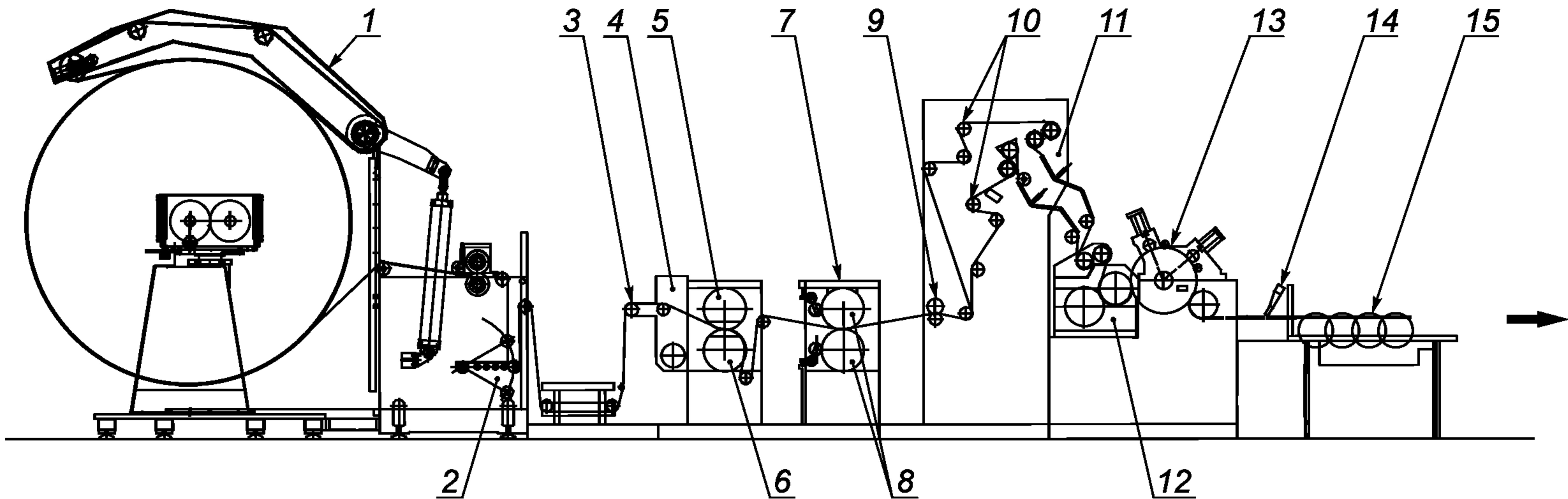
1 — установка для размотки рулона; 2 — плавающий валик; 3 — валик регулирования натяжения; 4 — секция каландрирования; 5 — верхний каландрирующий вал; 6 — нижний каландрирующий вал; 7 — секция тиснения; 8 — валы для тиснения; 9 — секция продольной разрезки; 10 — устройство для приводки; 11 — секция продольной сгибы; 12 — цилиндр поперечной резки; 13 — цилиндр поперечной сгибы; 14 — устройство для отсоса отходов; 15 — счетная и передающая секция
