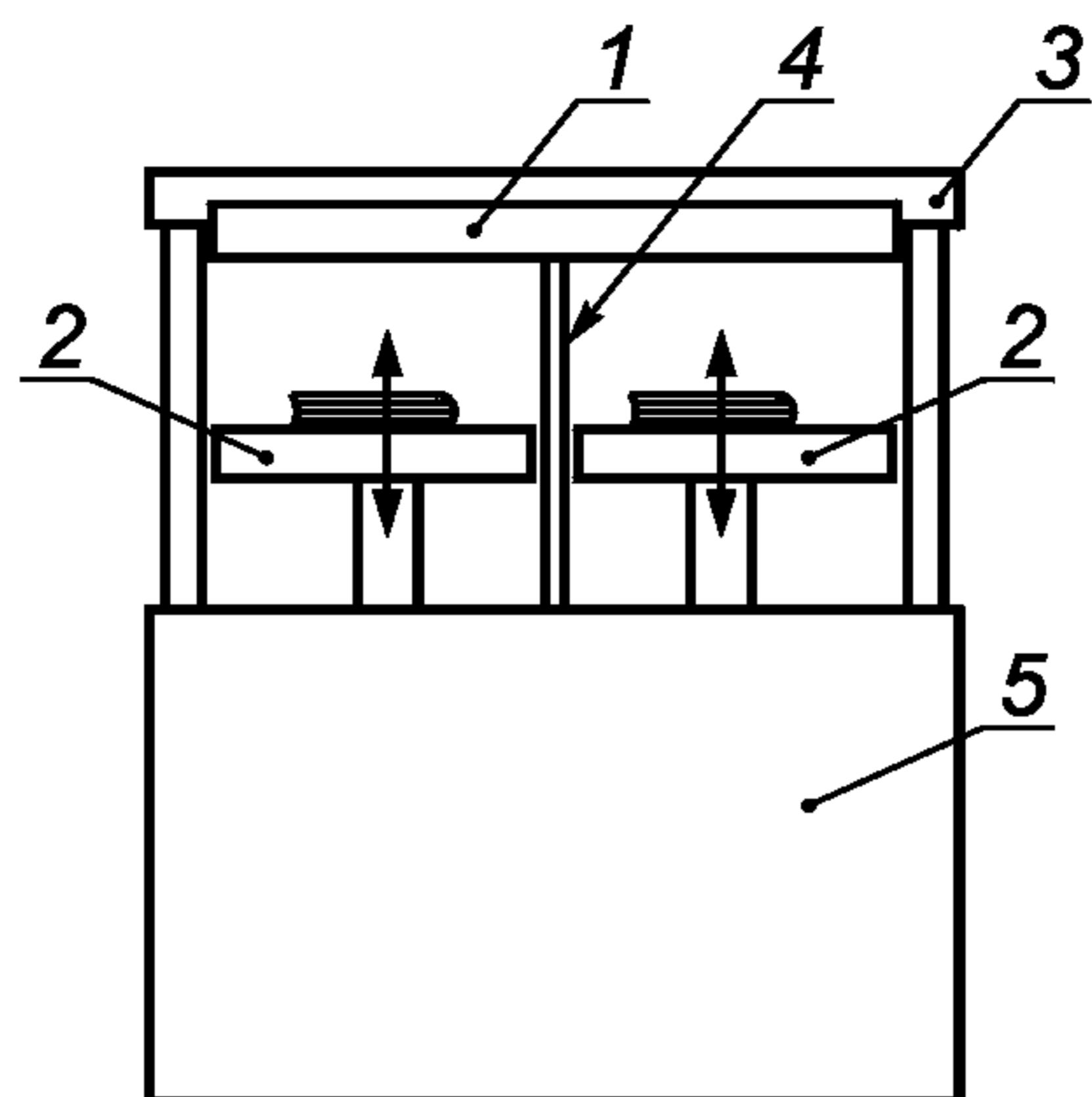
1 — планка автоматического отключения; 2 — подвижная прессующая плита; 3 — неподвижная прессующая плита;
