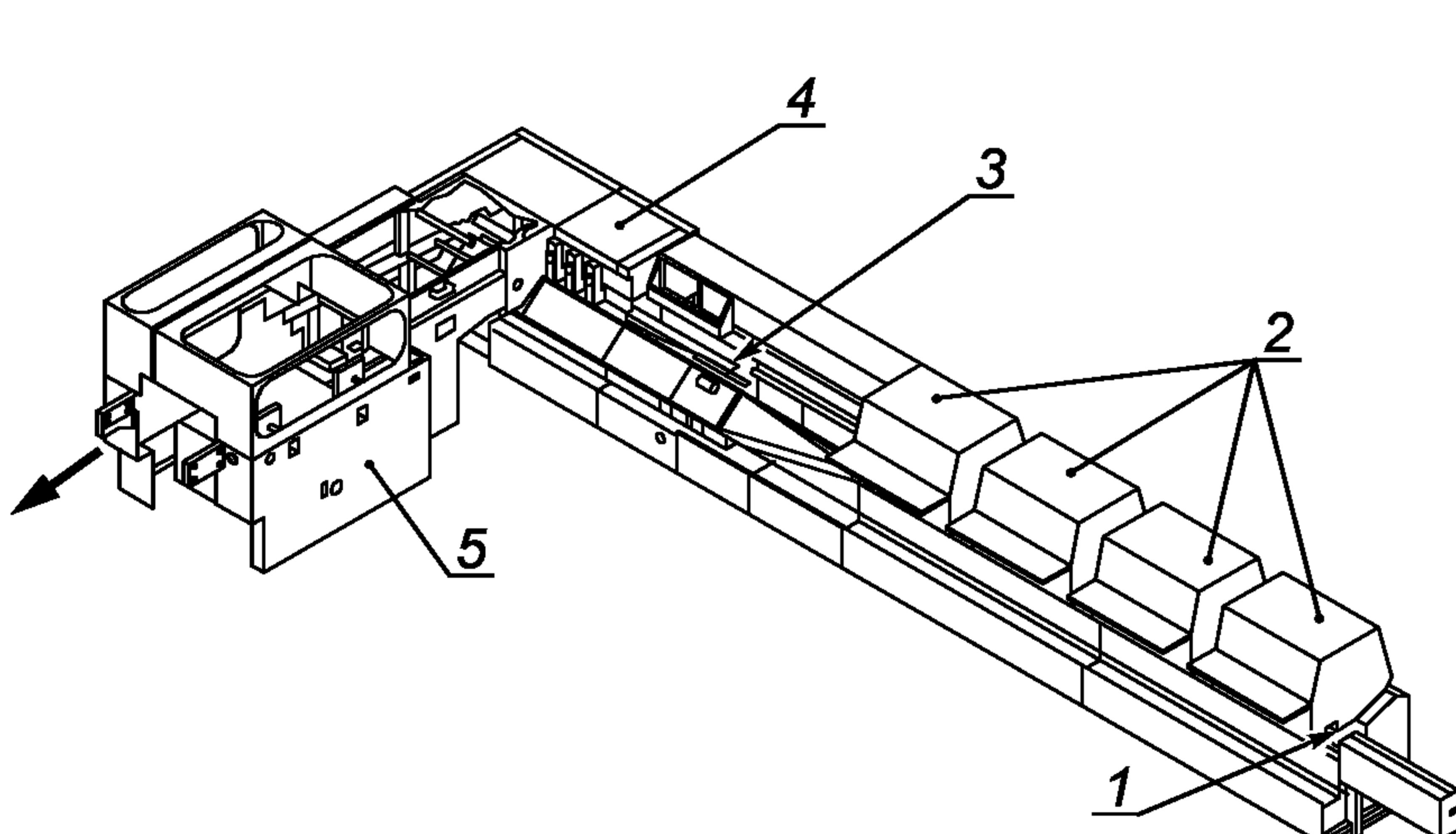
1 — цепной транспортер; 2 — самонаклады; 3 — контроль толщины; 4 — швейная секция; 5 — обрезка с трех сторон (трехножевая)
