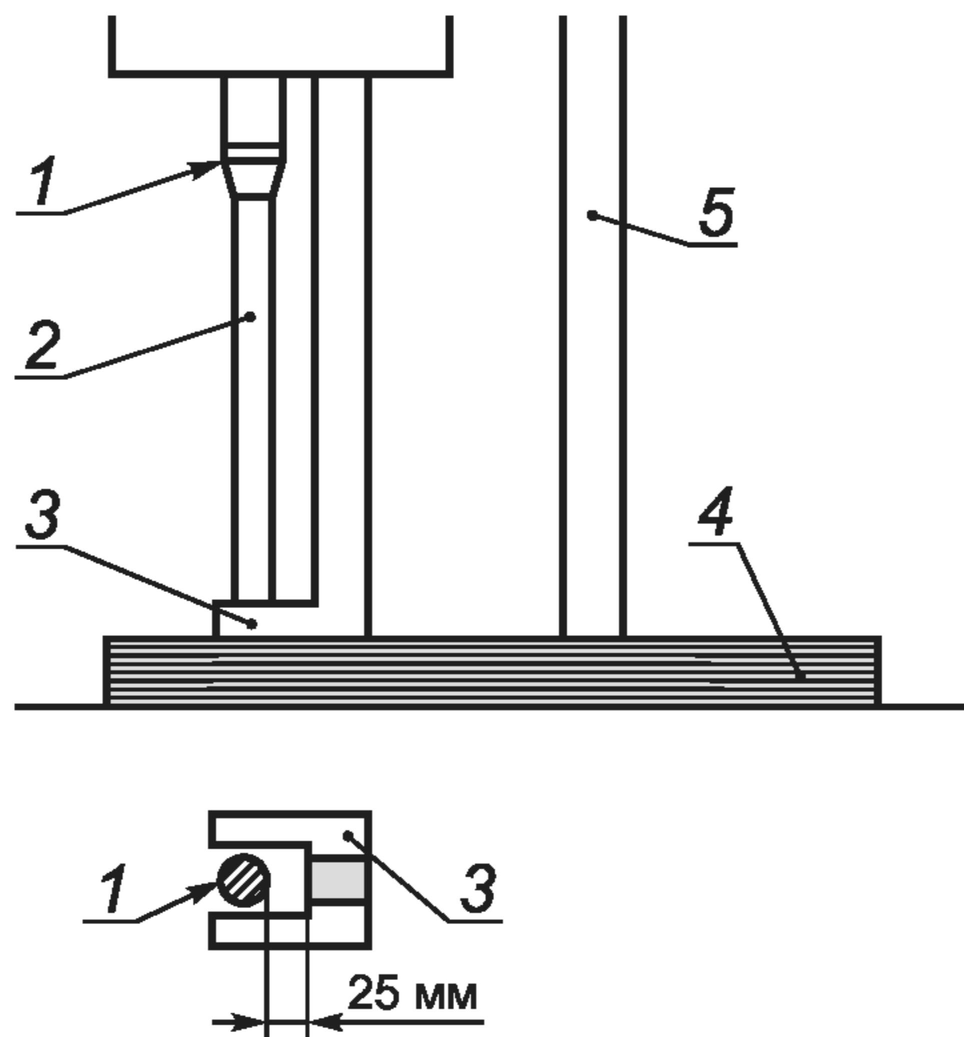
1 — кулачок зажимного патрона; 2 — сверло; 3 — прижимное устройство;
