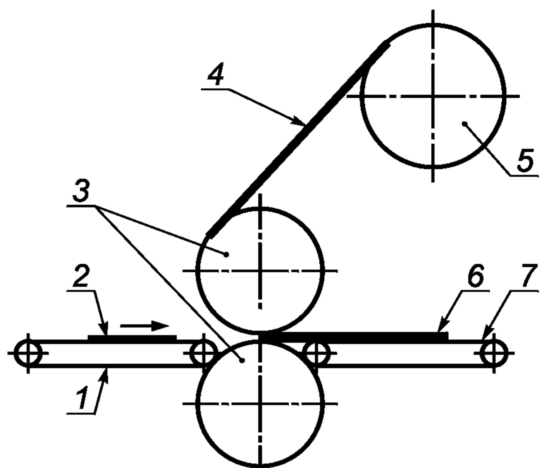
1 — подающий транспортер; 2 — обрабатываемое изделие (отдельный лист); 3 — ламинирующие валы; 4 — лента пленки; 5 — узел размотки; 6 — ламинированные отдельные листы; 7 — приемный транспортер
