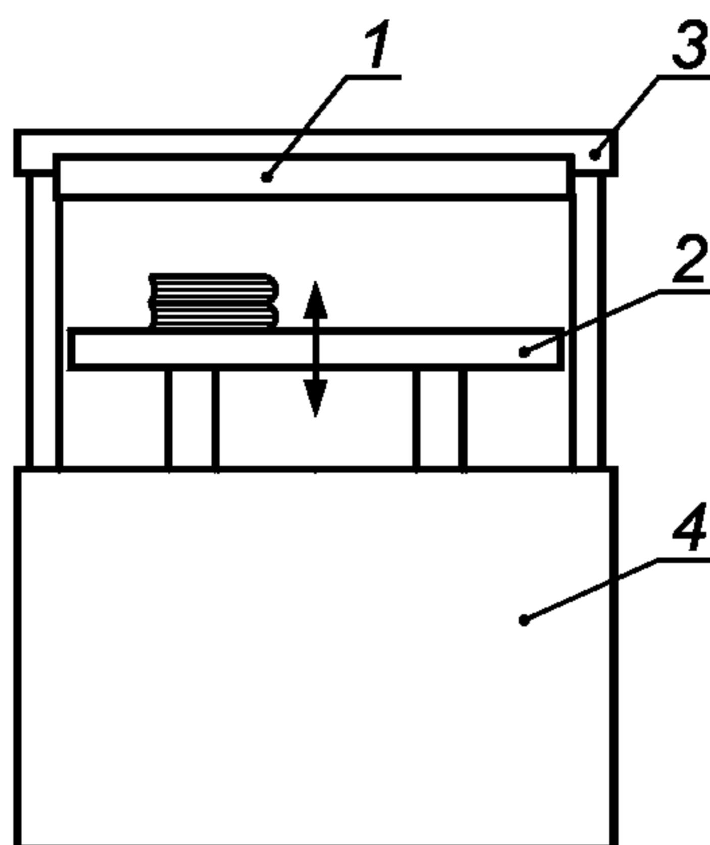
1 — планка автоматического отключения; 2 — подвижная прессующая плита; 3 — неподвижная прессующая плита;
