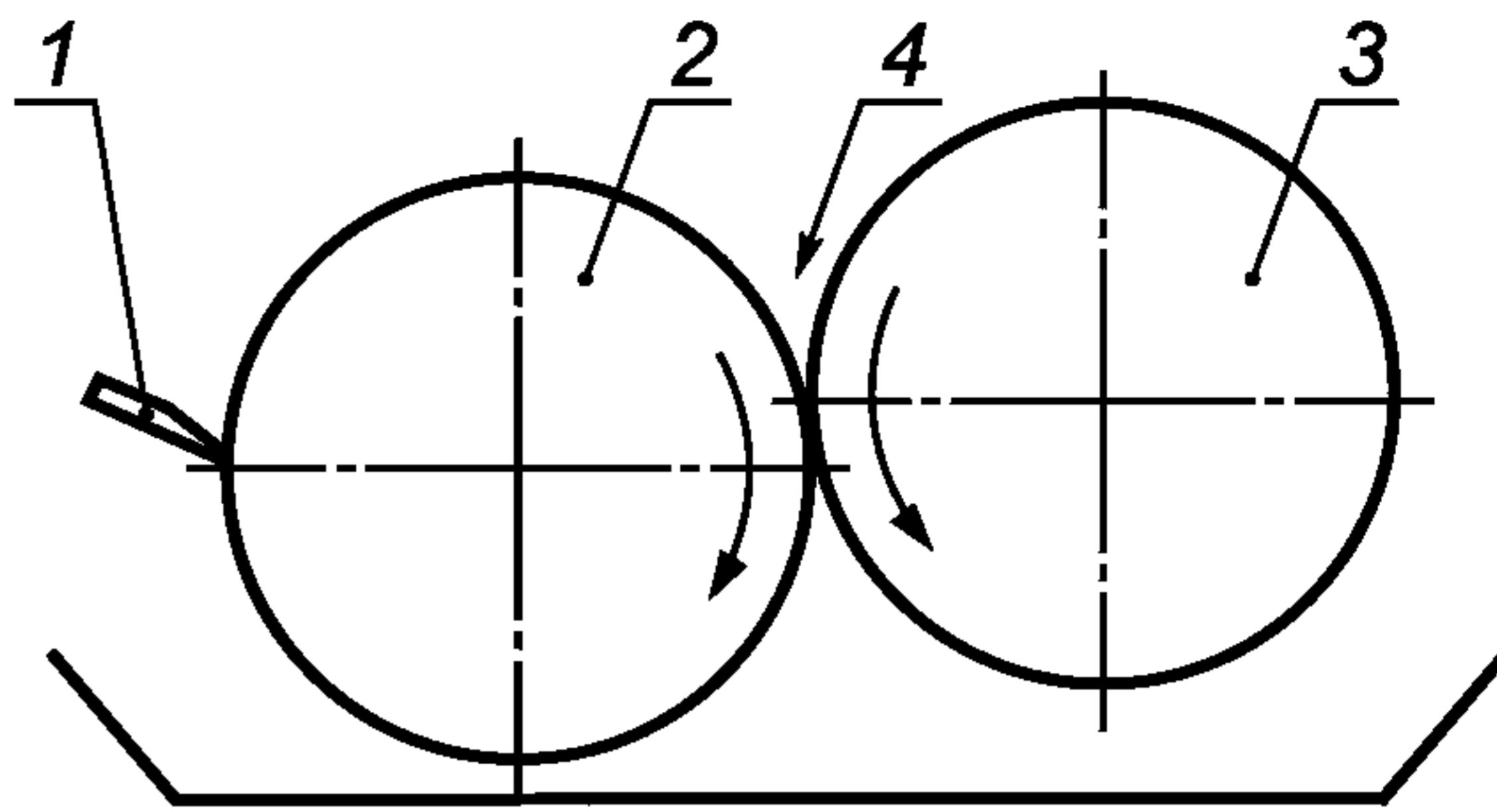
1 — ракель; 2 — дукторный валик; 3 — наносящий валик; 4 — зона затягивания
