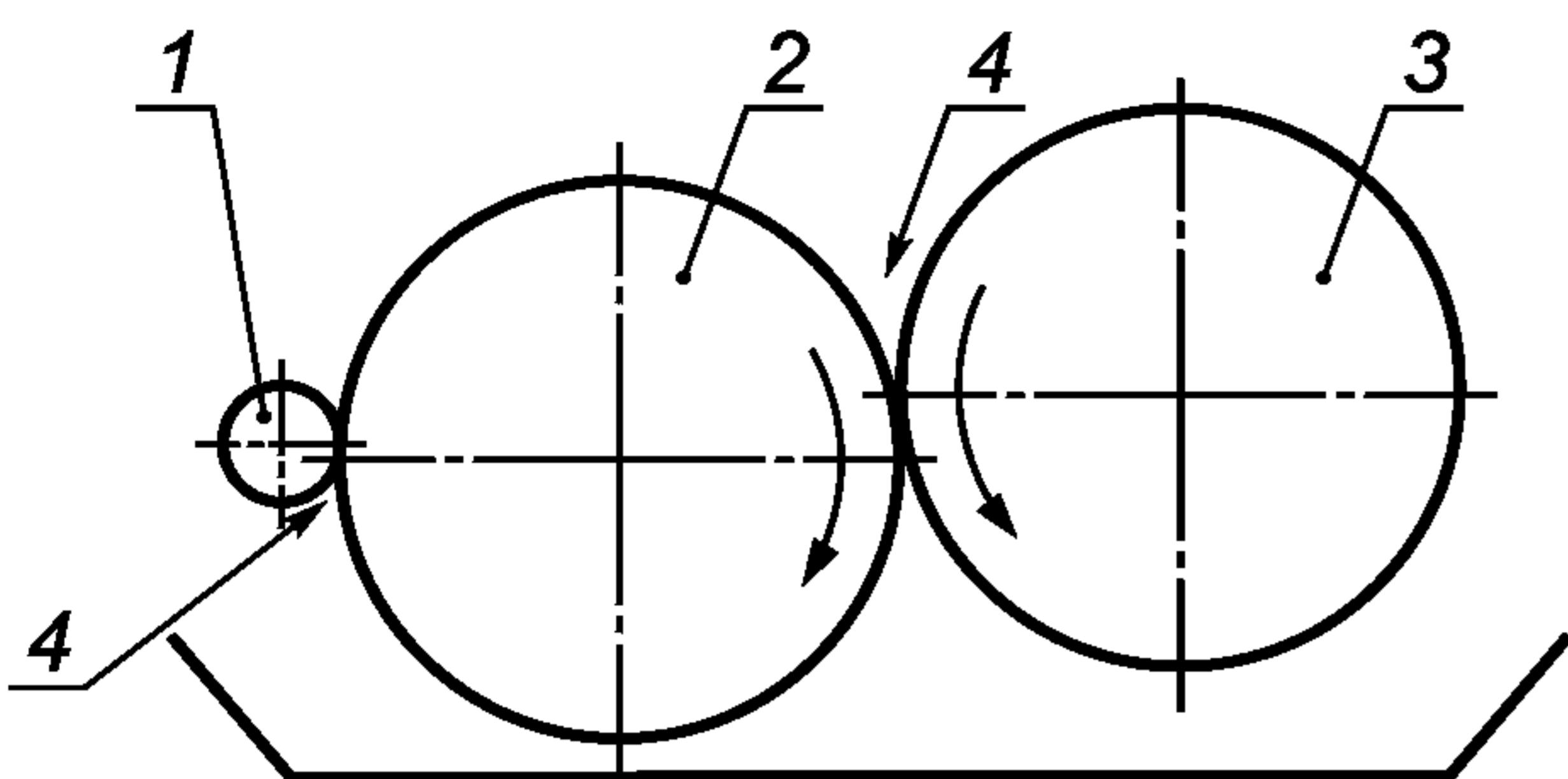
1 — дозирующий валик; 2 — дукторный валик; 3 — kleenanoсящий валик; 4 — зона затягивания
