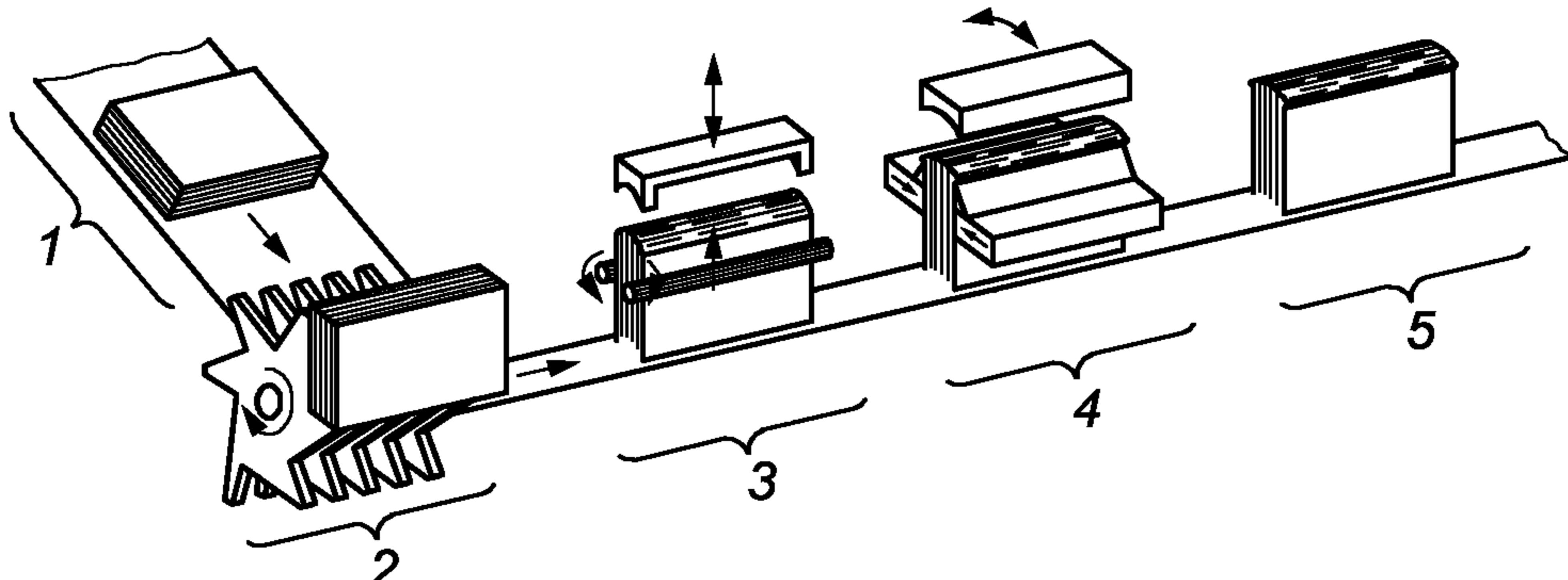
1 — ввод блока; 2 — переворачивание блока; 3 — секция предварительного кругления; 4 — секция окончательного кругления и обжимки корешка; 5 — вывод
