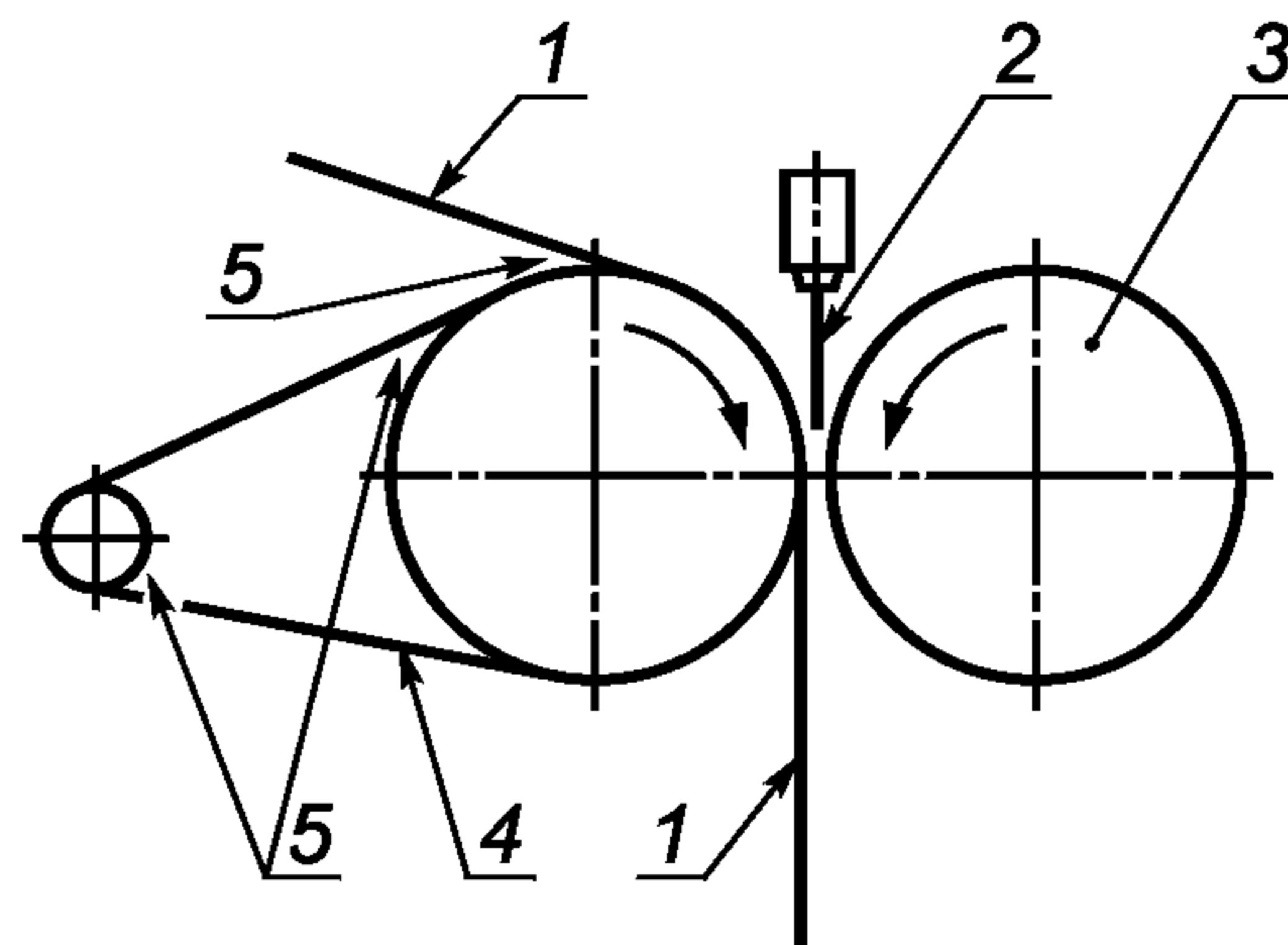
1 — лента материала; 2 — полиэтилен; 3 — охлаждающий вал;
