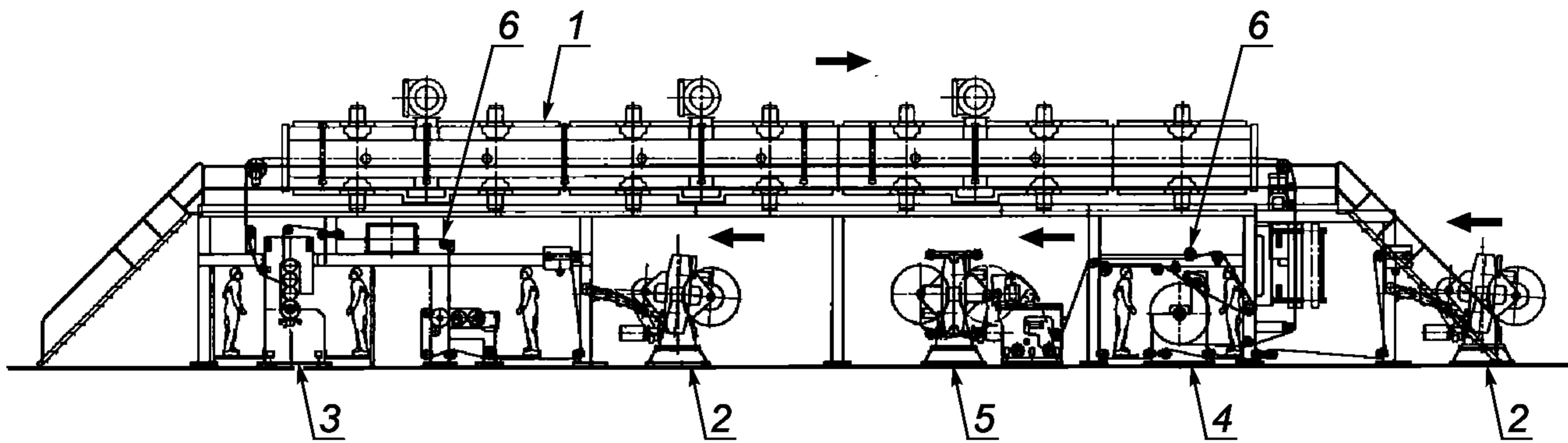
1 — сушильное устройство; 2 — установка для размотки рулона; 3 — секция нанесения покрытия; 4 — секция ламирования; 5 — установка для намотки рулона; 6 — направляющие валики
