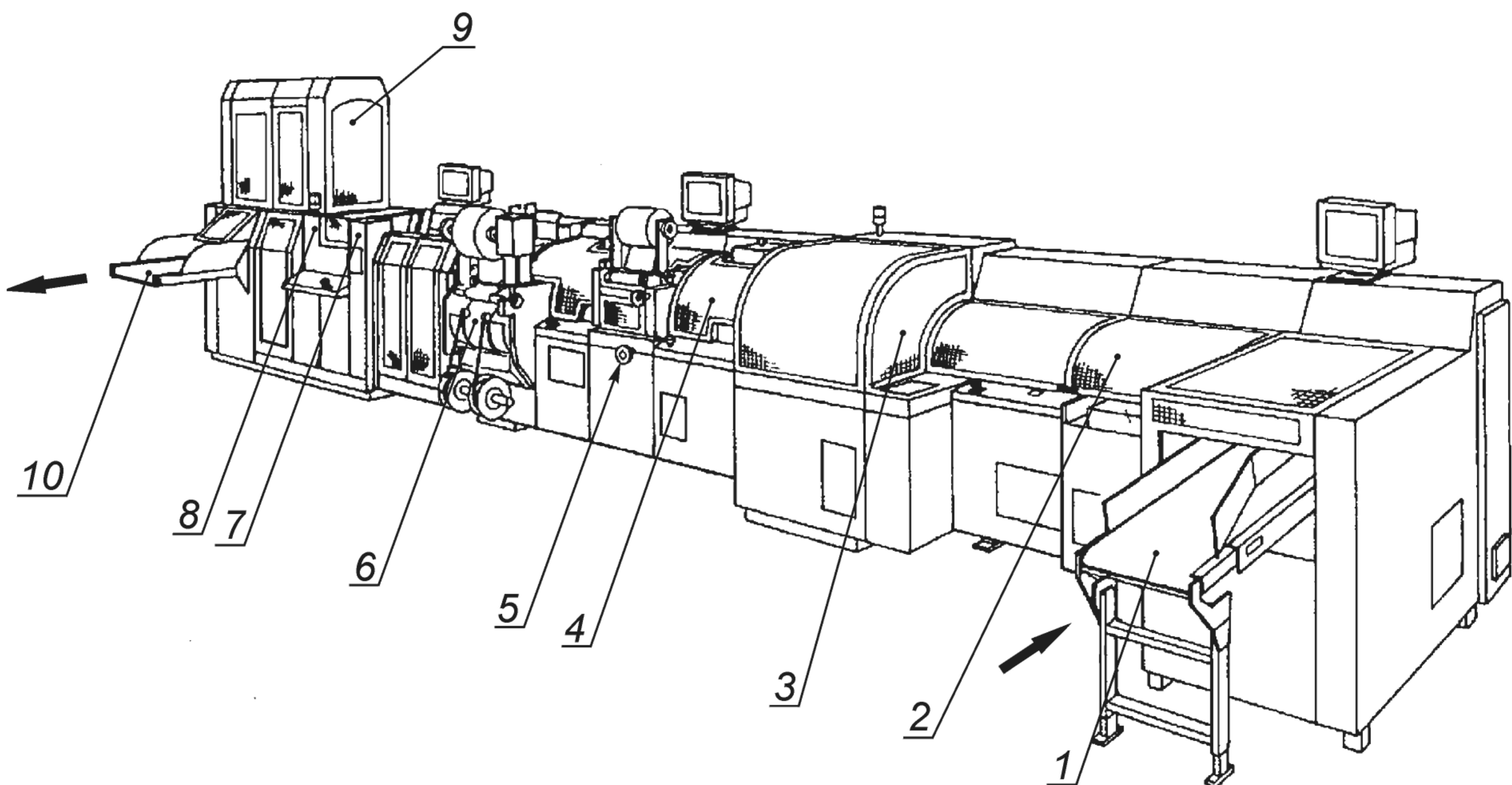
1 — загрузочный транспортер; 2 — нагреватель; 3 — секция кругления и обжимки; 4 — клеевая секция; 5 — марлевая секция; 6 — оклеочно-каптальная секция; 7 — магазин переплетных крышек; 8 — секция биговки, кругления переплетной крышки; 9 — секция вставки блока в переплетную крышку; 10 — выводной транспортер
