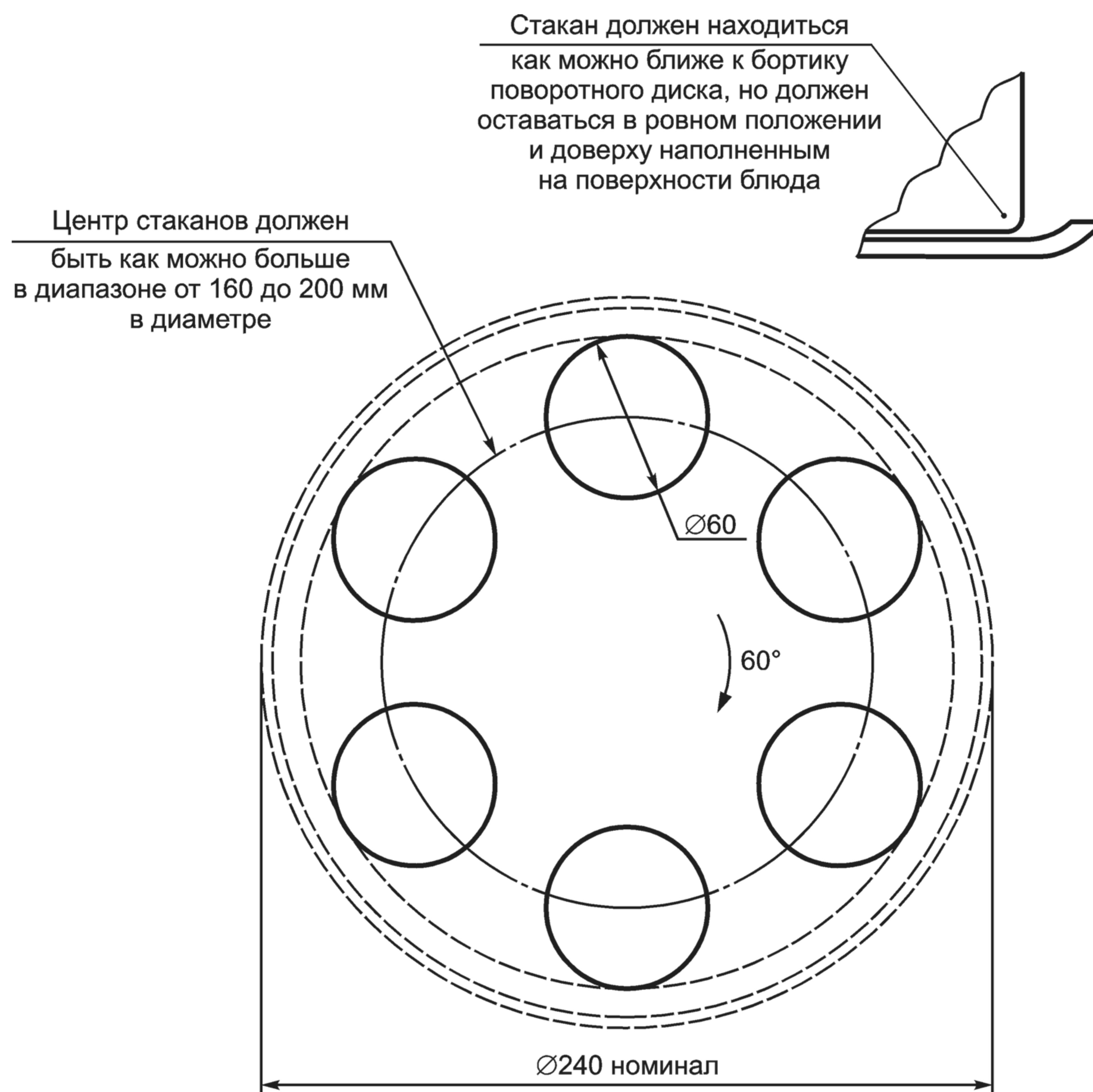
Рисунок 1 — Расположение стаканов на поворотном диске микроволновой печи
