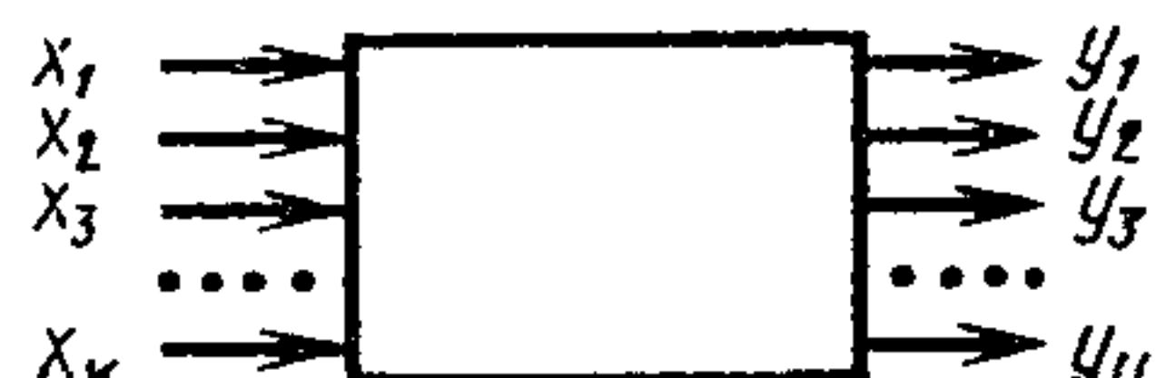
$k$  — число скалярных составляющих вектора входа  $x$ ;  $u$  — число скалярных составляющих вектора выхода  $y$
