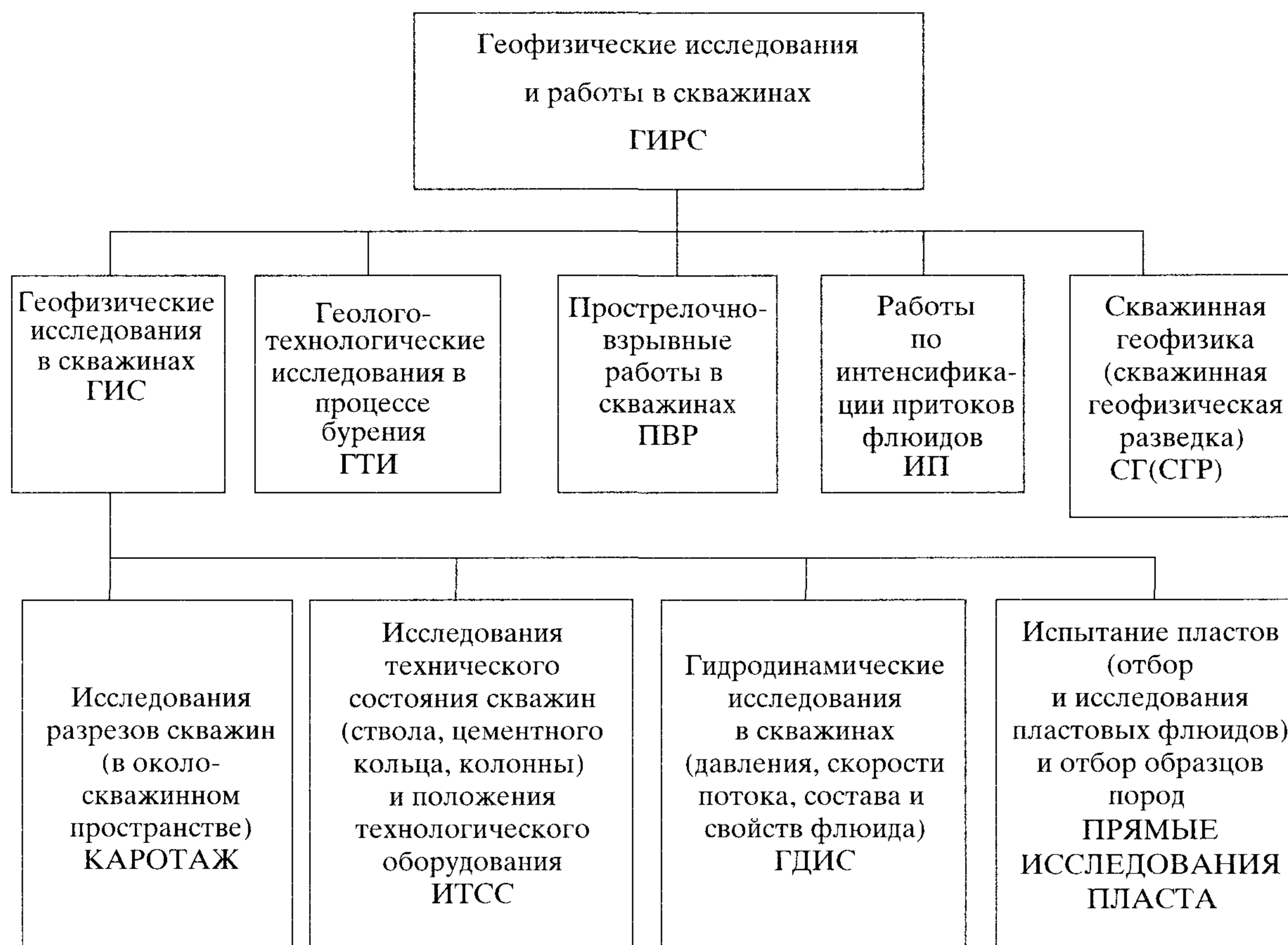
Рисунок 1. Виды геофизических исследований и работ в нефтяных и газовых скважинах по СТ ЕАГО-046-01.
