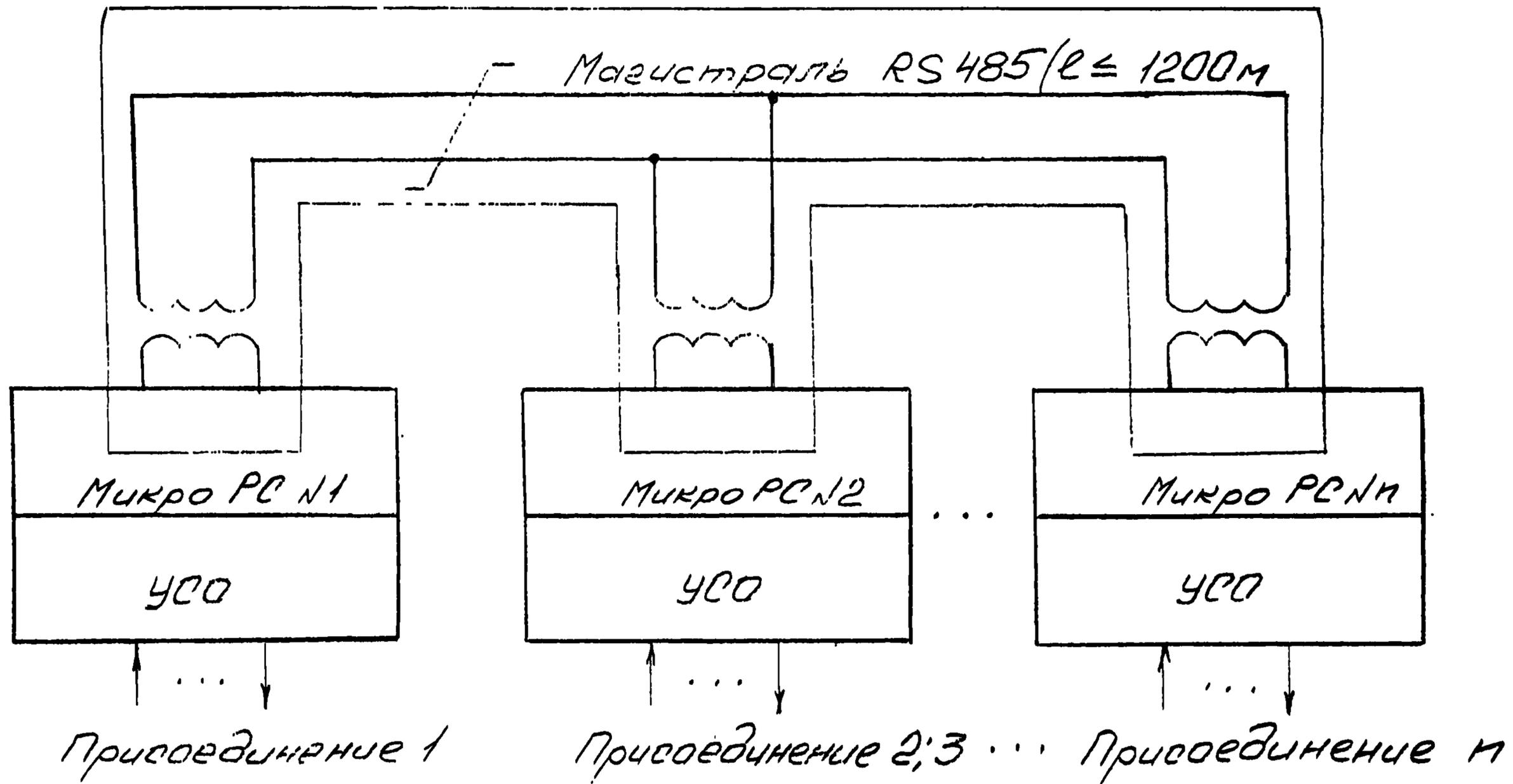
Рис. 2. Структурная схема локального устройства ОБР на микропроцессорной элементной базе.
