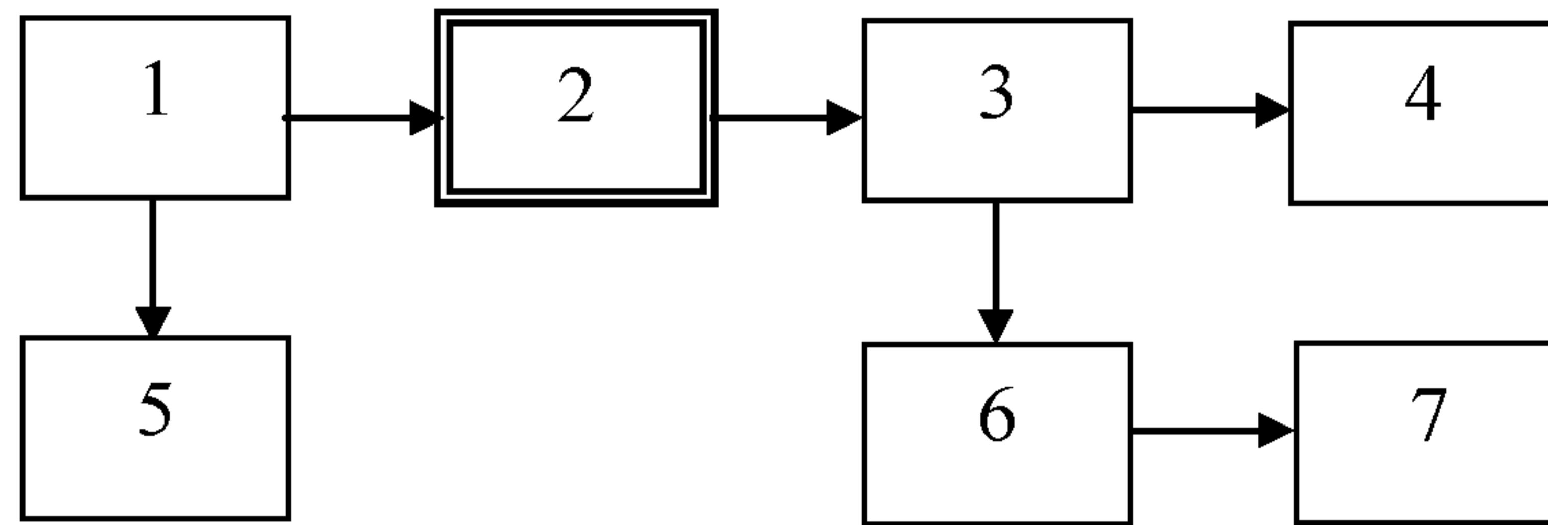
1 – генератор модулирующих сигналов; 2 – контролируемый радиопередатчик (в режиме передачи); 3 – устройство связи (направленный ответвитель); 4 – эквивалентное нагрузочное сопротивление (эквивалент антенны); 5, 7 – электронно-счётные частотомеры; 6 – аттенюатор.
