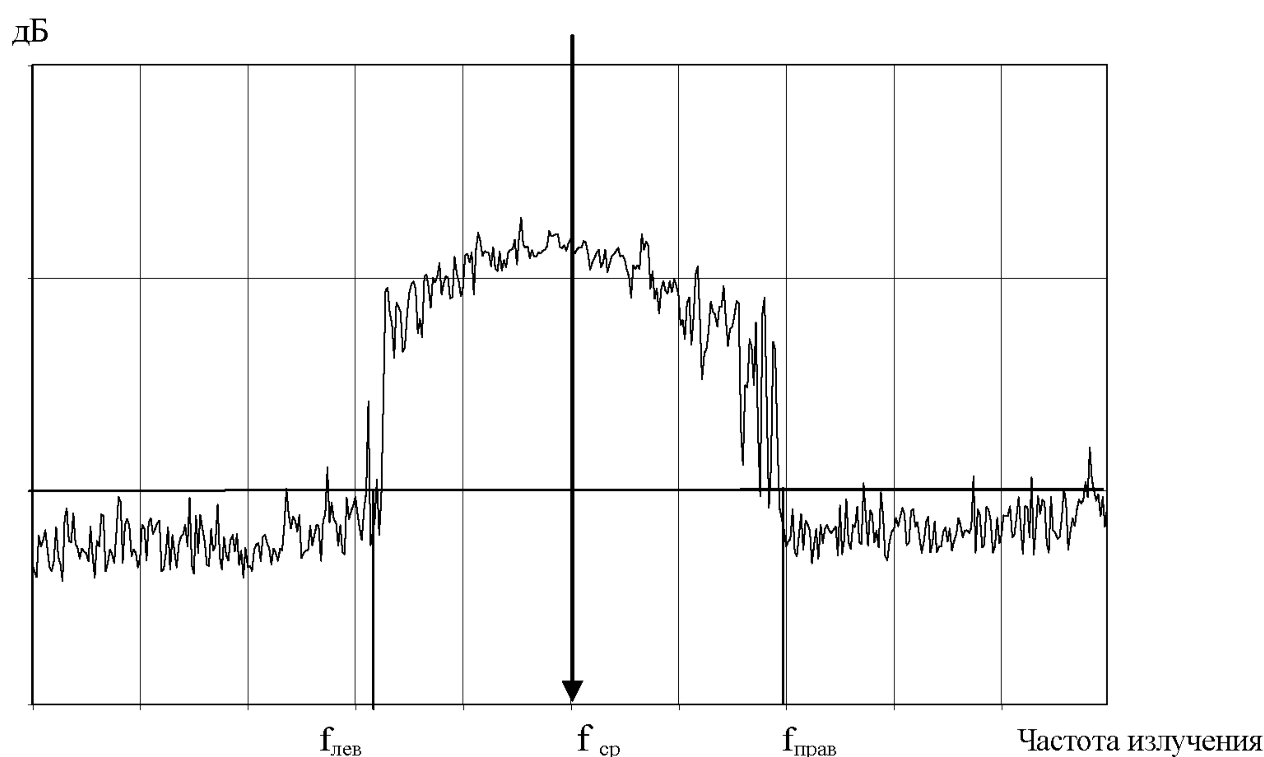
Рисунок 5 – Иллюстрация метода определения  $f_{\text{cp}}$
