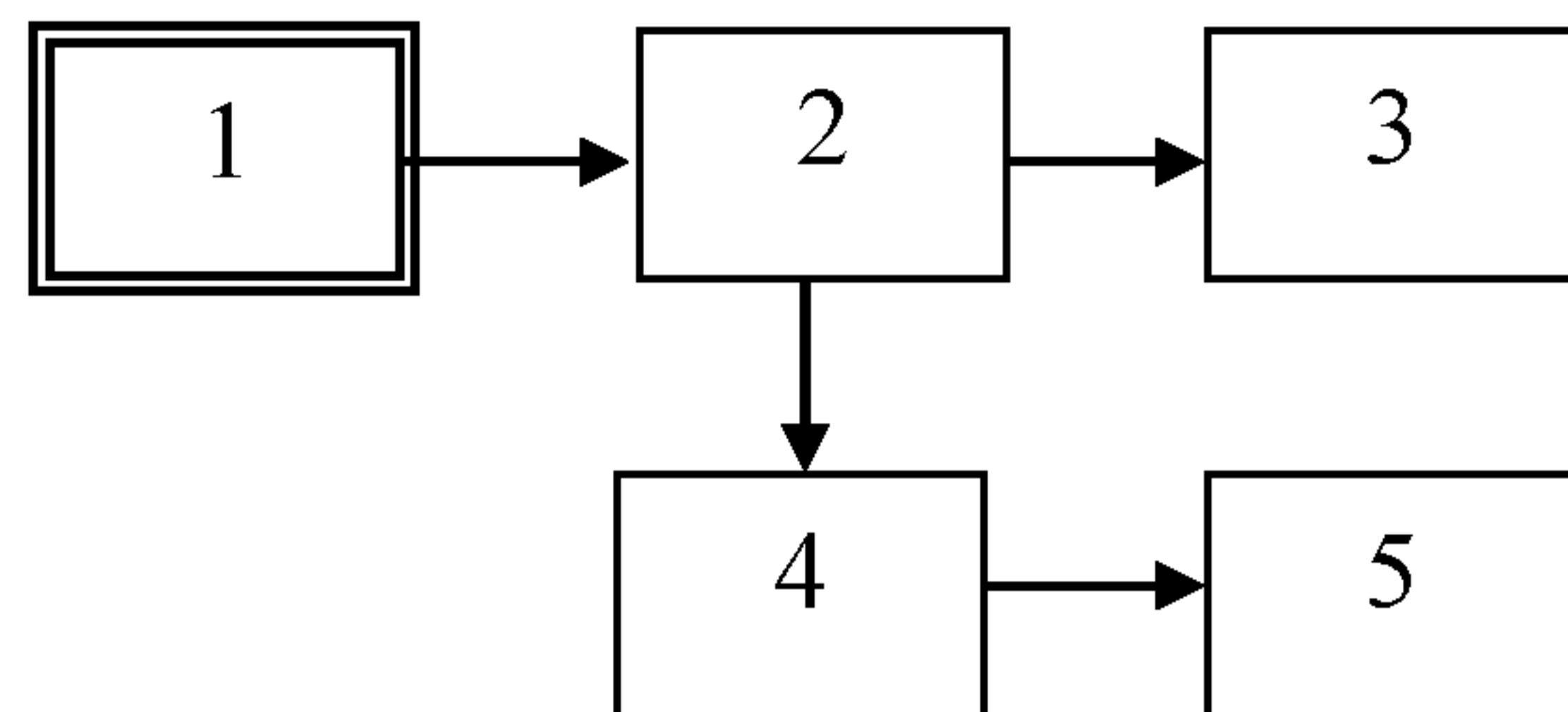
1 – контролируемый радиопередатчик; 2 – устройство связи (направленный ответвитель); 3 – эквивалентное нагрузочное сопротивление (эквивалент антенны); 4 – аттенюатор; 5 – электронно-счётный частотомер.
