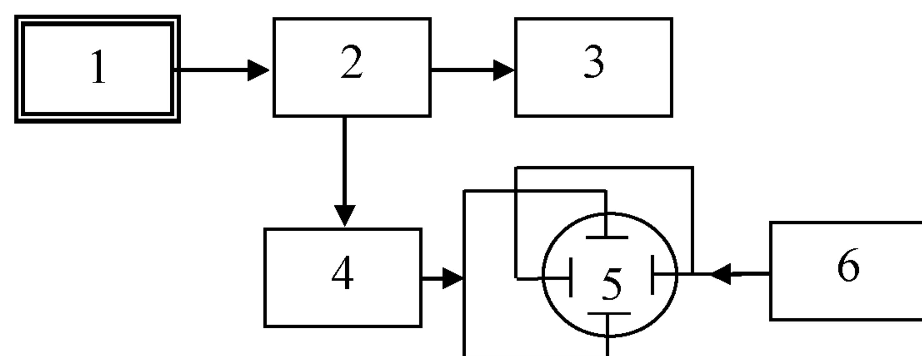
1 – контролируемый радиопередатчик; 2 – устройство связи (направленный ответвитель); 3 – эквивалентное нагрузочное сопротивление (эквивалент антенны); 4 – аттенюатор; 5 – осциллограф; 6 – генератор образцовой частоты.
