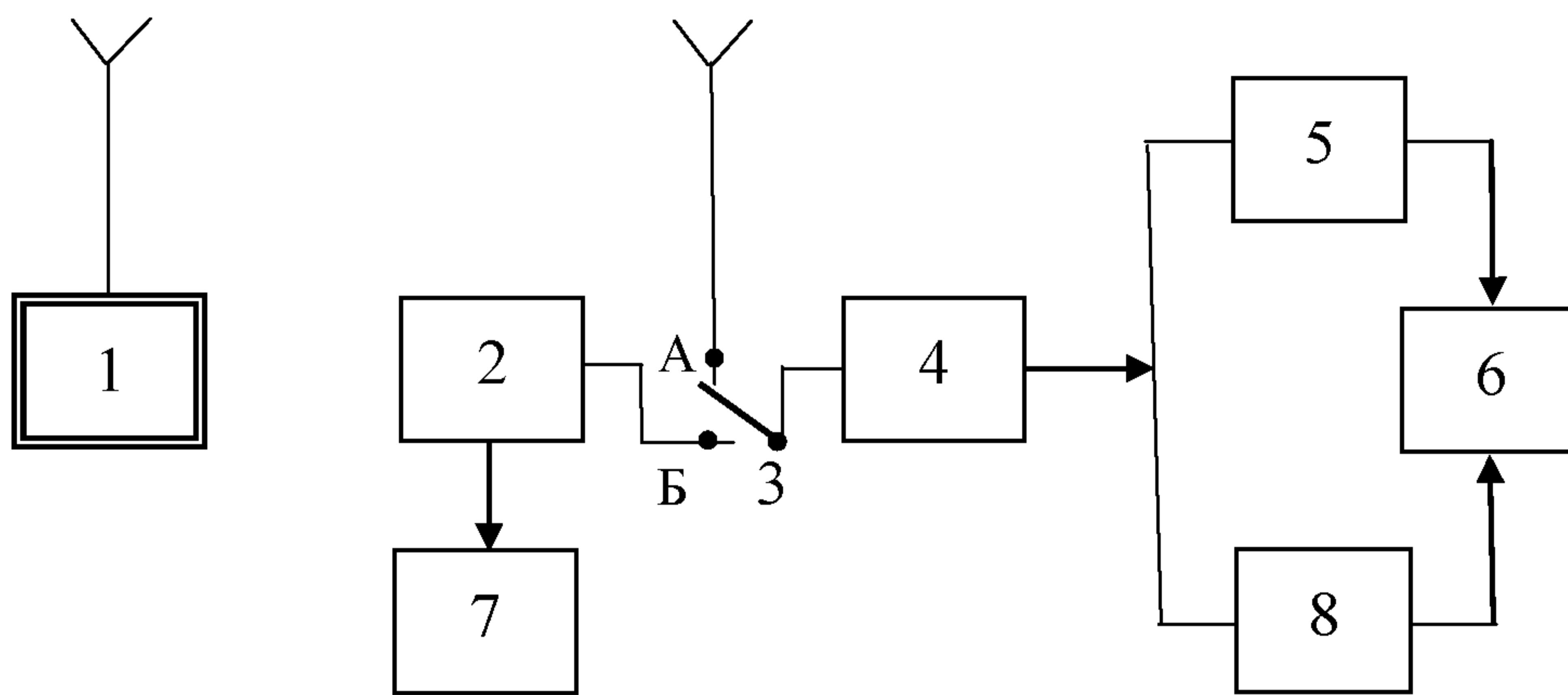
1 – контролируемый радиопередатчик; 2 – синтезатор частоты; 3 – переключатель; 4 – радиоприёмник; 5, 8 – полосовые фильтры, настроенные на первую и вторую гармоники основной частоты речевого спектра; 6 – осциллограф; 7 – электронно-счётный частотометр.
