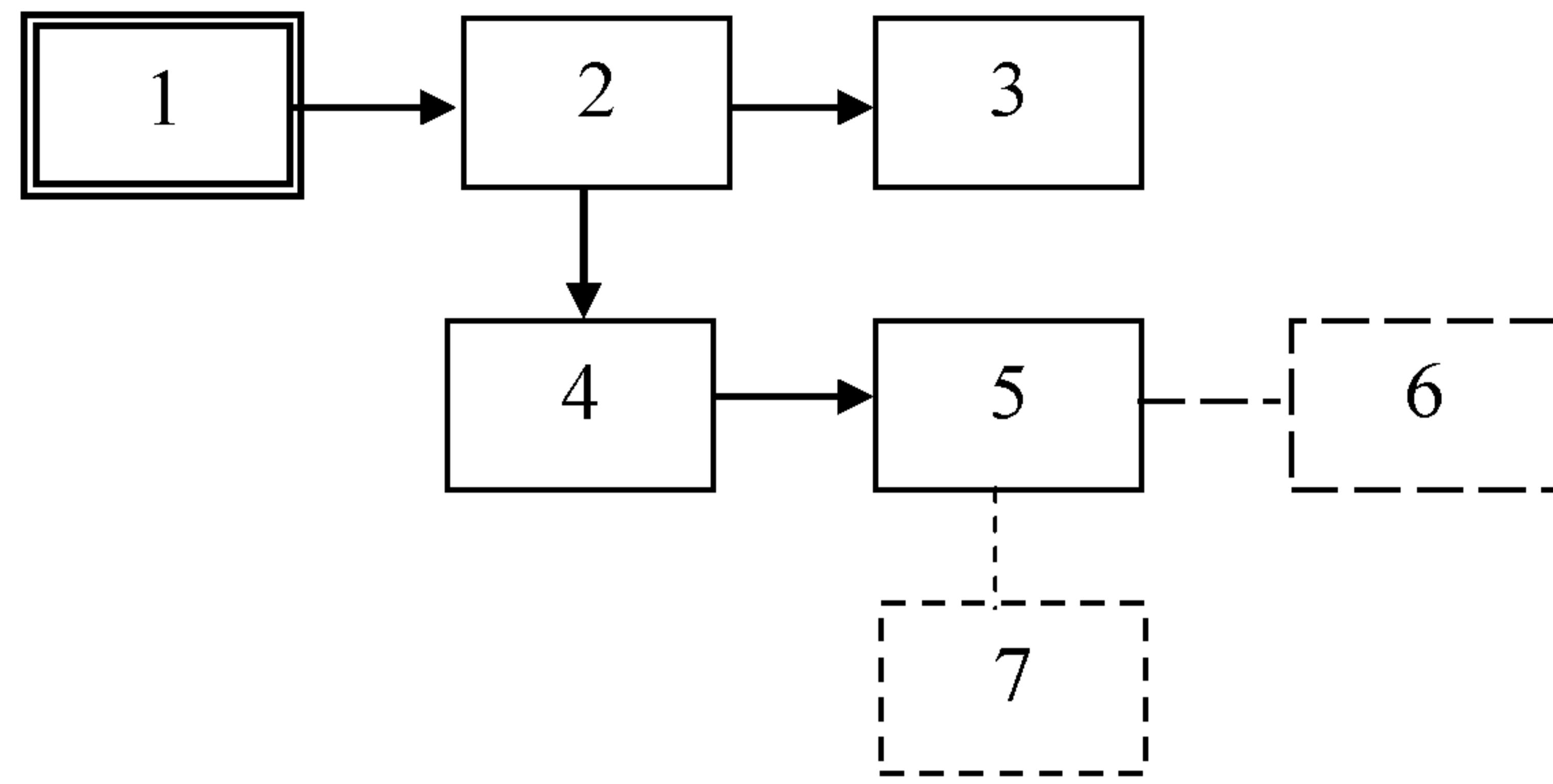
1 – контролируемый радиопередатчик; 2 – устройство связи (направленный ответвитель); 3 – эквивалентное нагрузочное сопротивление (эквивалент антенны); 4 – аттенюатор; 5 – анализатор спектра; 6 – внешний частотометр; 7 – стандарт частоты.
