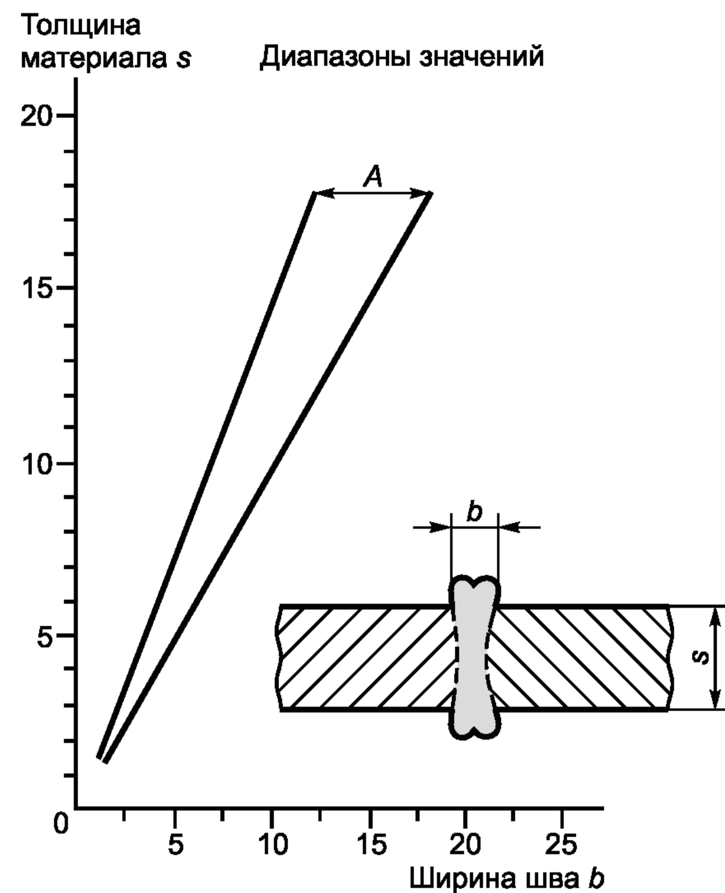
Рисунок 1 — Зависимость ширины сварного шва от толщины материала
