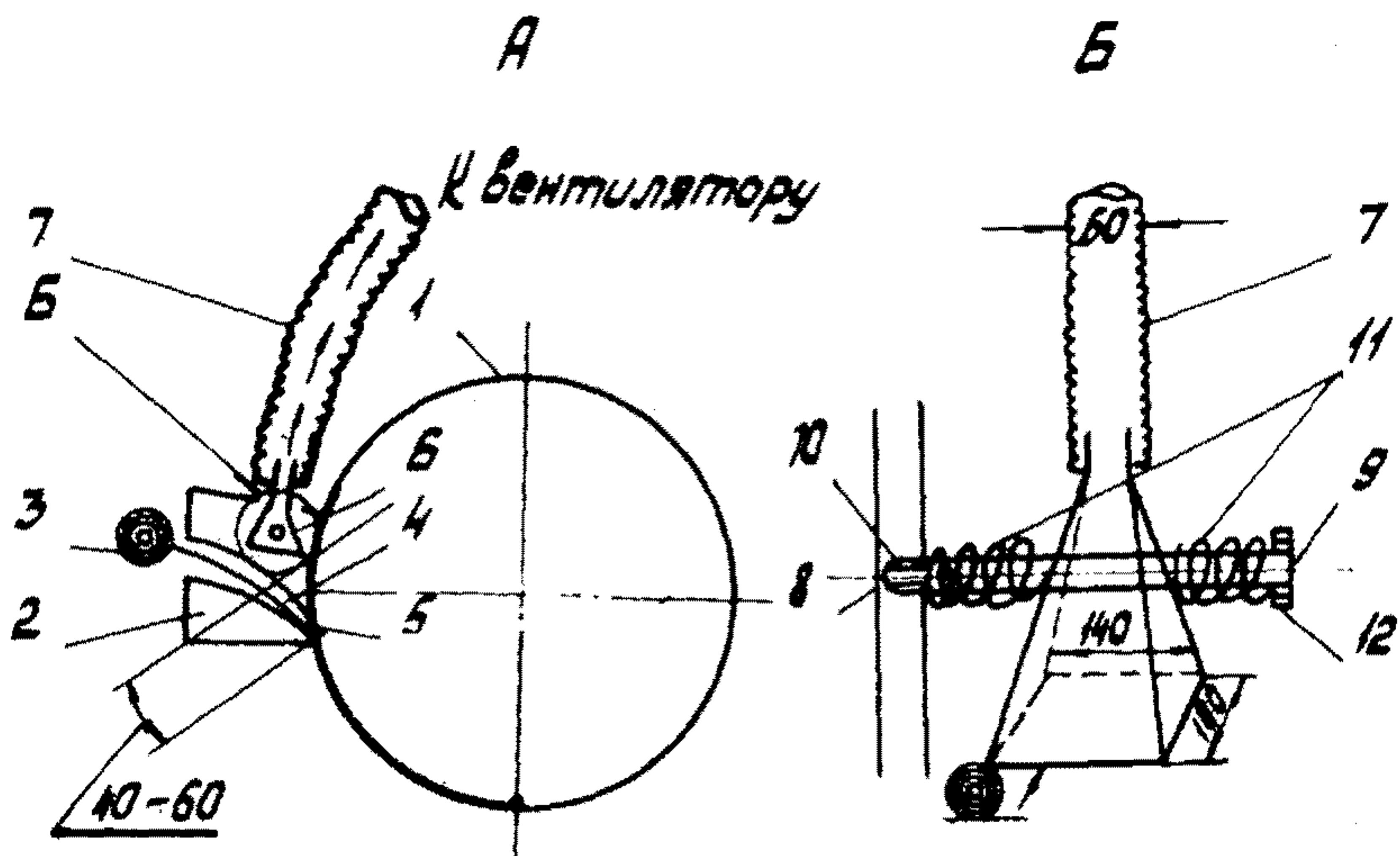
Схема устройства местной вытяжной механической вентиляции от места сварки, выполняемой автоматом:
