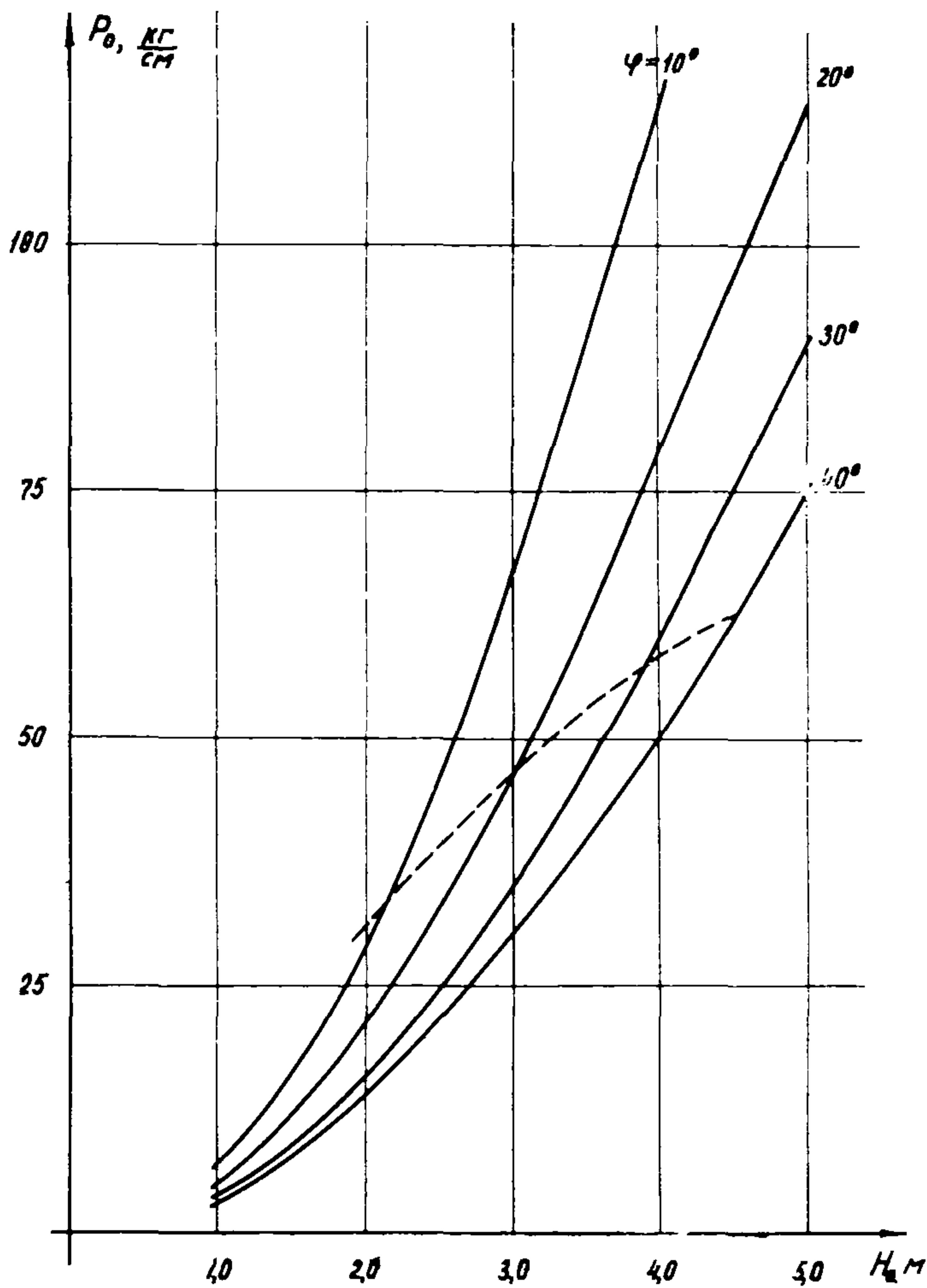
Рис.5. Зависимость усилия на распоры  $P_o$  от высоты стенки  $H_o$  по II варианту технологии
