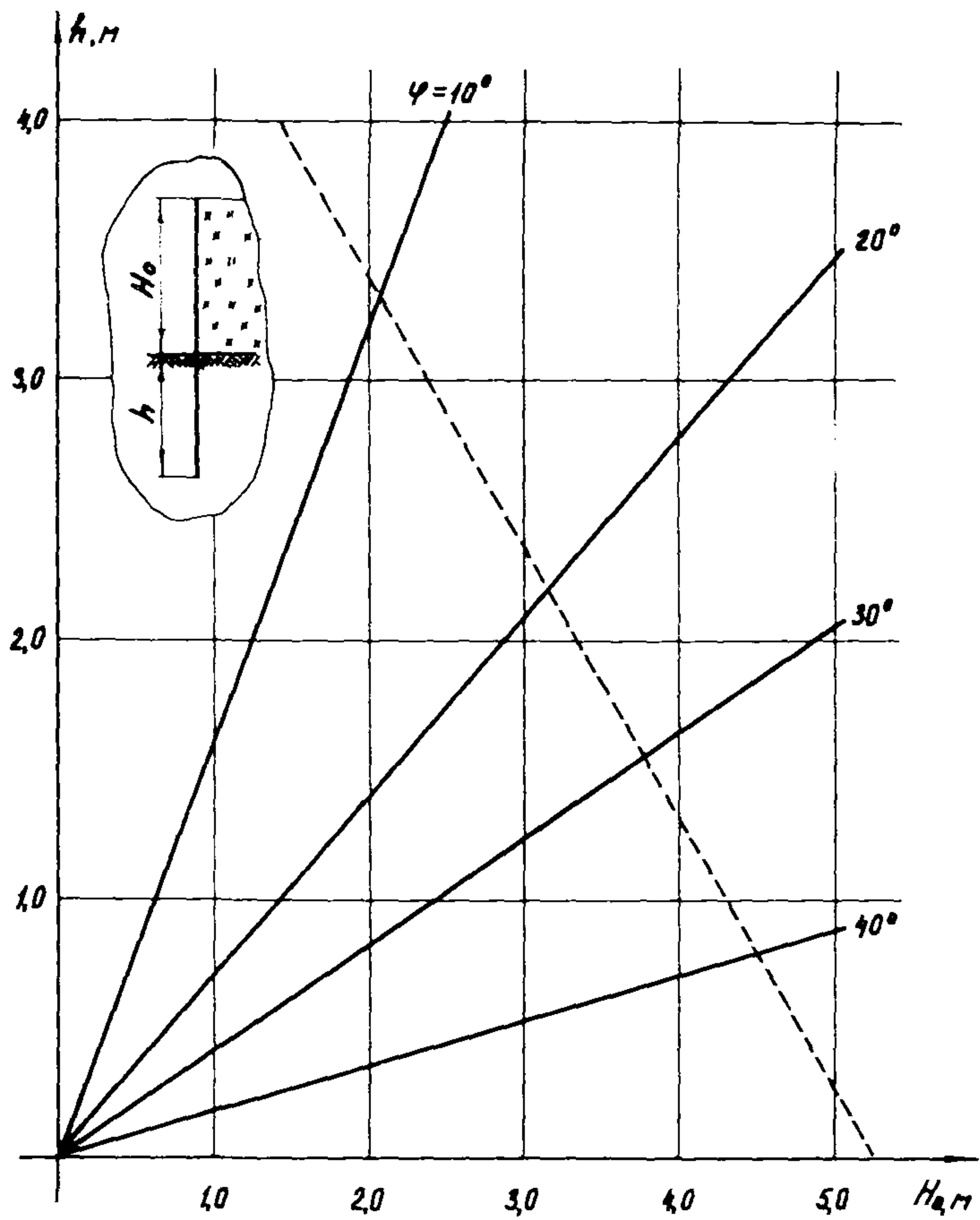
Рис.3. Зависимость  $H_0 - h$  по II варианту технологии
