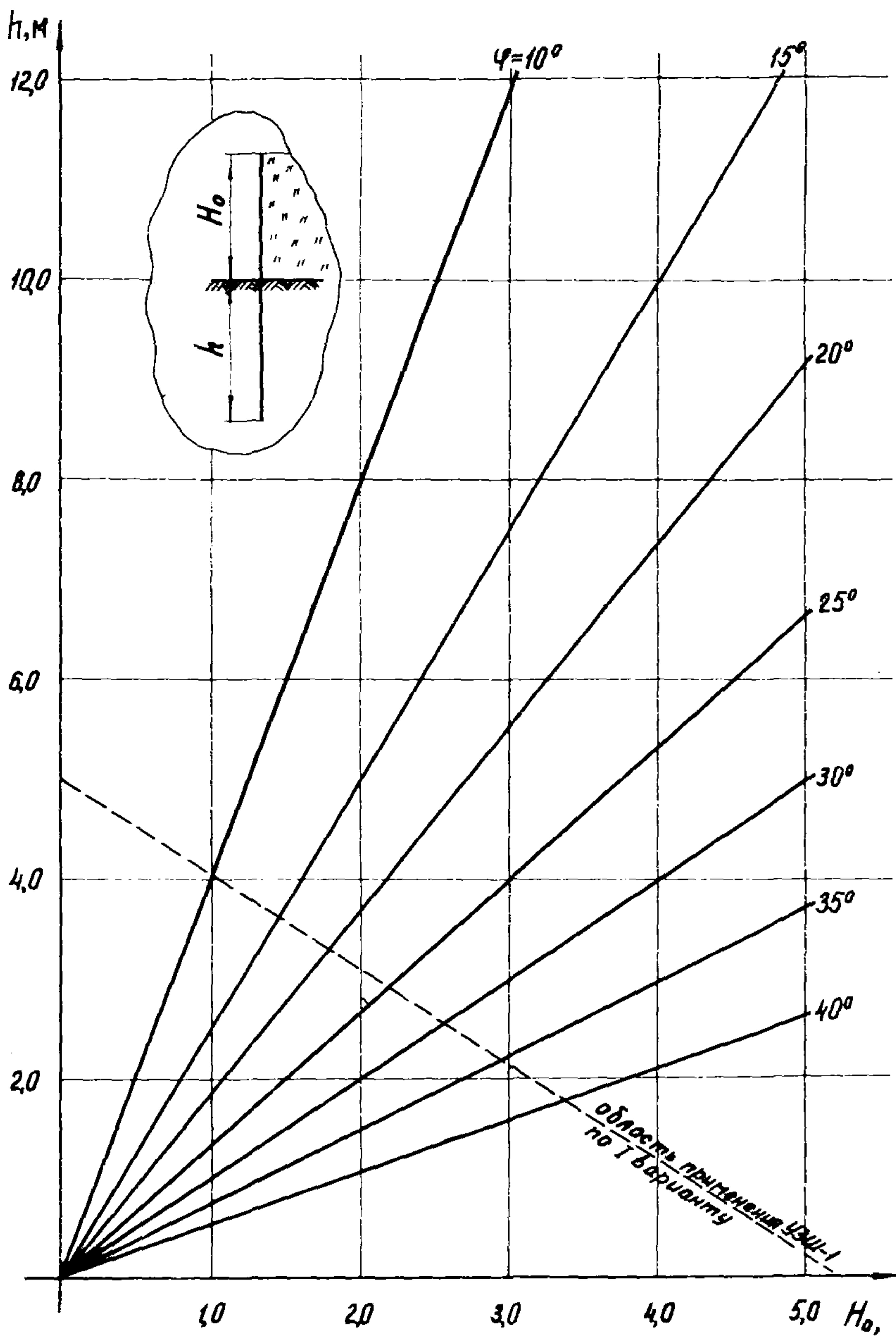
Рис. I. Зависимость  $H_0 - h$  по I варианту технологии
