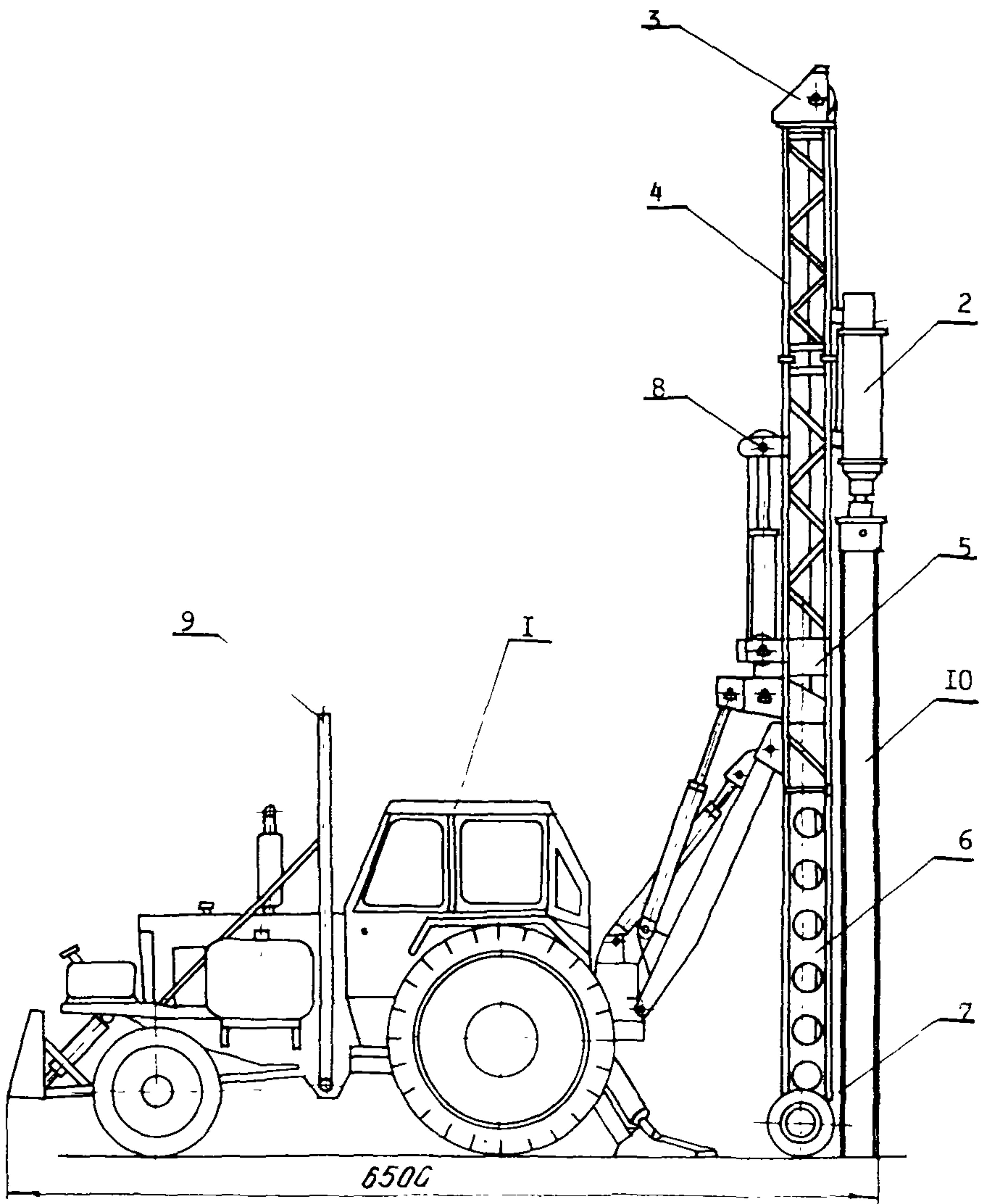
Рис. I. Установка для забивки шпунтов УЗШ-1 (вид сбоку):
