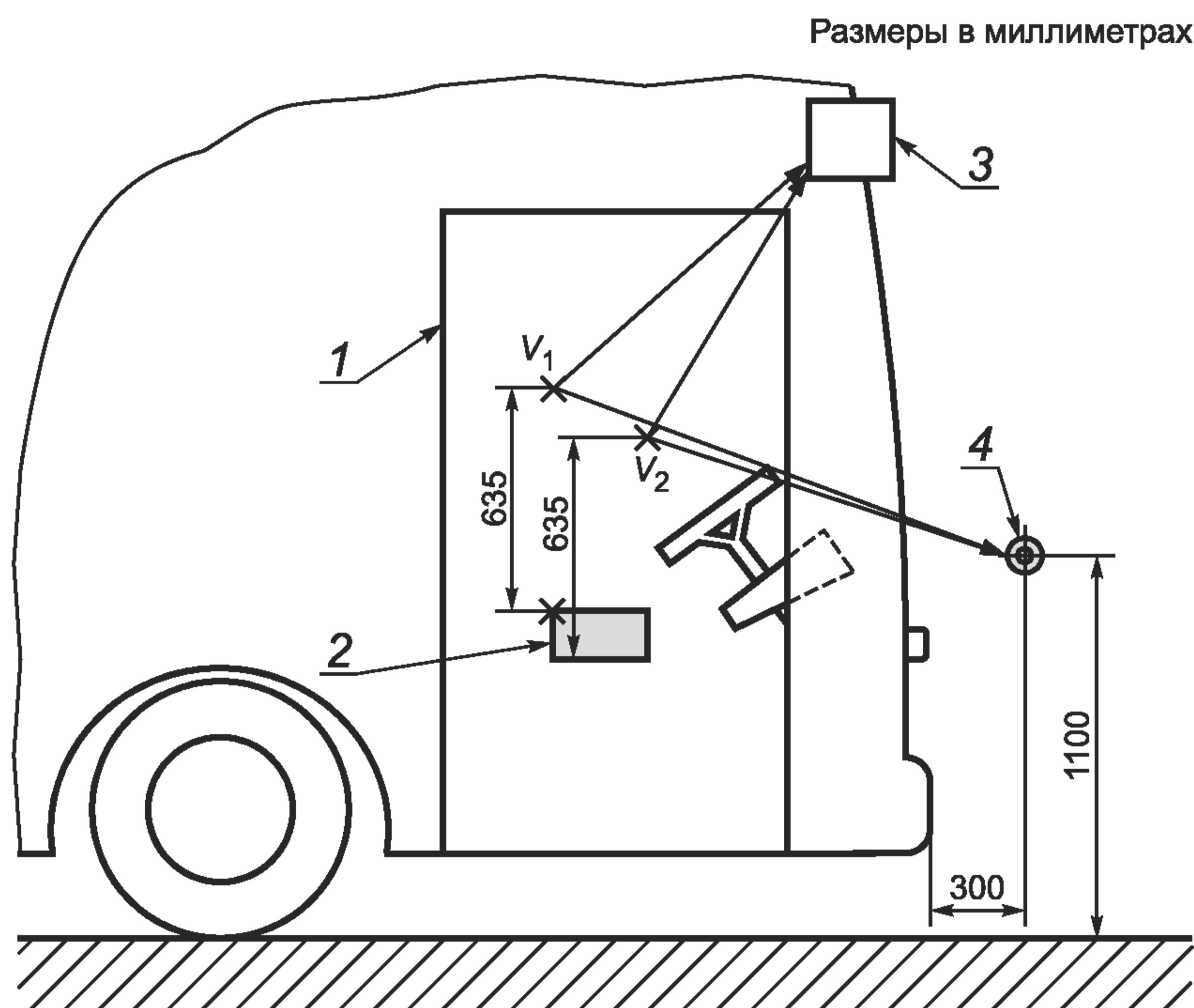
1 — служебная дверь; 2 — требуемый диапазон регулировки точки  $H$  сиденья в соответствии с ИСО 16121-1; 3 — альтернативное устройство, например зеркало, видео система и т. д.; 4 — перекладина, как определено в 4.1.1
