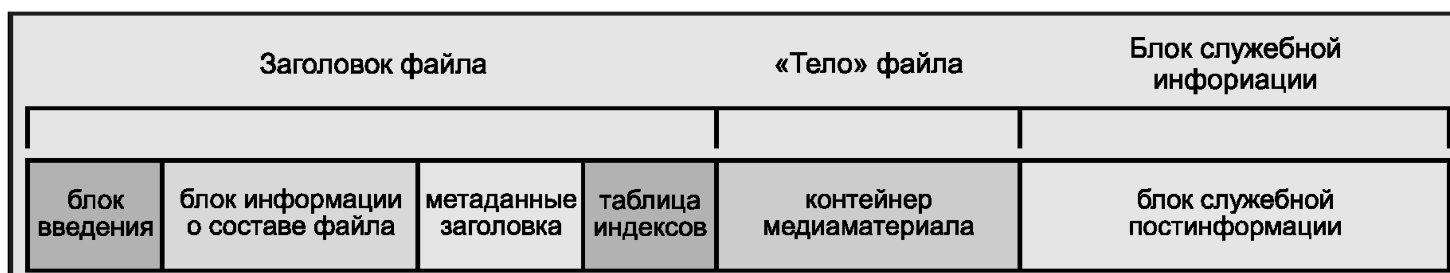
Рисунок П.1 — Основные компоненты простого MXF-файла
