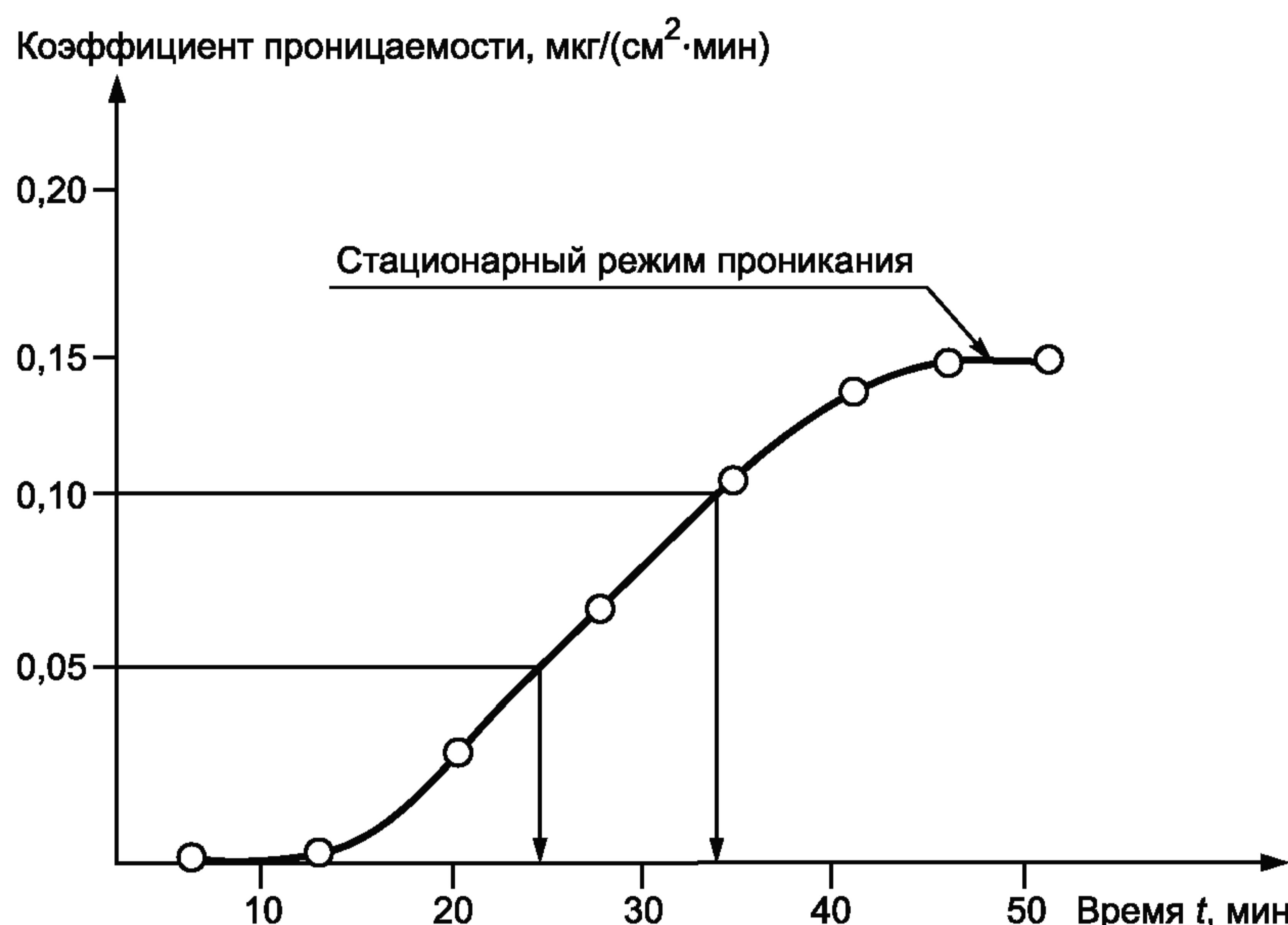
Рисунок 1 — Определение времени регистрации проникания
