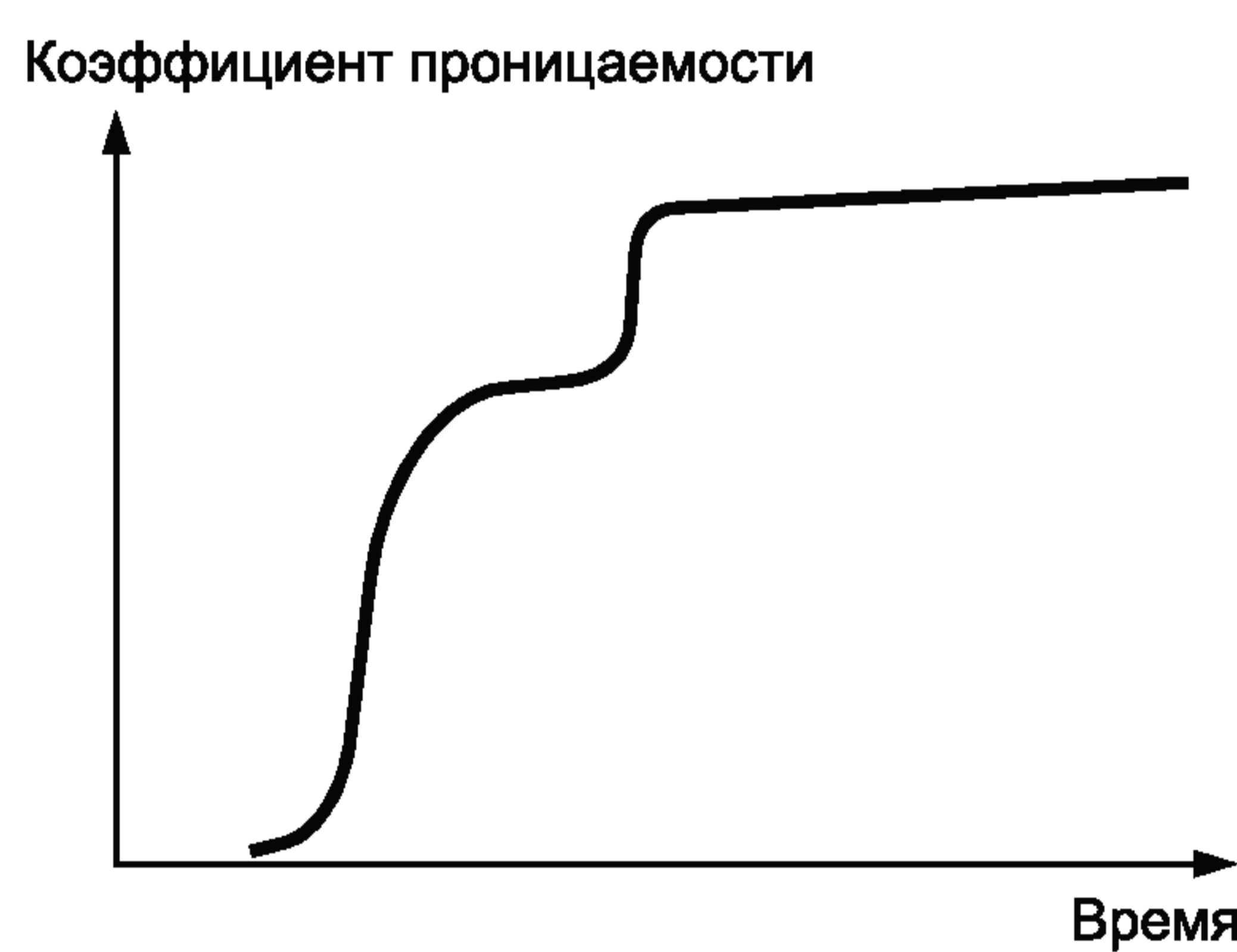
в) Тип кривой проникания, характерный для случаев, когда под действием испытательного вещества внезапно происходит резкое увеличение объема элементарной пробы материала
