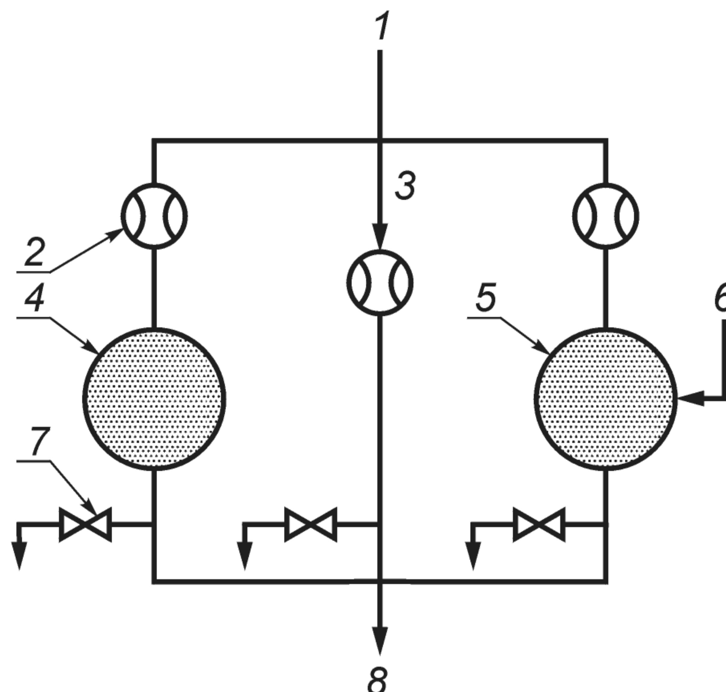
1 — свежая среда-носитель; 2 — расходомер; 3 — подача калибровочного газа; 4 — испытательная ячейка 1 (пустая); 5 — испытательная ячейка 2 (с модификацией для впрыска испытательной жидкости); 6 — впрыск испытательной жидкости; 7 — регулятор расхода; 8 — к аналитическому прибору
