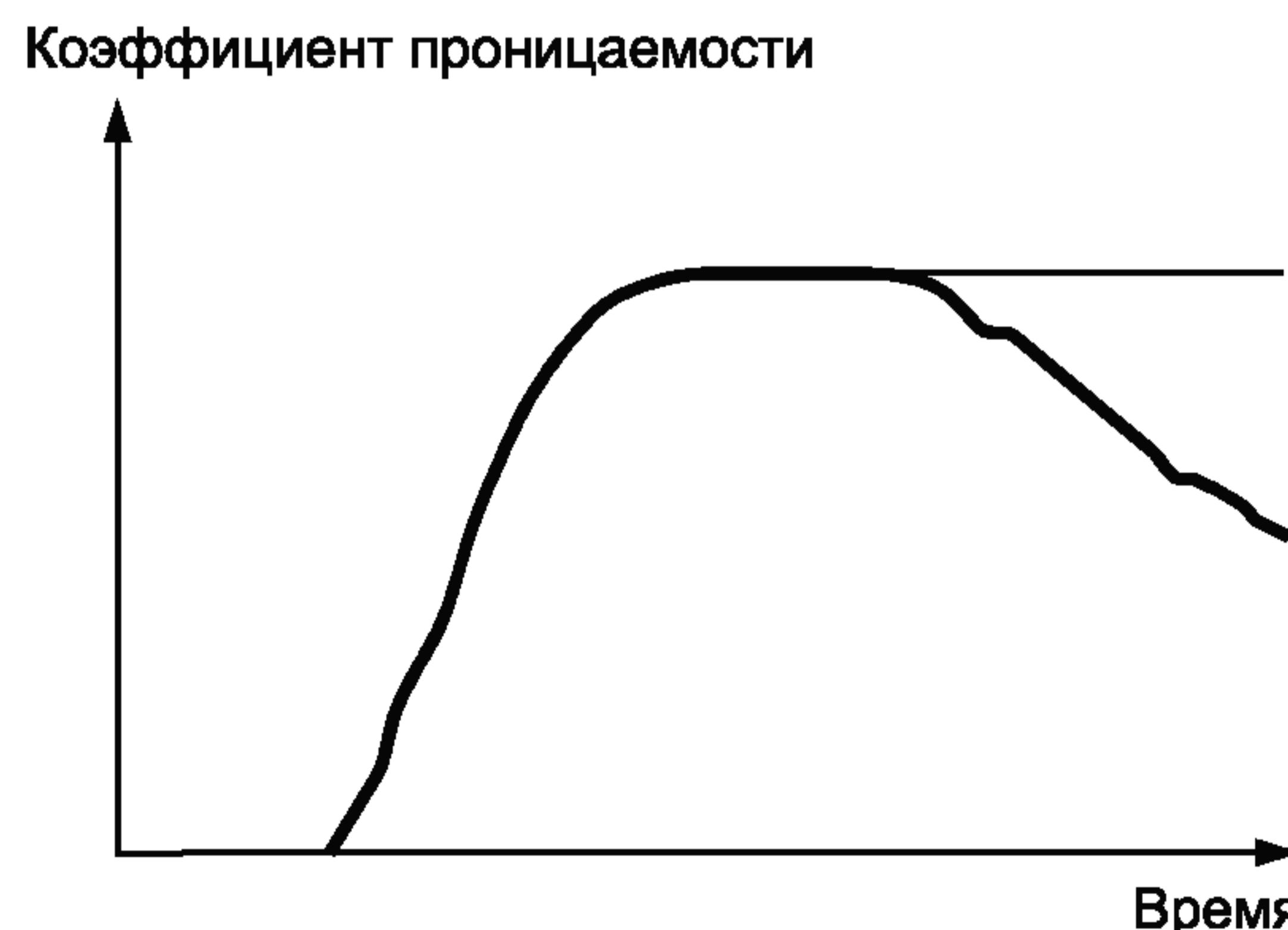
г) Тип кривой проникания для элементарной пробы материала, структурно изменяемого испытательным веществом, что проявляется в увеличении или уменьшении проникания
