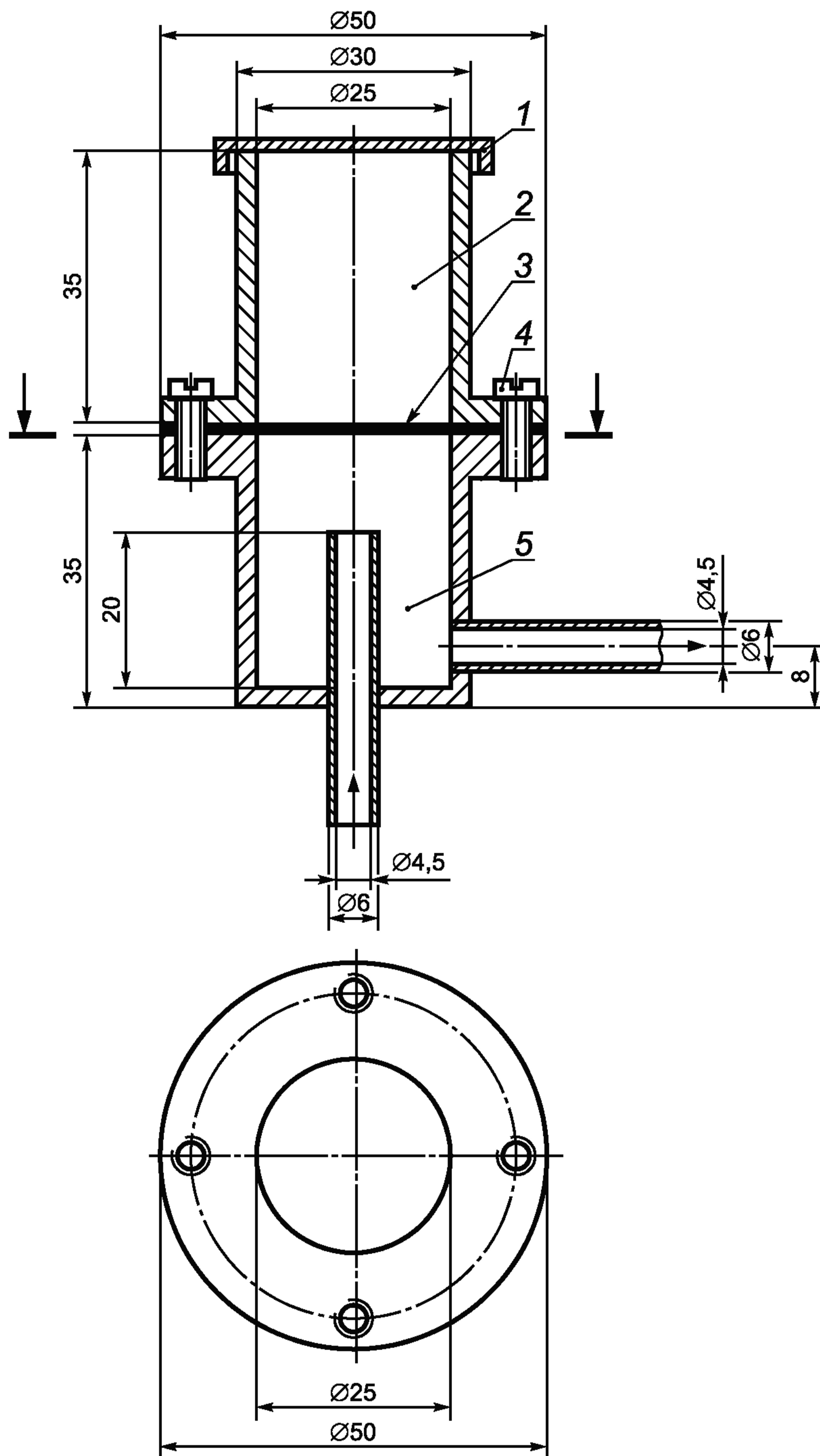
1 — открываящаяся крышка; 2 — камера для жидкости; 3 — элементарная проба материала; 4 — винты; 5 — проточная камера
