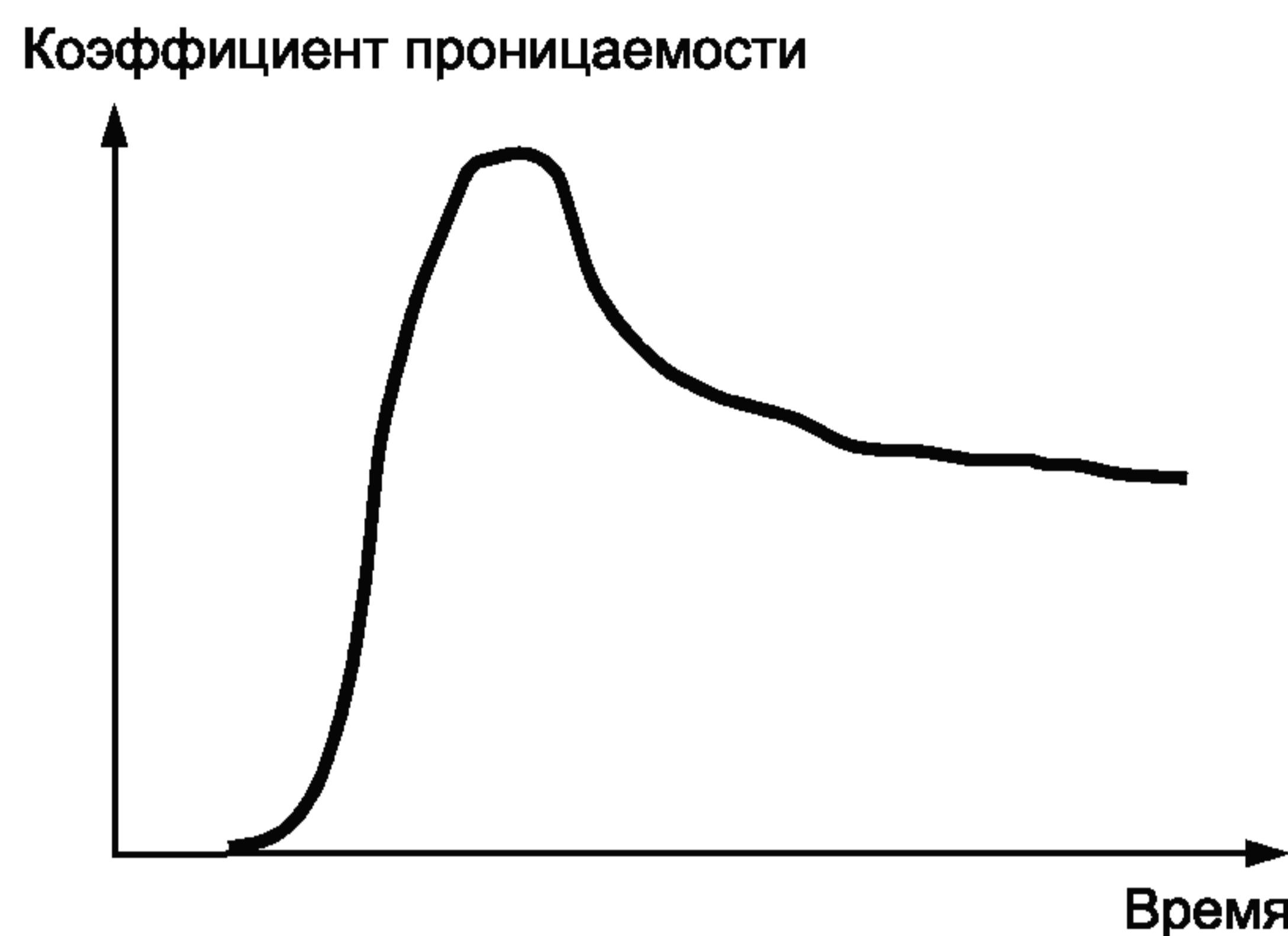
д) Тип кривой проникания, характерный для случаев, когда элементарная проба набухает, но процесс проникания стабилизируется
