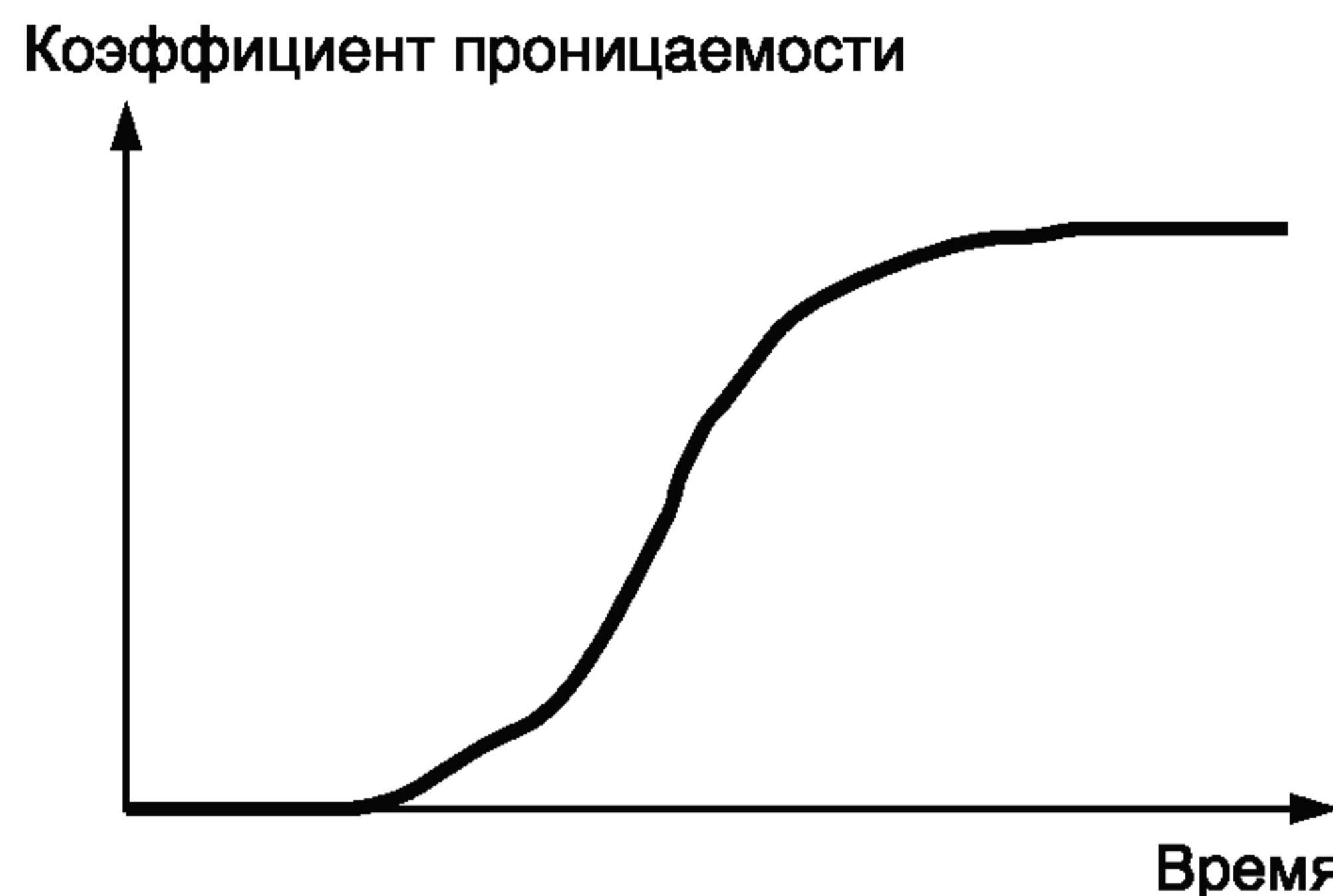
а) Наиболее распространенный тип кривой проникания, когда процесс проникания достигает стационарного режима
