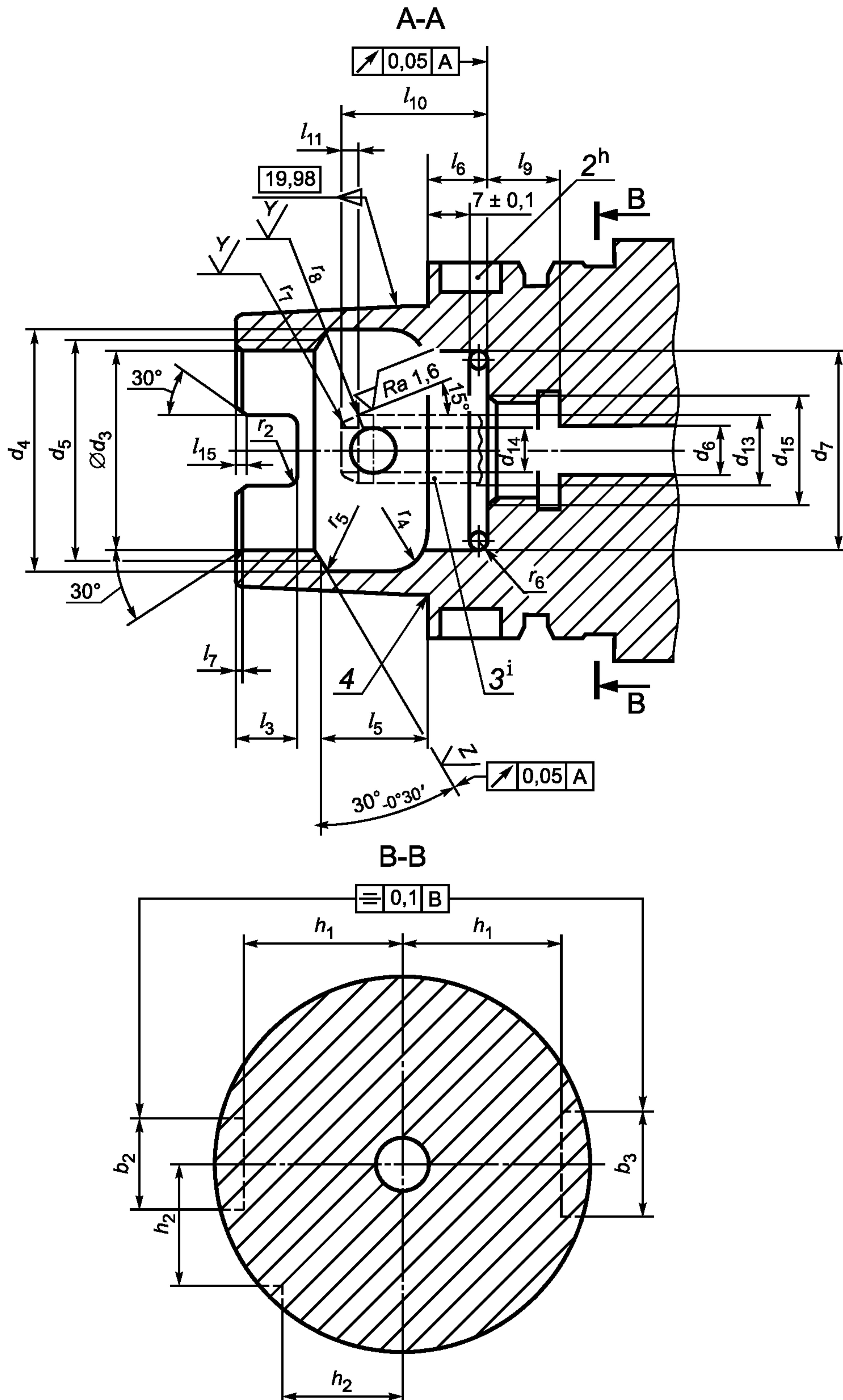
2 — гнездо для установки чипа; 3 — отверстие для подвода СОЖ; 4 — канавка для выхода шлифовального круга
