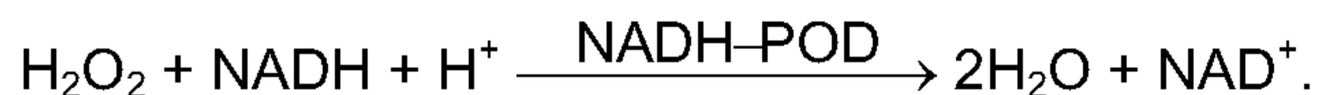
Массовая концентрация общего диоксида серы должна быть эквивалентной количеству израсходованного НАДН, что определяется по изменению оптической плотности, измеренной при длинах волн: 334, 340 или 365 нм.
