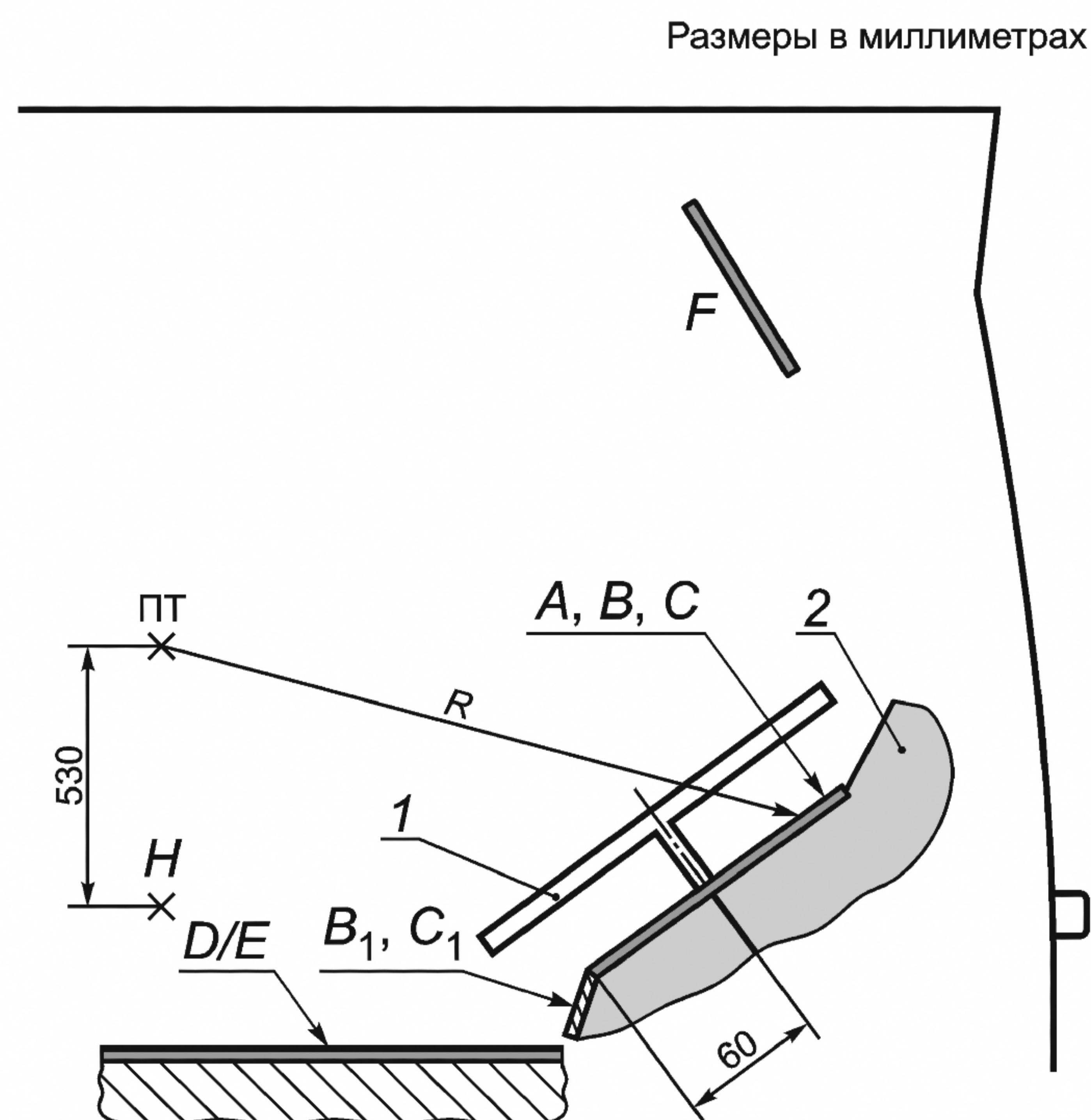
1 — рулевое колесо; 2 — приборная панель; A — зона A (3.1.4); B — зона B (3.1.5); B<sub>1</sub> — зона B<sub>1</sub> (3.1.7); C — зона C (3.1.6); ПТ — плечевая точка; C<sub>1</sub> — зона C<sub>1</sub> (3.1.8); D — зона D (3.1.9); E — зона E (3.1.10); F — зона F (3.1.11); точка H — соответствует водителю невысокого роста; R — диапазон досягаемости руки = 750 мм
