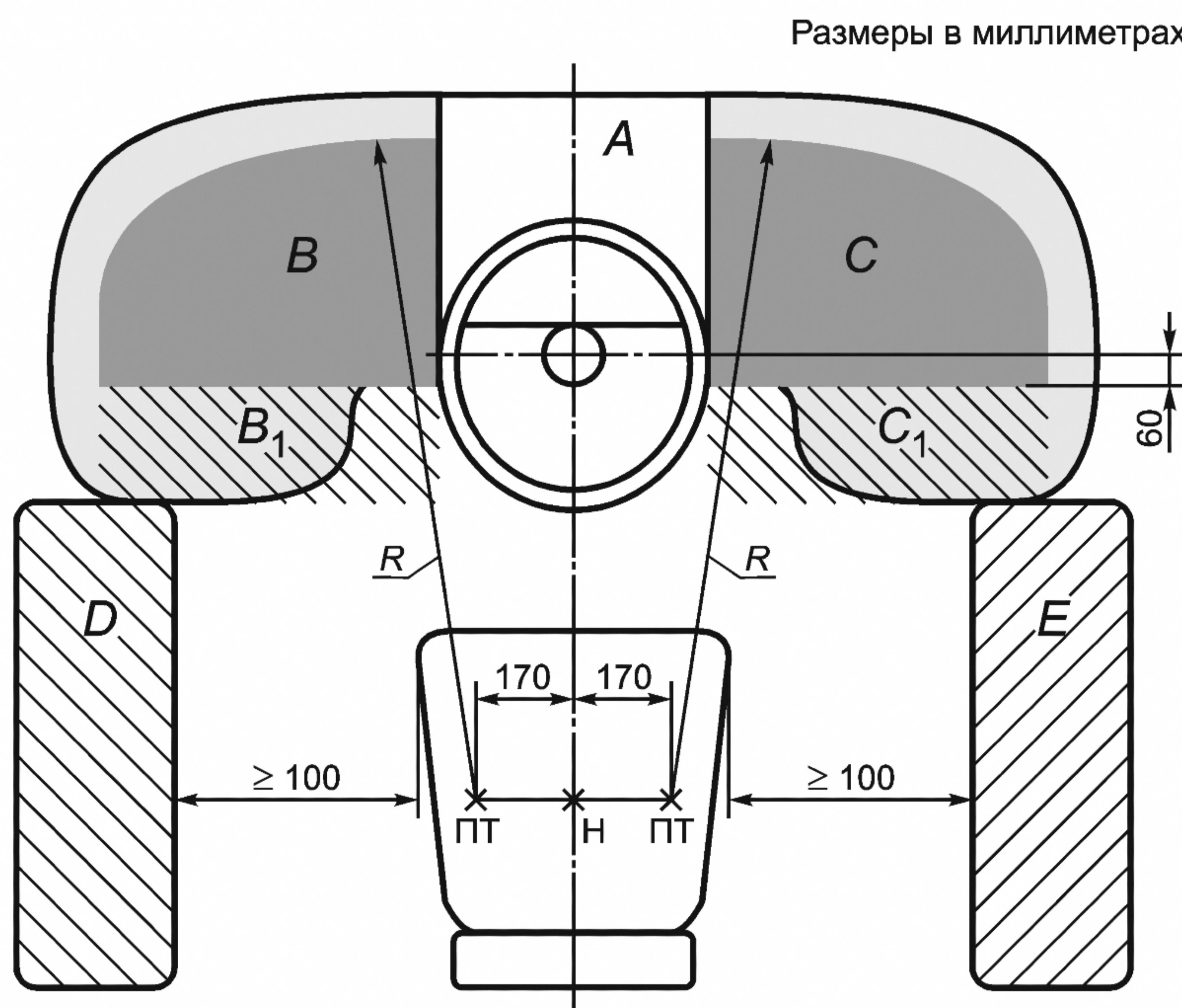
A — зона A (3.1.4); B — зона B (3.1.5); B<sub>1</sub> — зона B<sub>1</sub> (3.1.7); C — зона C (3.1.6); C<sub>1</sub> — зона C<sub>1</sub> (3.1.8); D — зона D (3.1.9); E — зона E (3.1.10); точка H — соответствует водителю невысокого роста; R — диапазон досягаемости руки = 750 мм; ПТ — плечевая точка
