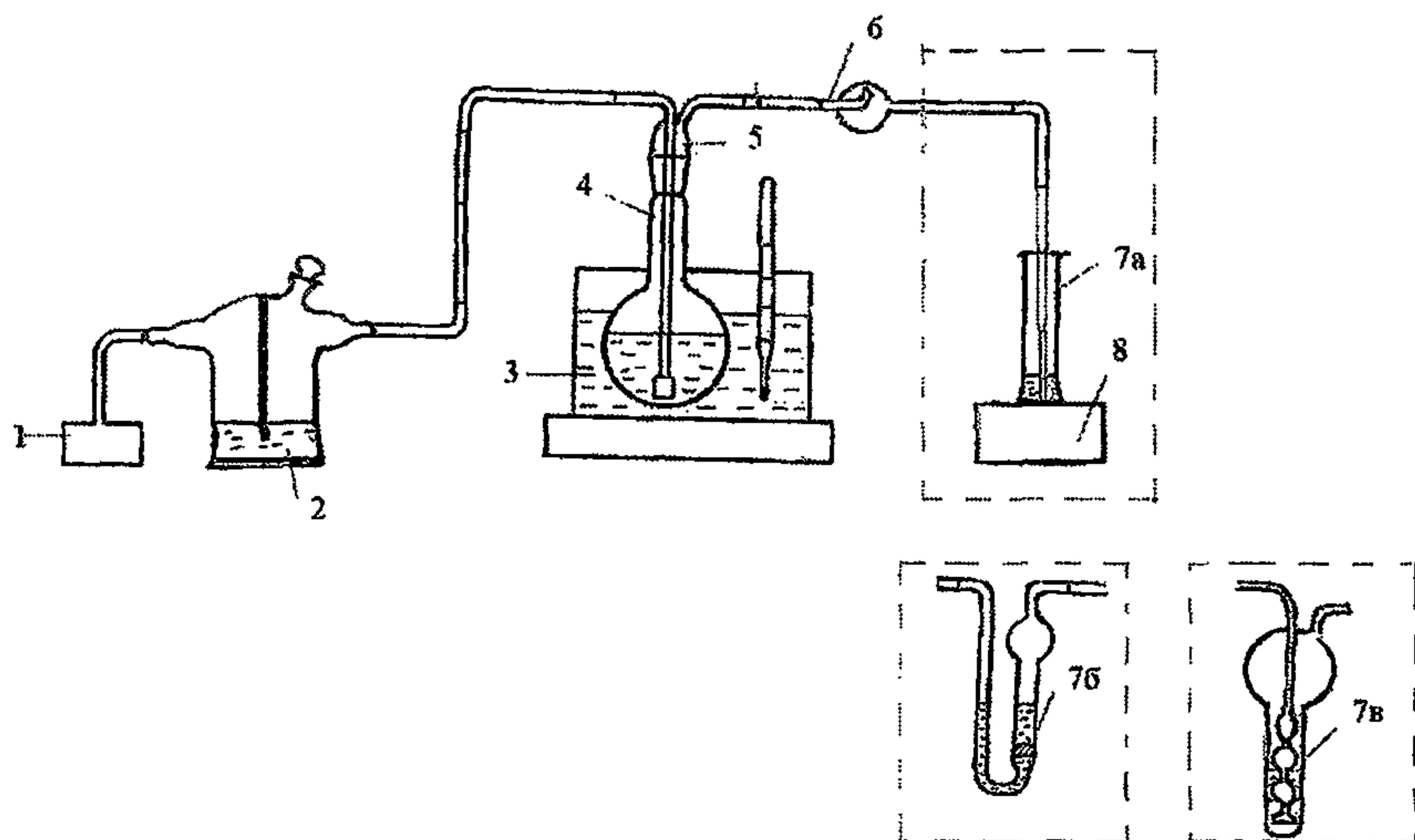
1 - микрокомпрессор; 2 – склянка для промывания газов СПЖ; 3 – водяная баня с терморегулятором; 4 – круглодонная колба; 5 - насадка к склянке для промывания газов СН; 6 - каплеуловитель; 7 – поглотительный сосуд (7а - цилиндр мерный с пипеткой Пастера, 7б – поглотитель с пористой пластиной, 7в – поглотитель Рихтера); 8 – подставка
