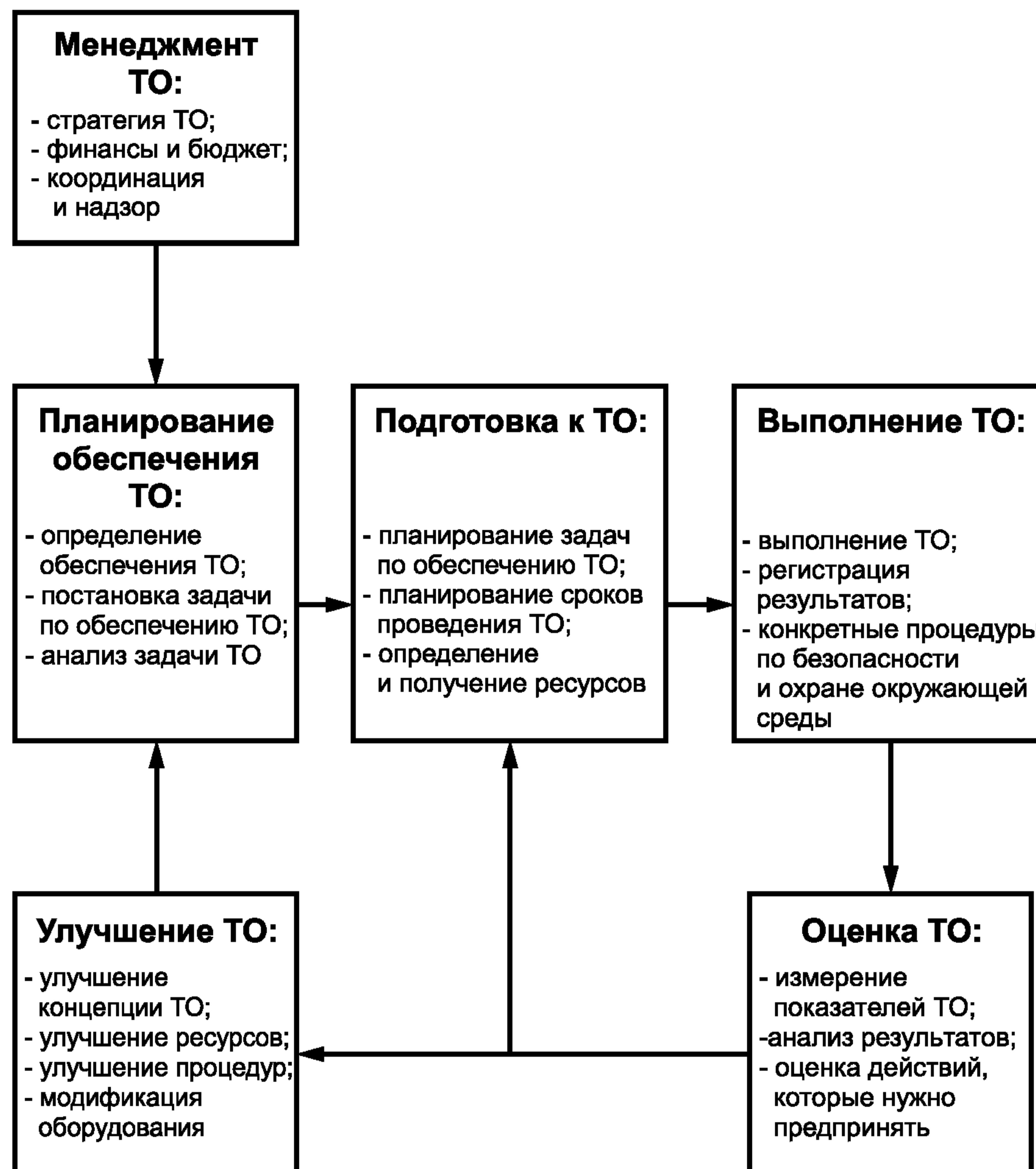
Рисунок 3 — Процессы технического обслуживания
