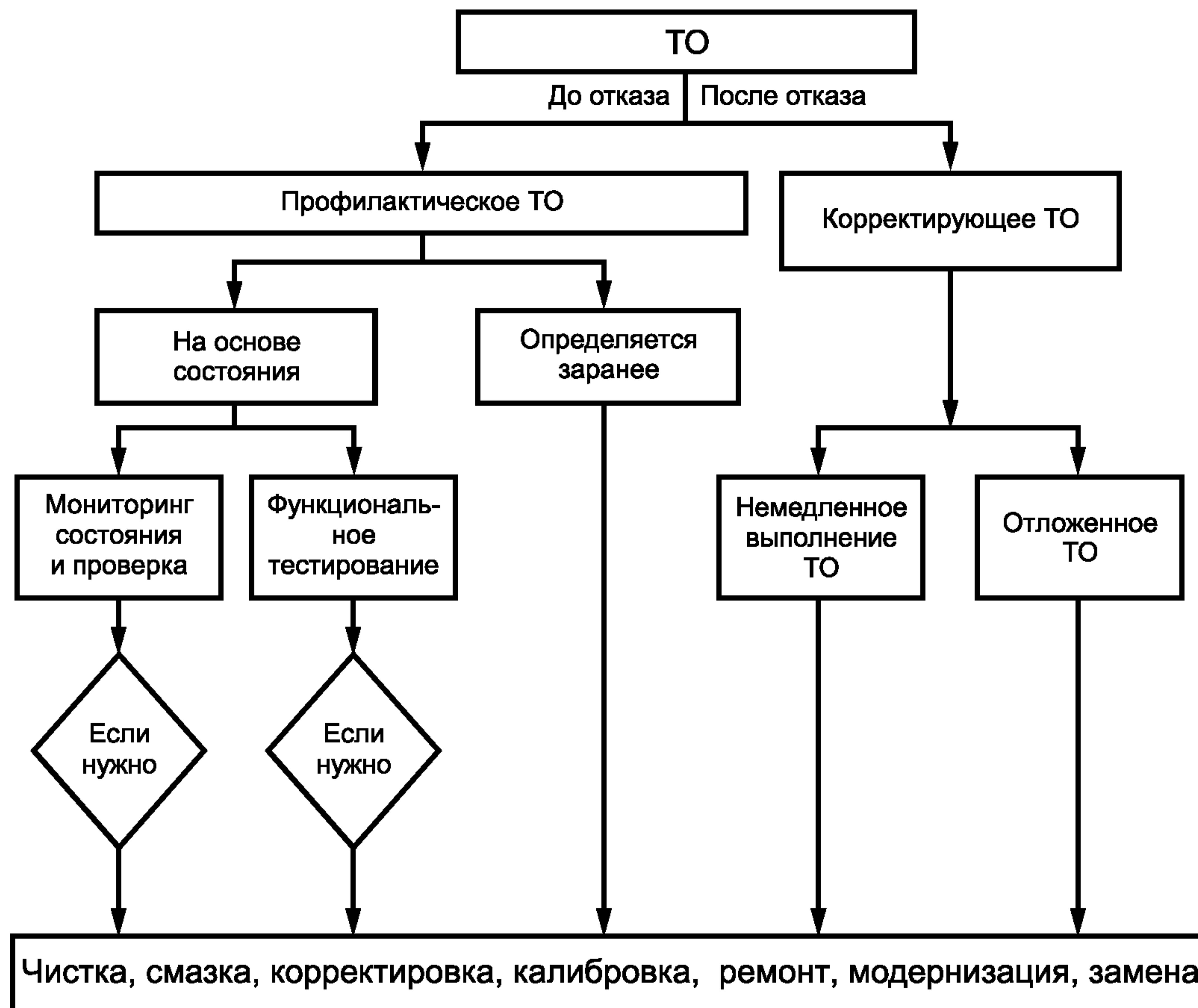
Рисунок 2 — Типы работ по техническому обслуживанию
