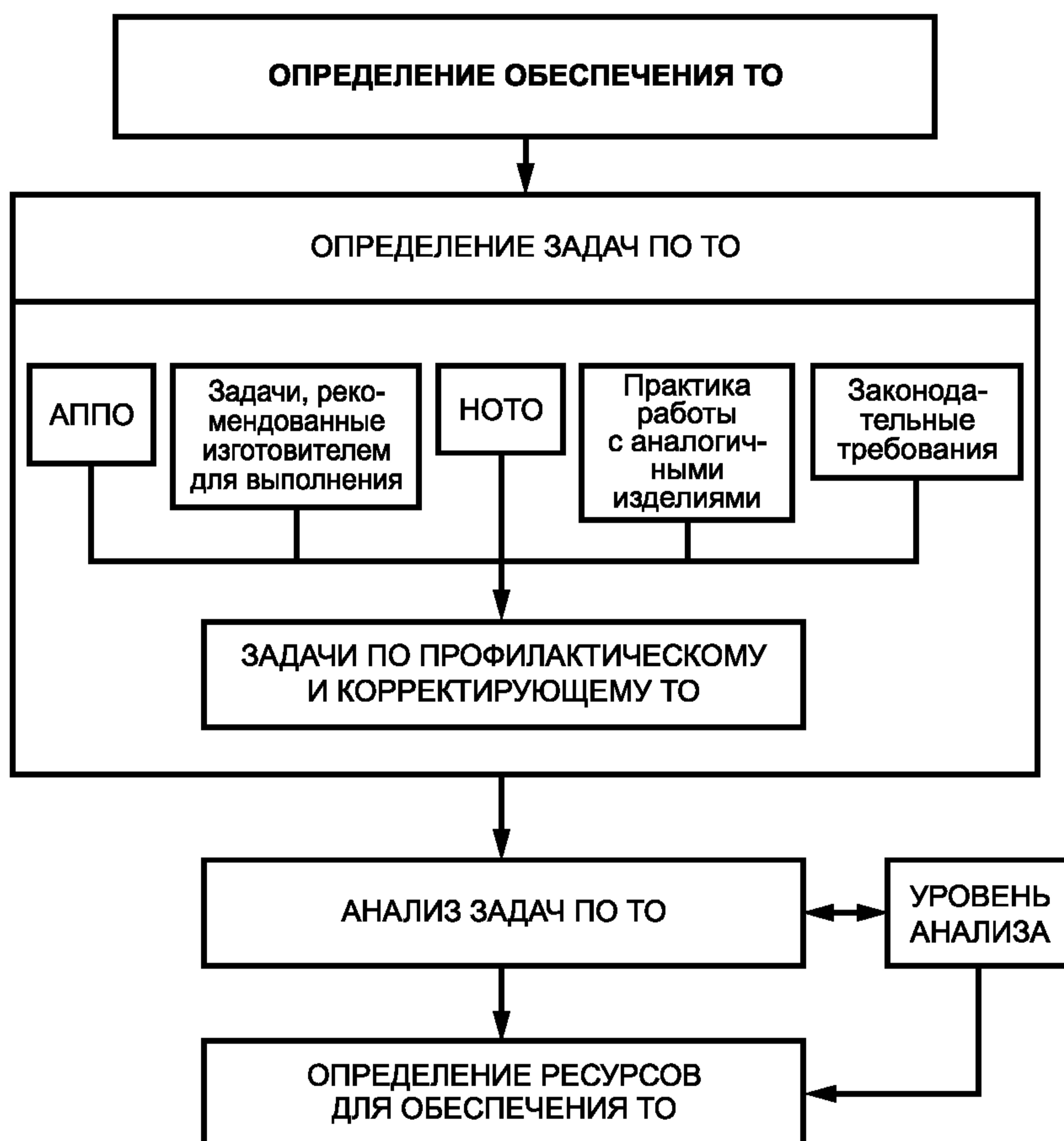
Рисунок 4 — Элементы планирования ТО и обеспечения ТО
