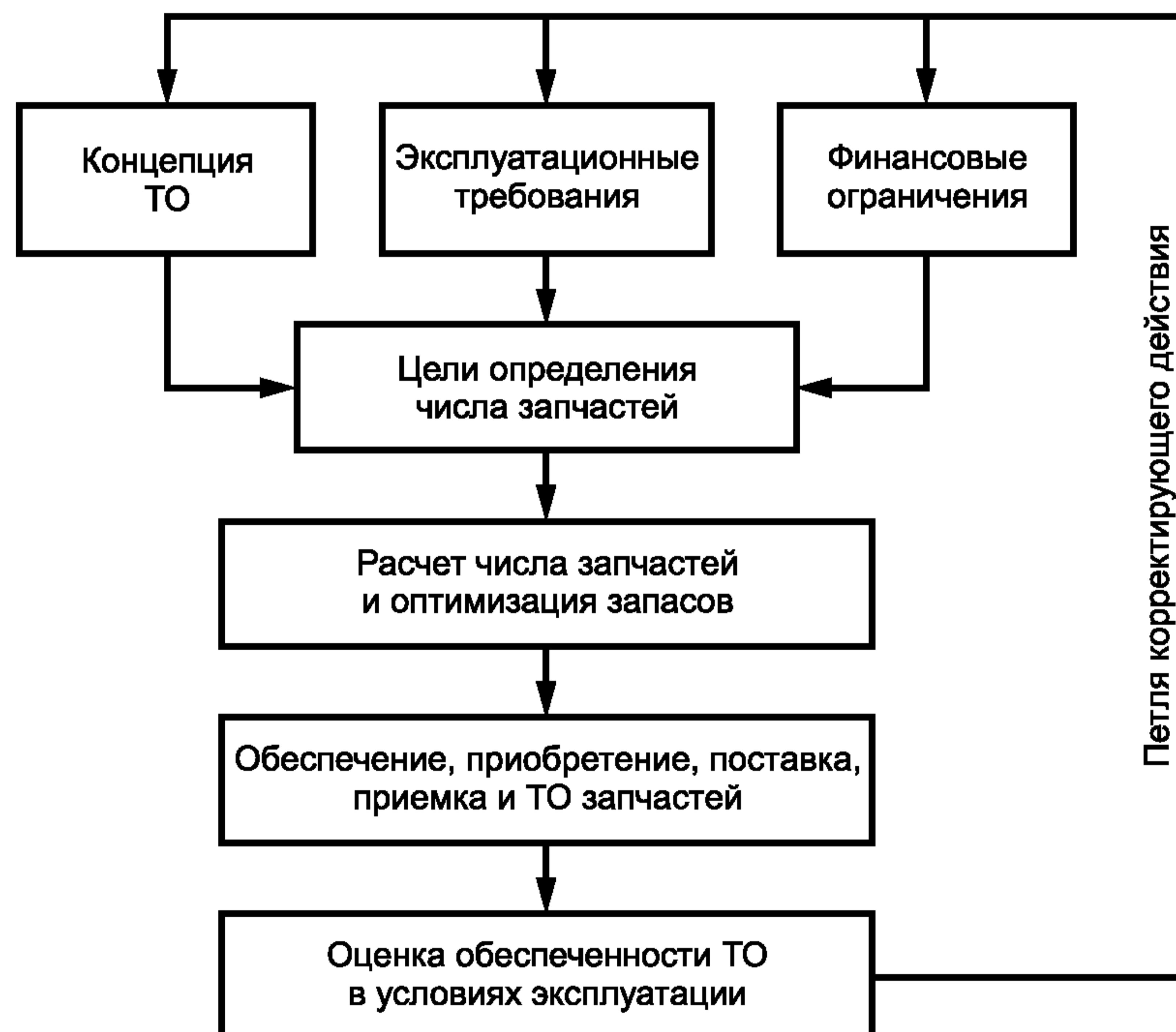
Рисунок 5 — Процесс обеспечения запчастями
