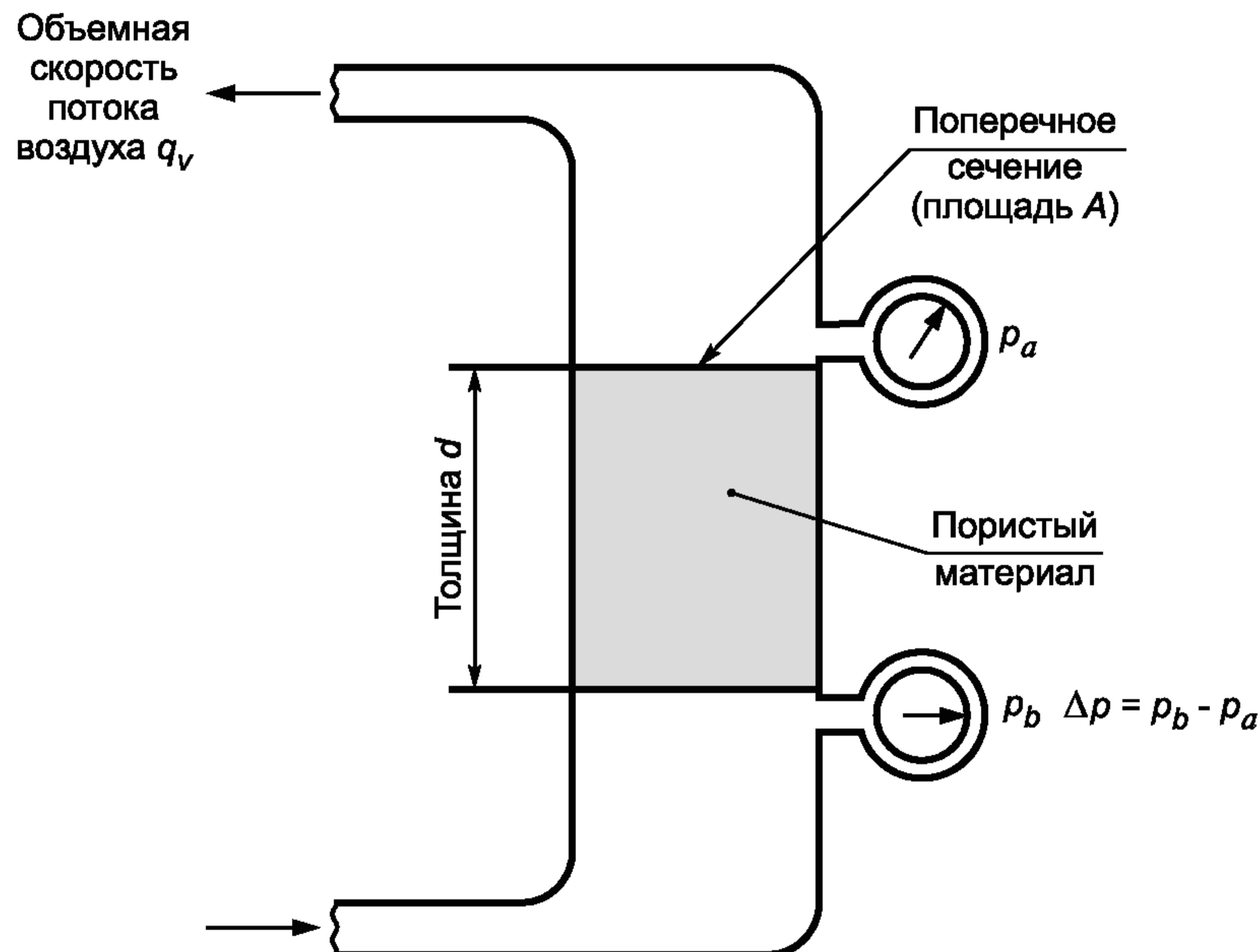
Рисунок 1 — Схема определения сопротивления продуванию постоянным потоком воздуха
