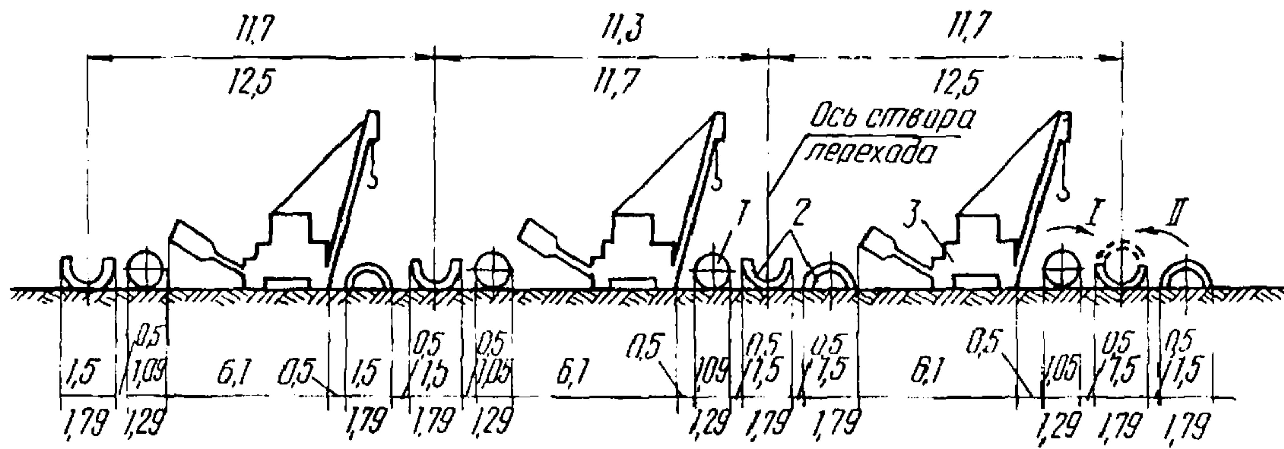
Рис.2. Схема раскладки плетей трубопровода диаметром 1020 и 1220 мм при монтаже на них утяжелителей типа УТК:
