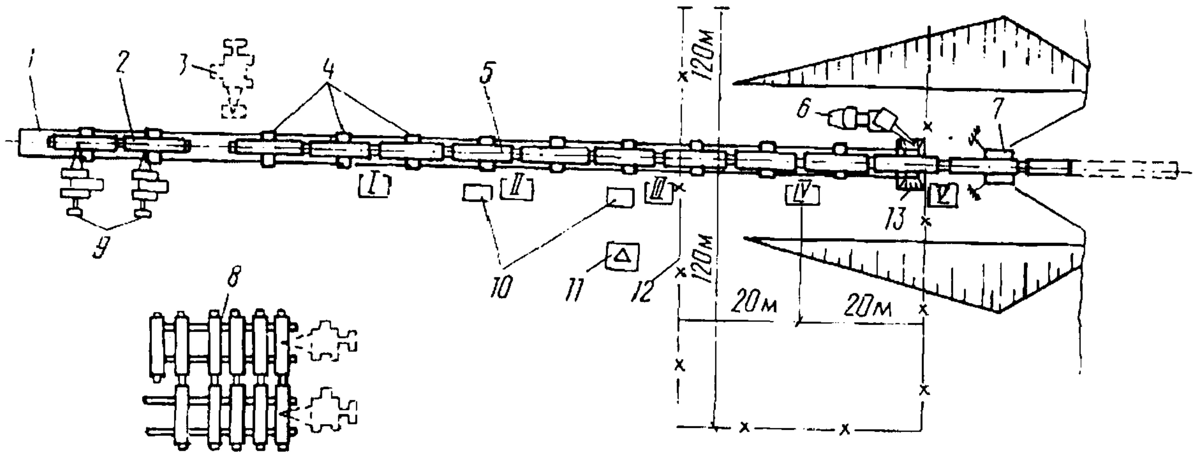
Лис.3. Схема укладки трубохода с поточно-расчененным методом монтажа плети в створе перехода из двухтрубных звеньев:
