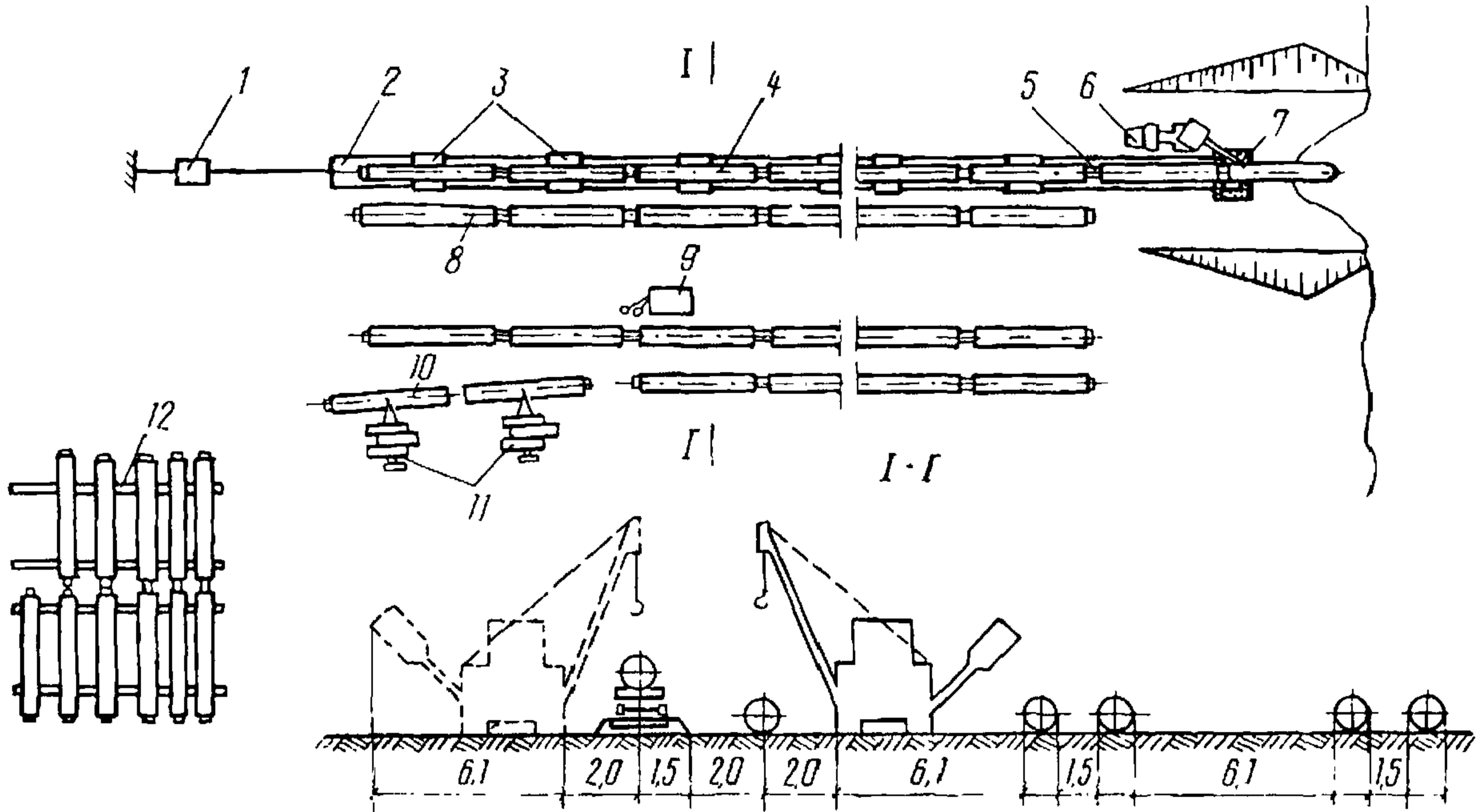
Рис.1. Схема укладки збетонированного трубоопровода методом последовательного протаскивания плетей:
