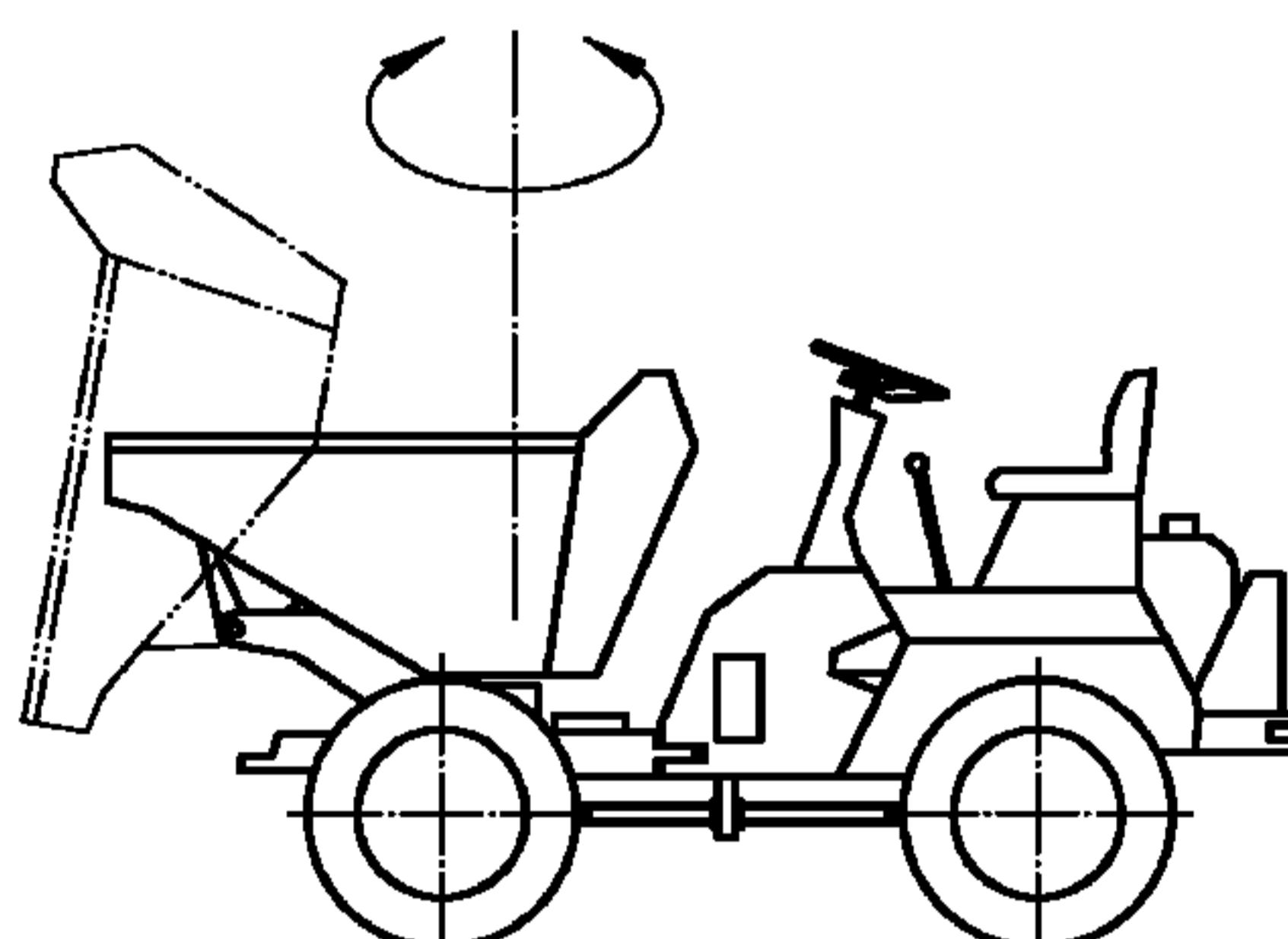
Рисунок 5 — Разгрузка с поворотом на две стороны
