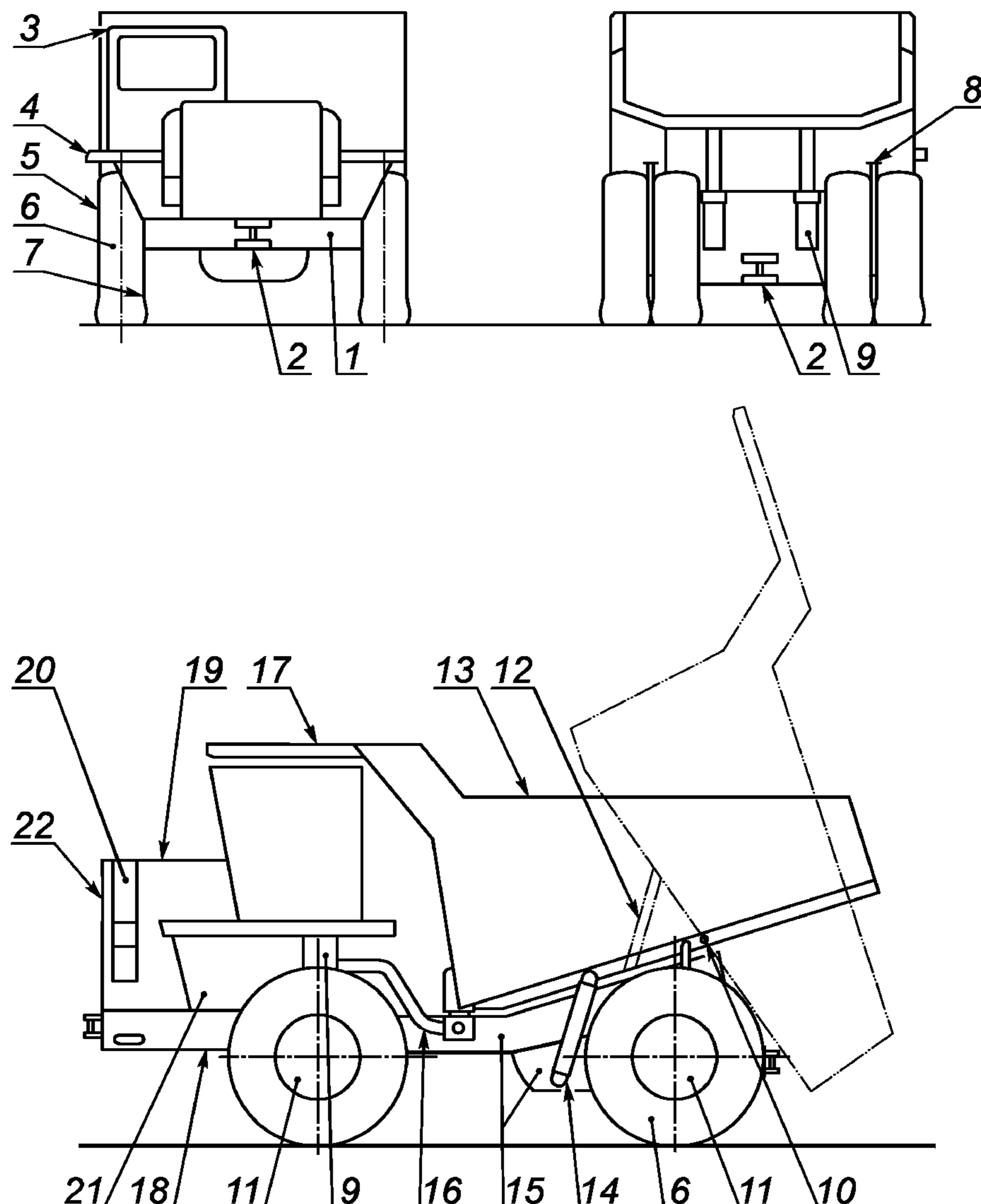
1 — бампер; 2 — цапфа буксирного устройства; 3 — кабина; 4 — предохранительная решетка; 5 — колесо; 6 — шина; 7 — тормоз; 8 — барабан, выталкиватель камней; 9 — подвеска (факультативно); 10 — палец, цапфа поворота кузова; 11 — ось (оси); 12 — опора, поднятый кузов; 13 — кузов; 14 — цилиндр разгрузки; 15 — система привода; 16 — выхлоп, атмосфера или прогрев кузова; 17 — козырек; 18 — основная рама; 19 — капот; 20 — трап; 21 — силовая установка; 22 — ограждающая решетка
