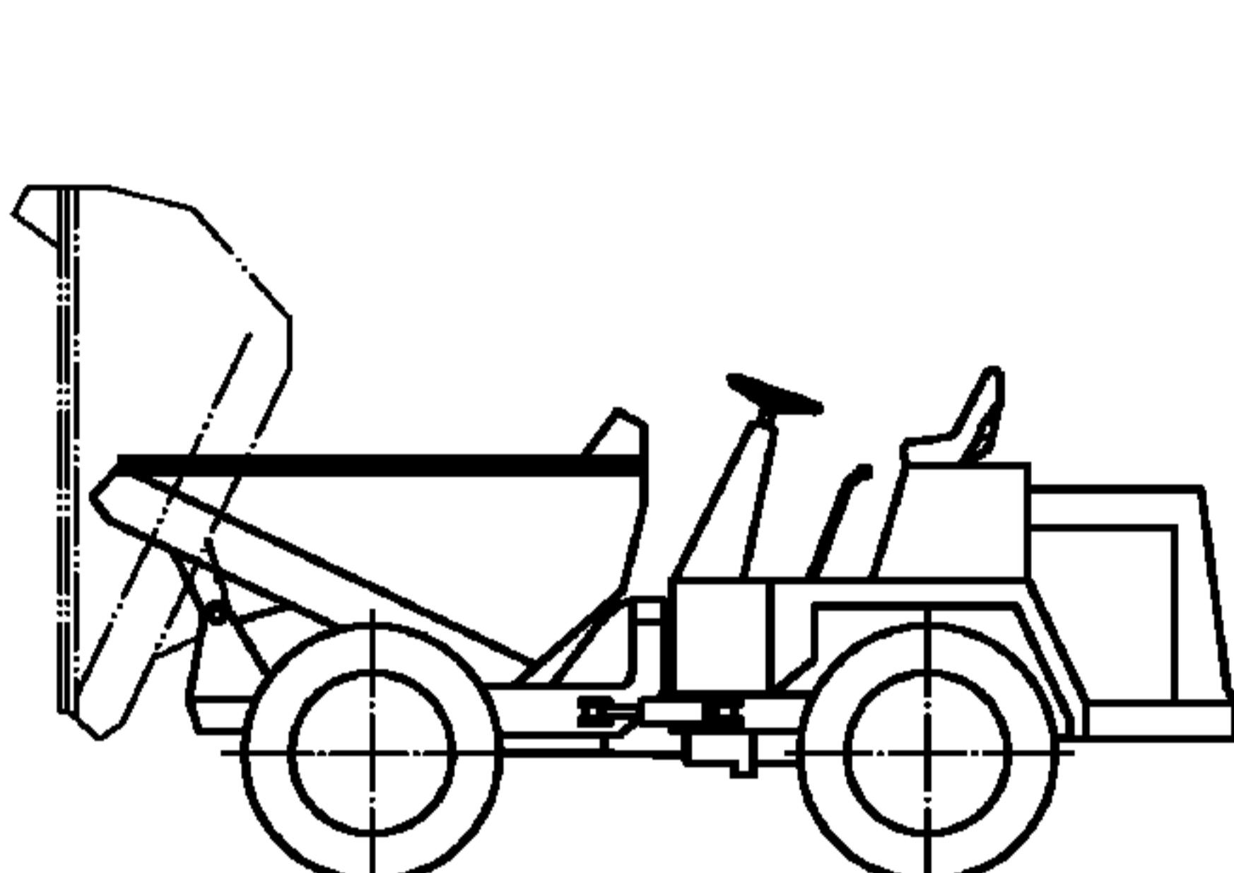
Рисунок 4 — Передняя разгрузка
