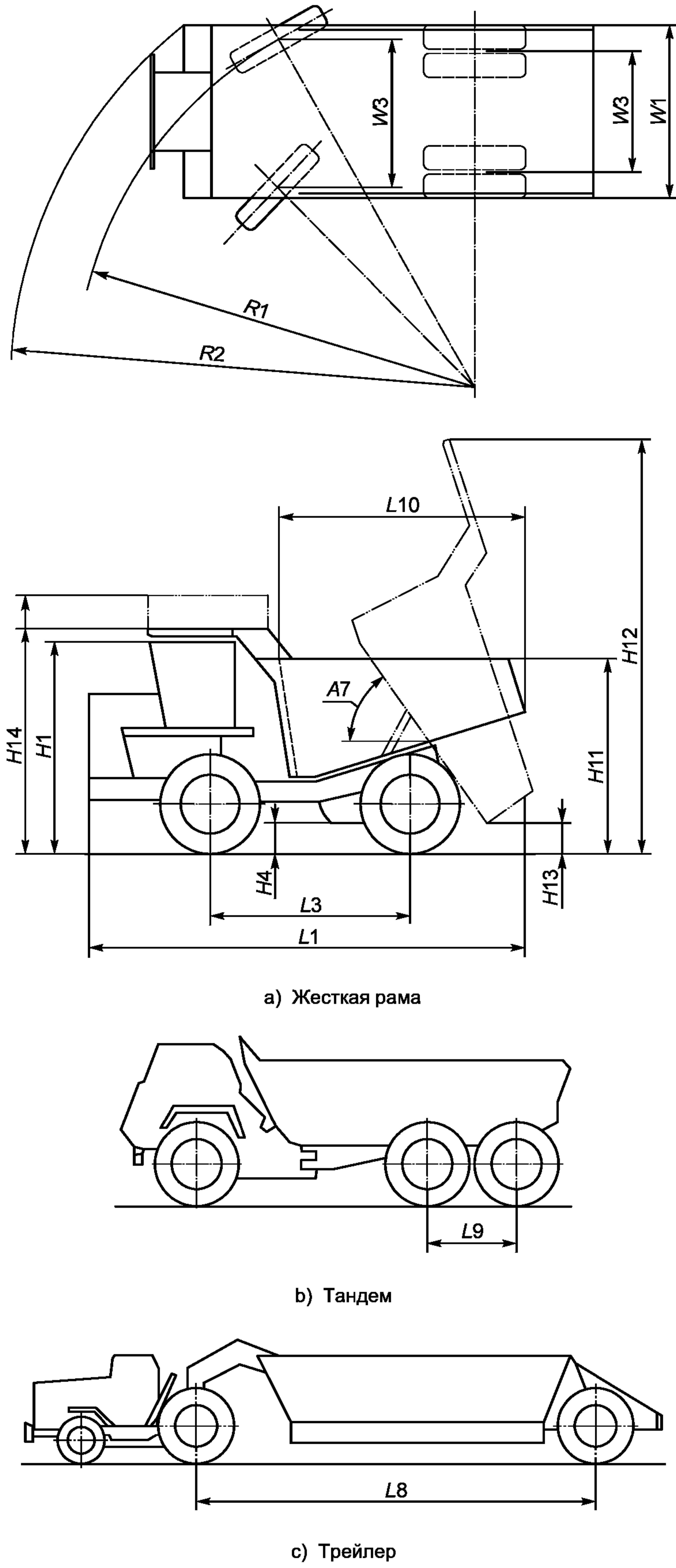
Рисунок 26 — Размеры базовой машины. Землевоз
