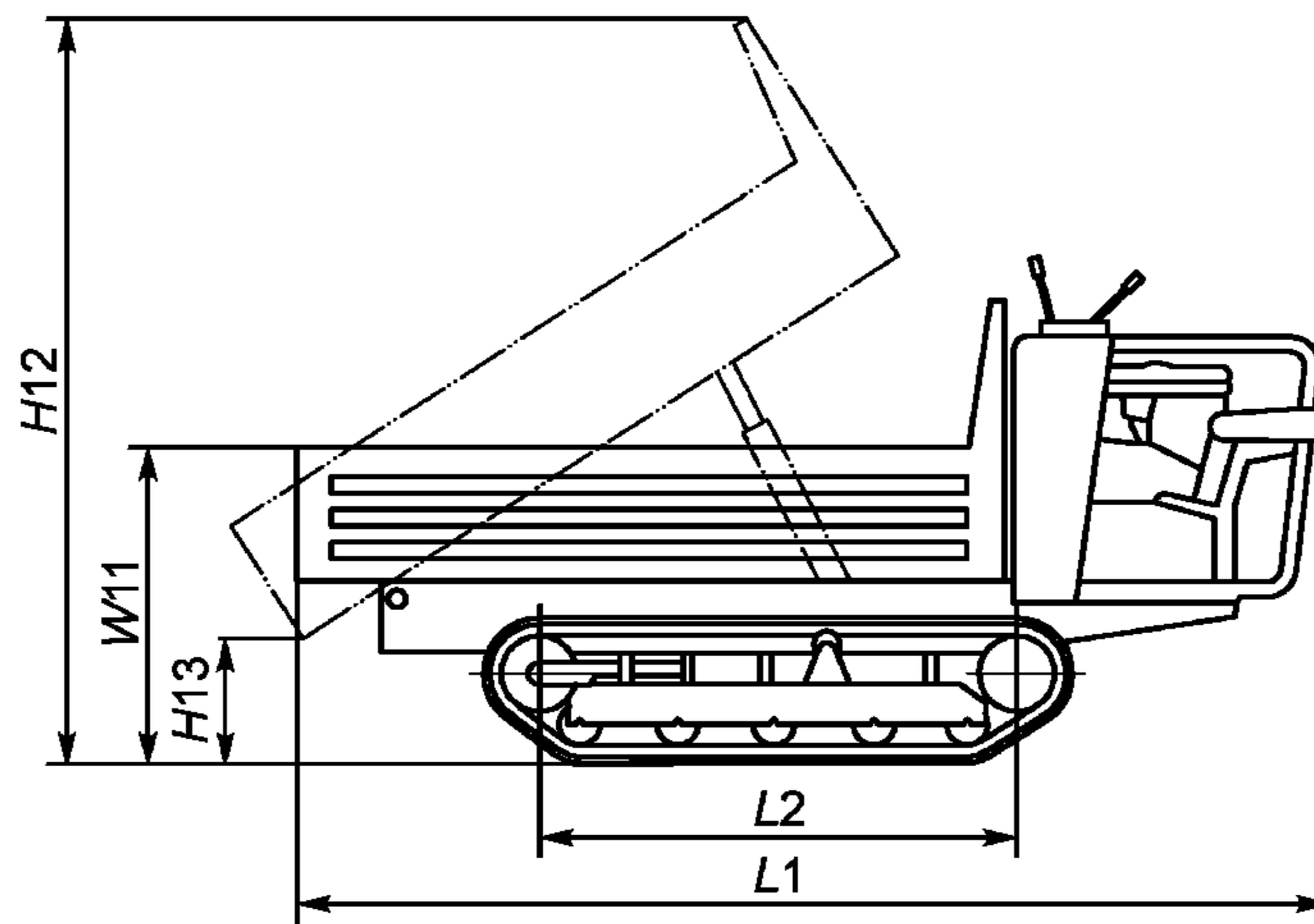
Рисунок 29 — Размеры гусеничного мини-землевоза. Сиденье сзади кузова
