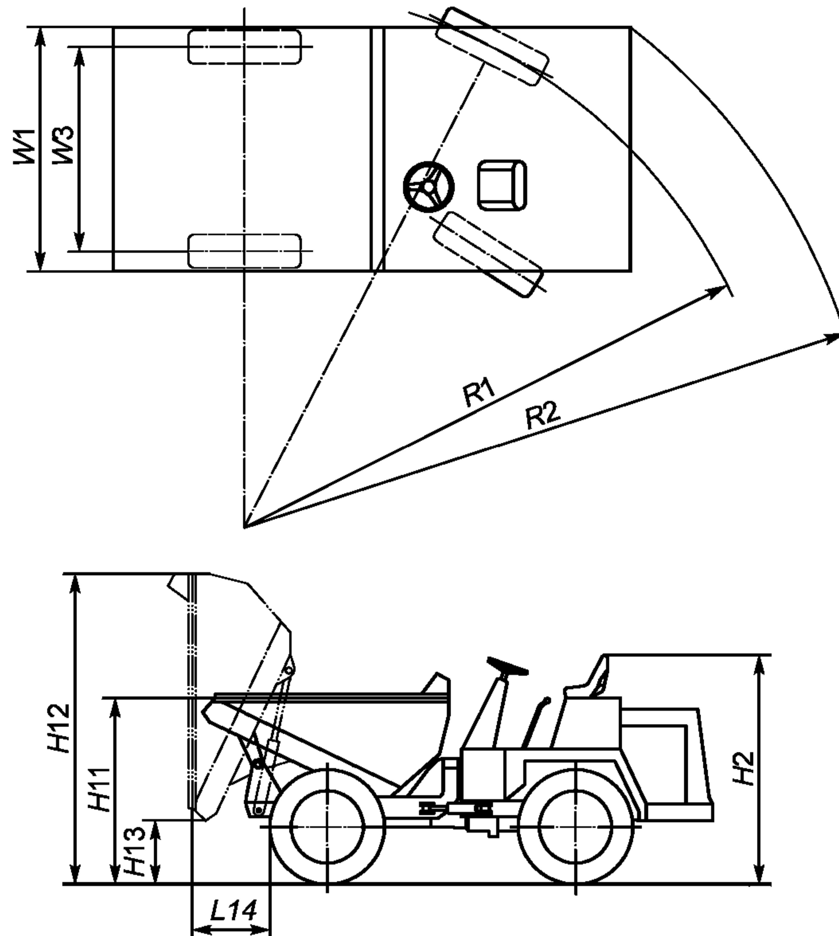
Рисунок 27 — Размеры четырехколесного мини-землевоза
