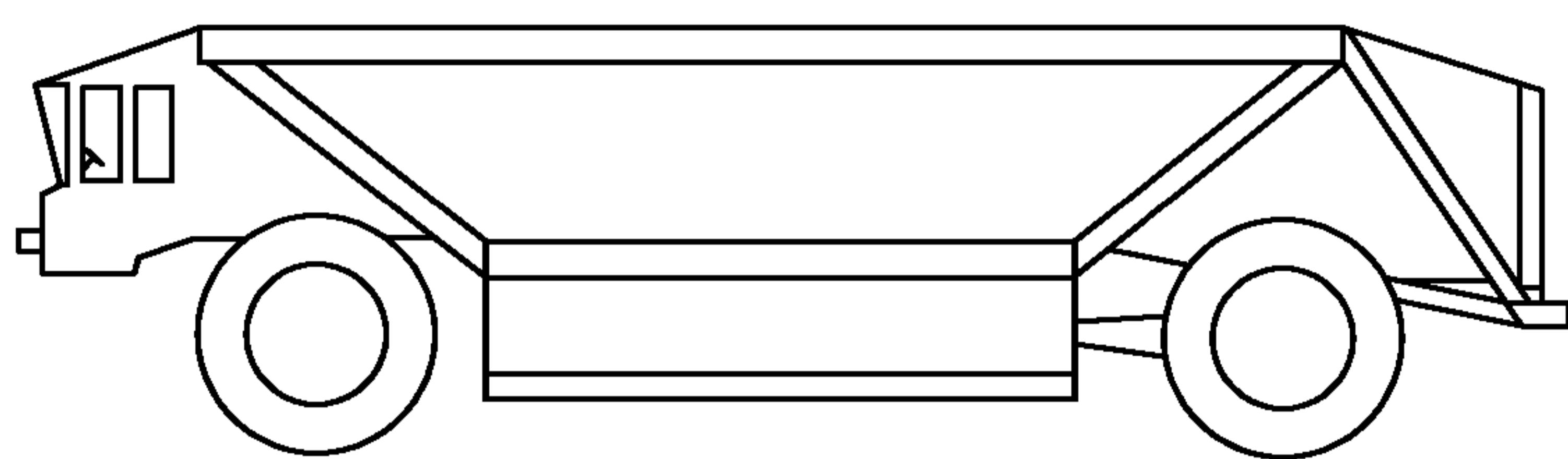
Рисунок 2 — Донная разгрузка
