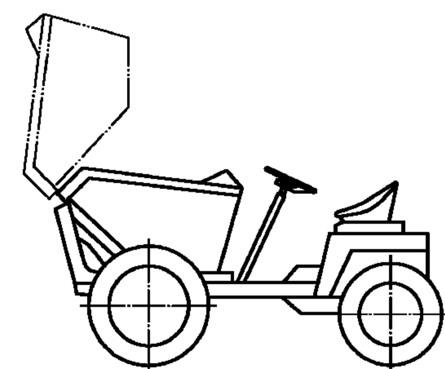
Рисунок 6 — Разгрузка на высоте
