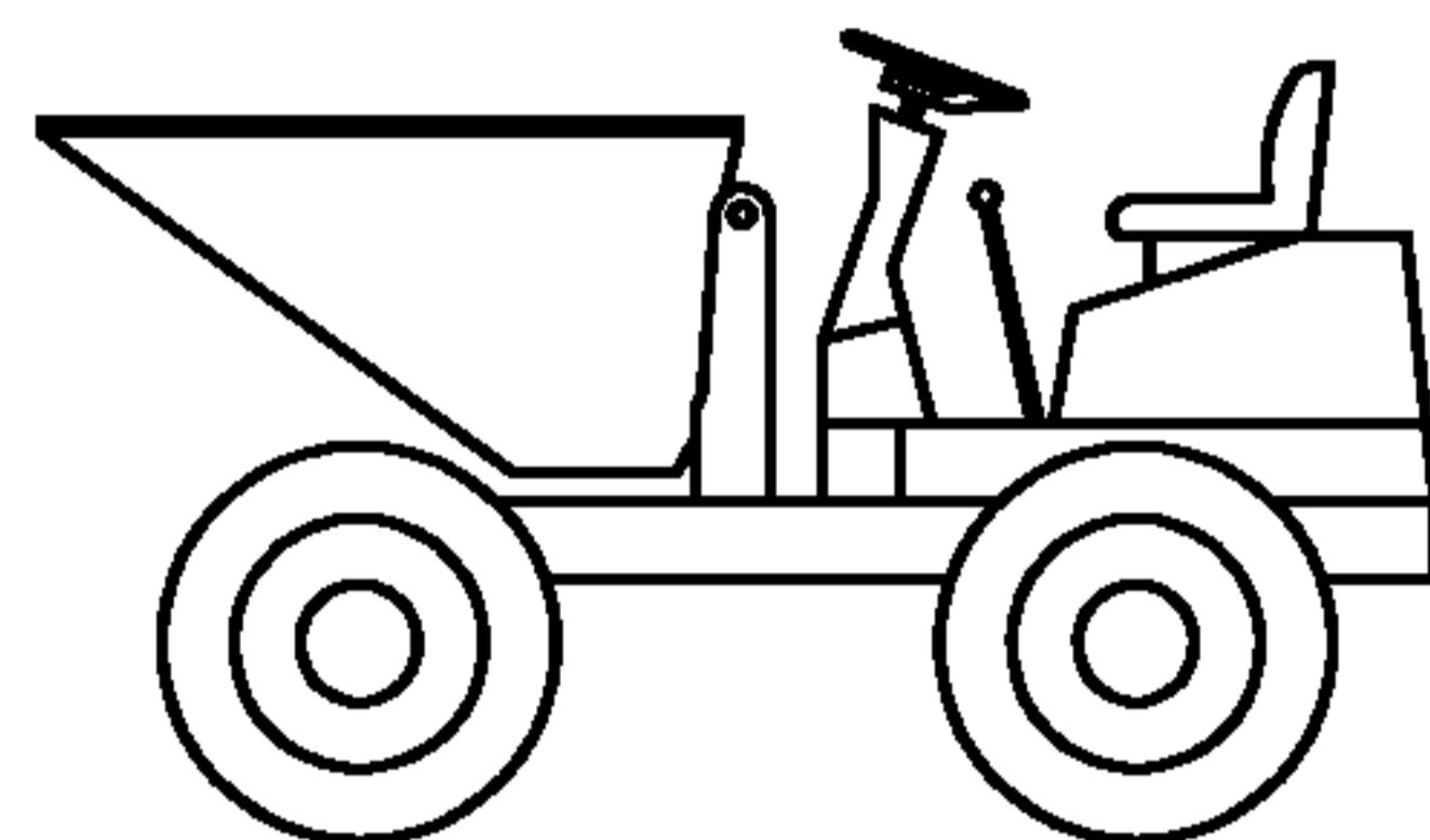
Рисунок 23 — Сиденье сзади кузова
