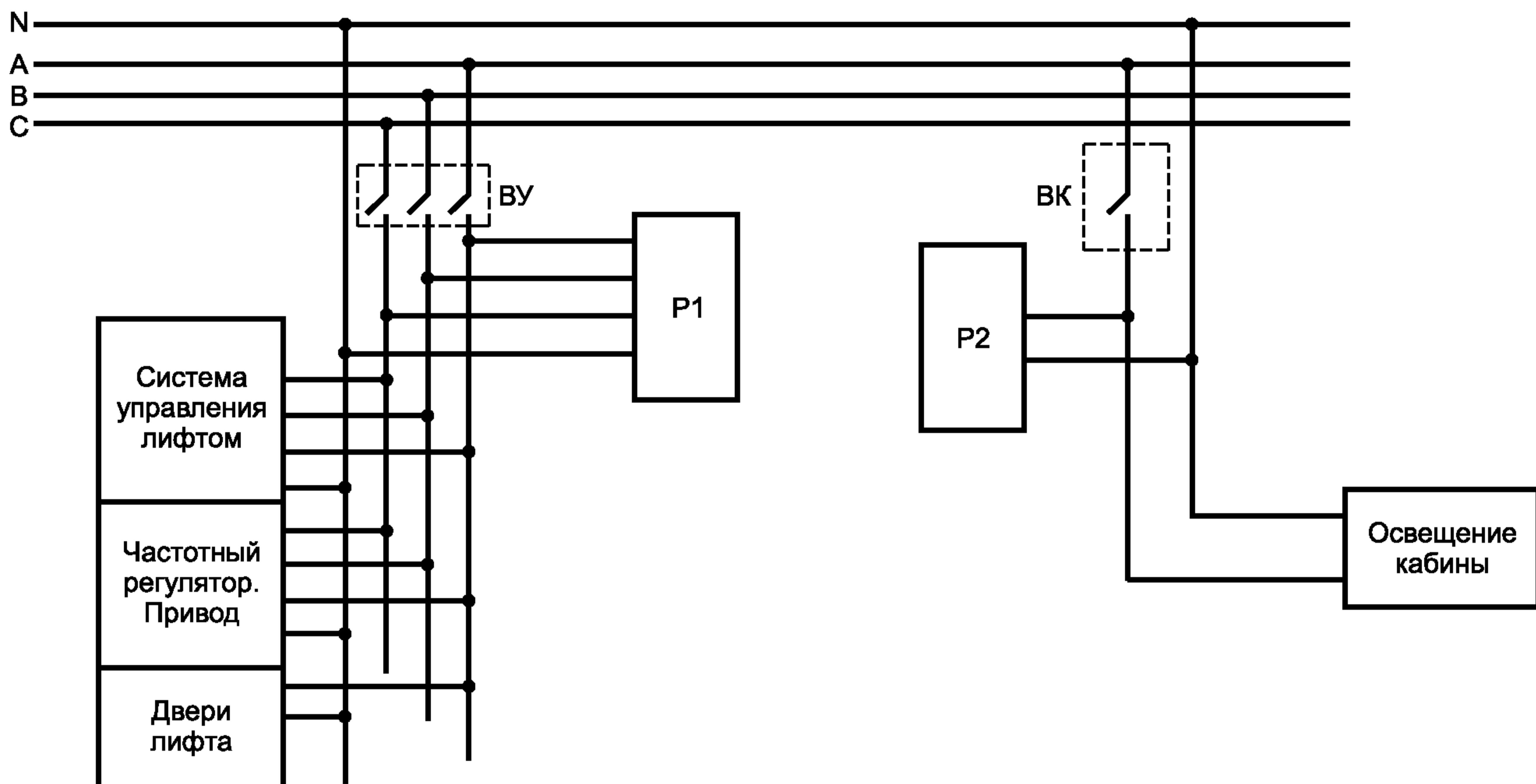
ВУ — вводное устройство; ВК — выключатель освещения; Р1 — прибор для измерения энергии и мощности в трехфазной сети; Р2 — прибор для измерения энергии и мощности в однофазной сети
