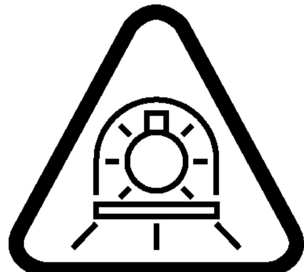
**A.2 Символ лампы с экранированием, указывающим, что лампа может работать в светильнике без защитного экрана**
