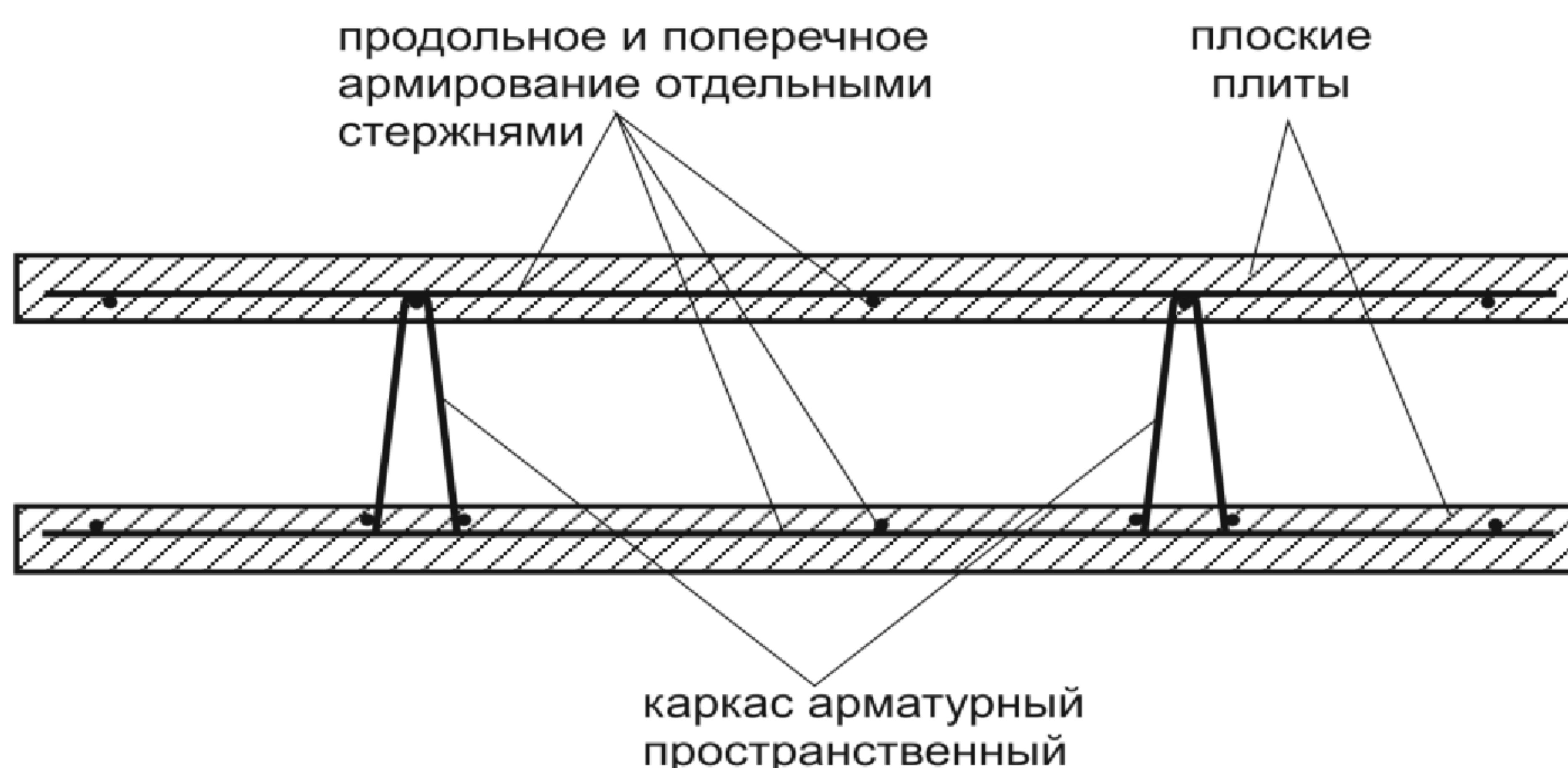
Рисунок 1 – Элемент несъемной опалубки стен
