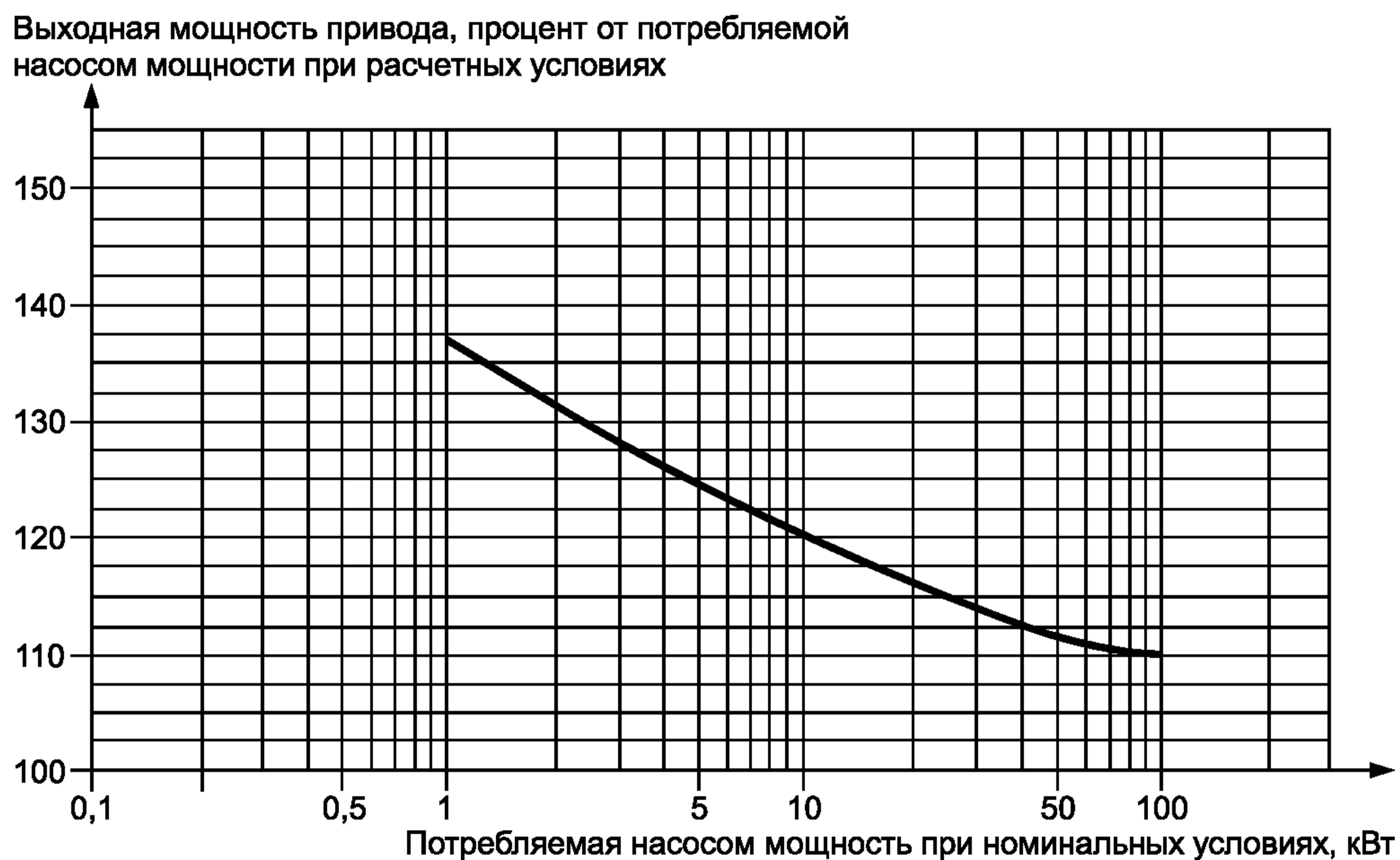
Рисунок 1 — Выходная мощность привода, пропорциональная потребляемой мощности насоса при номинальных условиях, требуемой в диапазоне от 1 до 100 кВт
