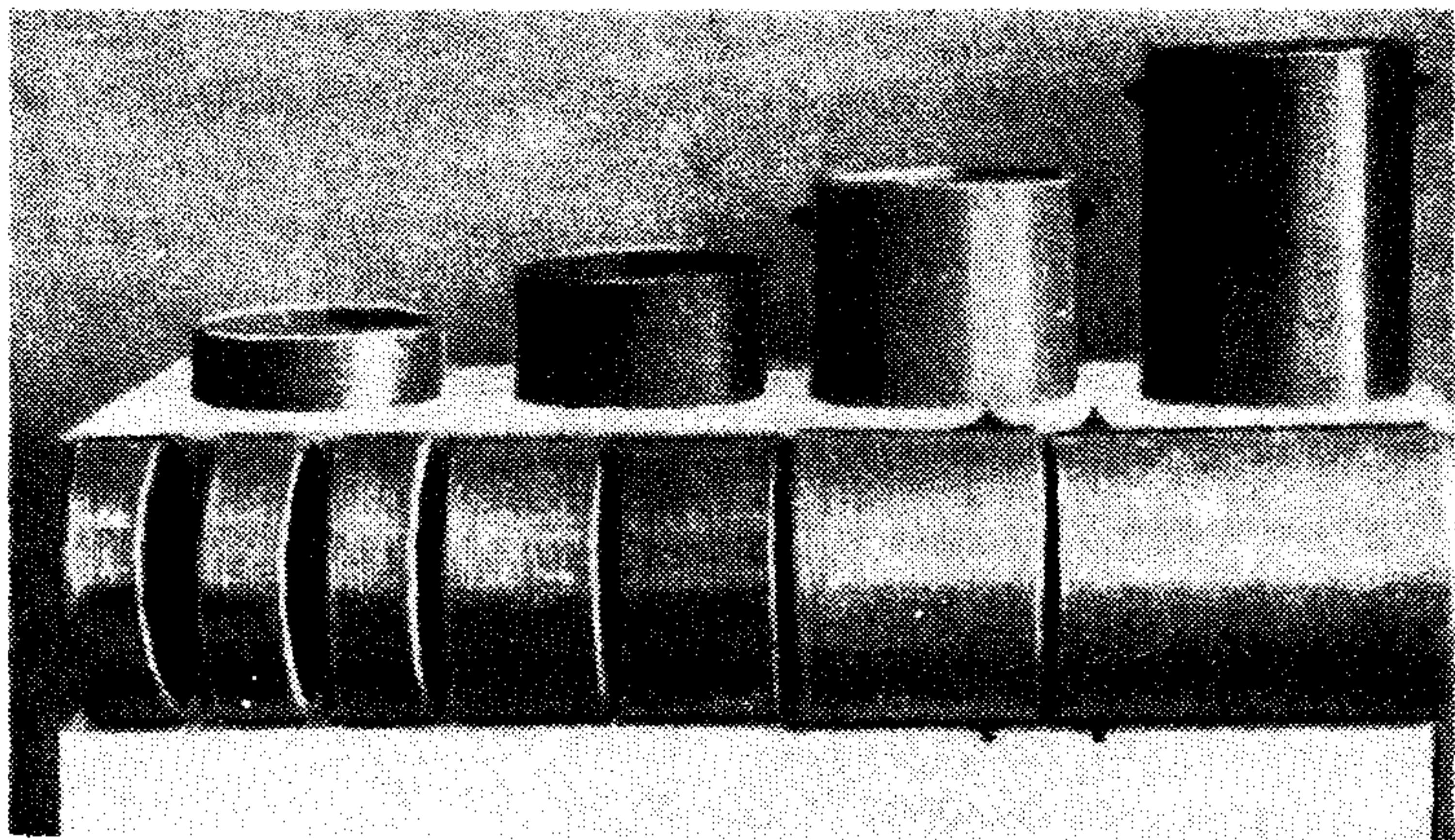
Рис.1. Общий вид обсйм для изготовления образцов, подлежащих испытаниям на водопроницаемость
