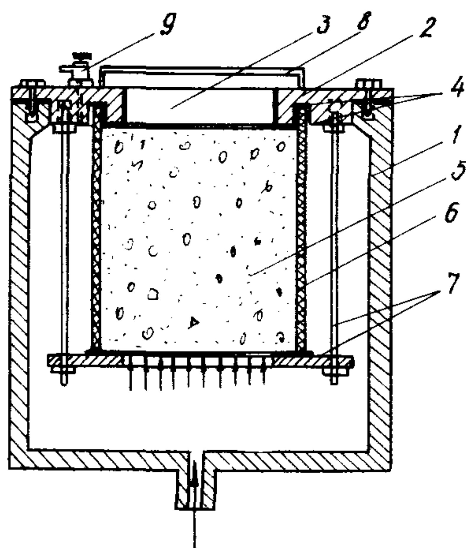
Рис.3. Схема испытательной гидравлической камеры.
