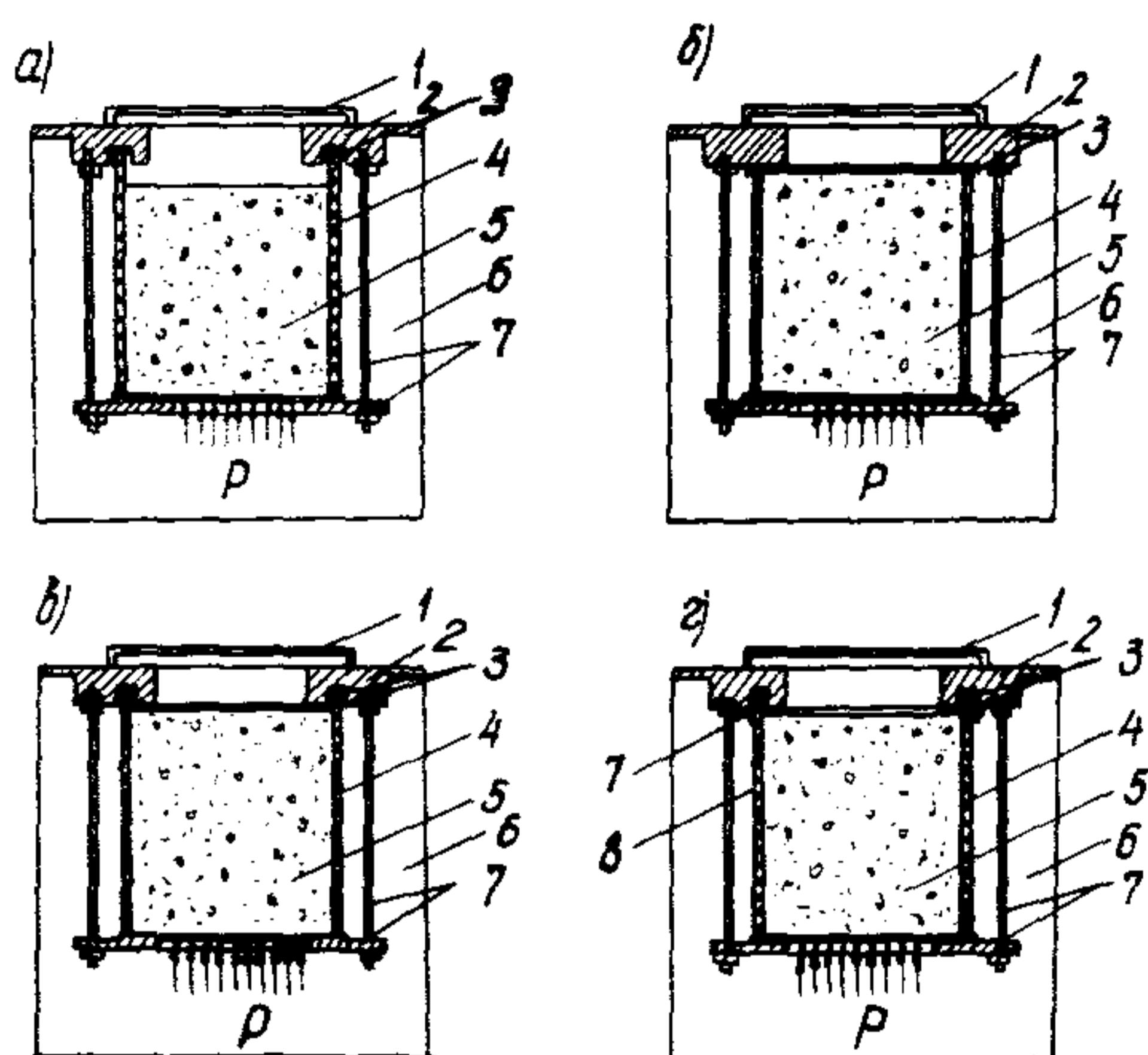
Рис.5. Способы крепления образцов в испытательной камере при давлениях: а - до 25 ати; б - до 100 ати; в - до 200 ати; г - до 250 ати.
