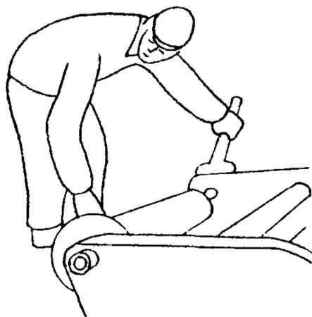
После перемотки рулона кровельщик  $K_2$ , нажав на рычаг отвода подвижной опоры приемного вала, снимает перемотанный рулон, вынимает вал, укладывает рулон в штабель и устанавливает приемный вал в станок
