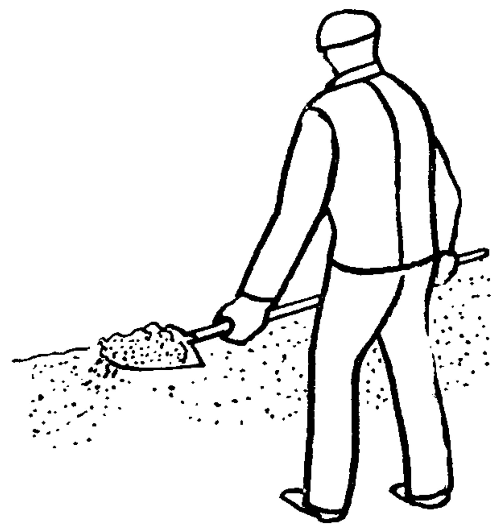
5 РАЗРАВНИВАНИЕ И ПРИКЛТКА ГРАВИЯ; К<sub>1</sub> - 28 мин; К<sub>4</sub> - 38 мин; К<sub>5</sub> - 51 мин; гребки, каток
