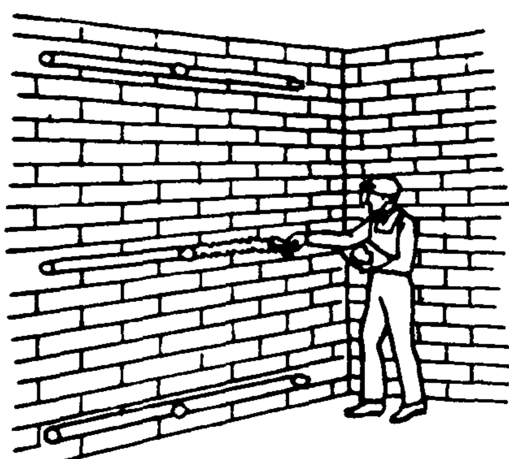
Штукатуры Ш<sub>1</sub> и Ш<sub>2</sub>, работая самостоятельно, наносят на стену между двумя смежными марками сплошную полосу гипсоопилочной мастики шириной 80–100 мм и выравнивают ее правилом до уровня установленных марок
