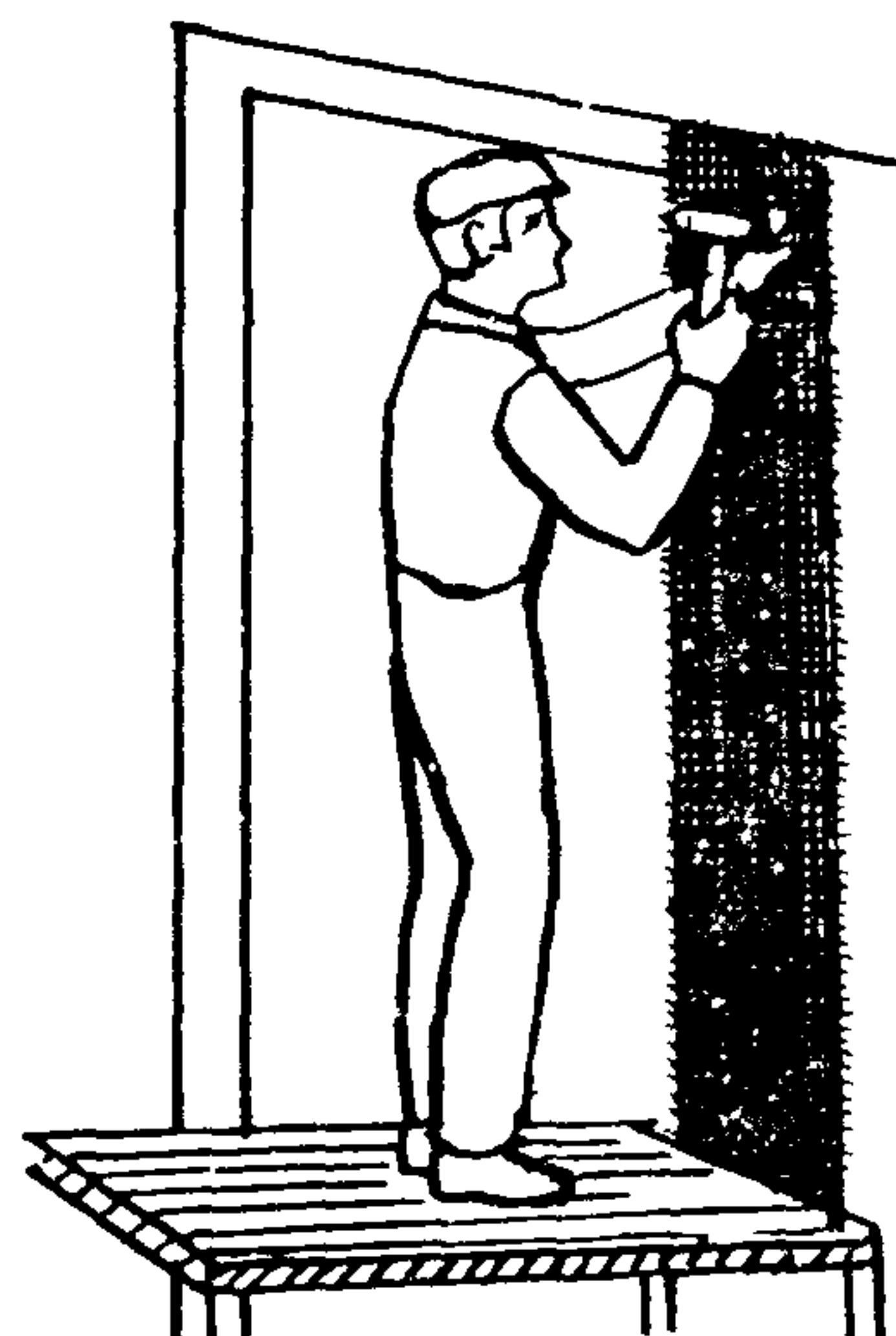
Проверив качество заделки зазора, штукатуры  $Ш_1$  и  $Ш_2$  гвоздями прибивают по всему периметру коробки заготовленные ранее полосы стальной сетки. Оштукатуривают заделанные места примыканий одновременно со всей поверхностью помещения
