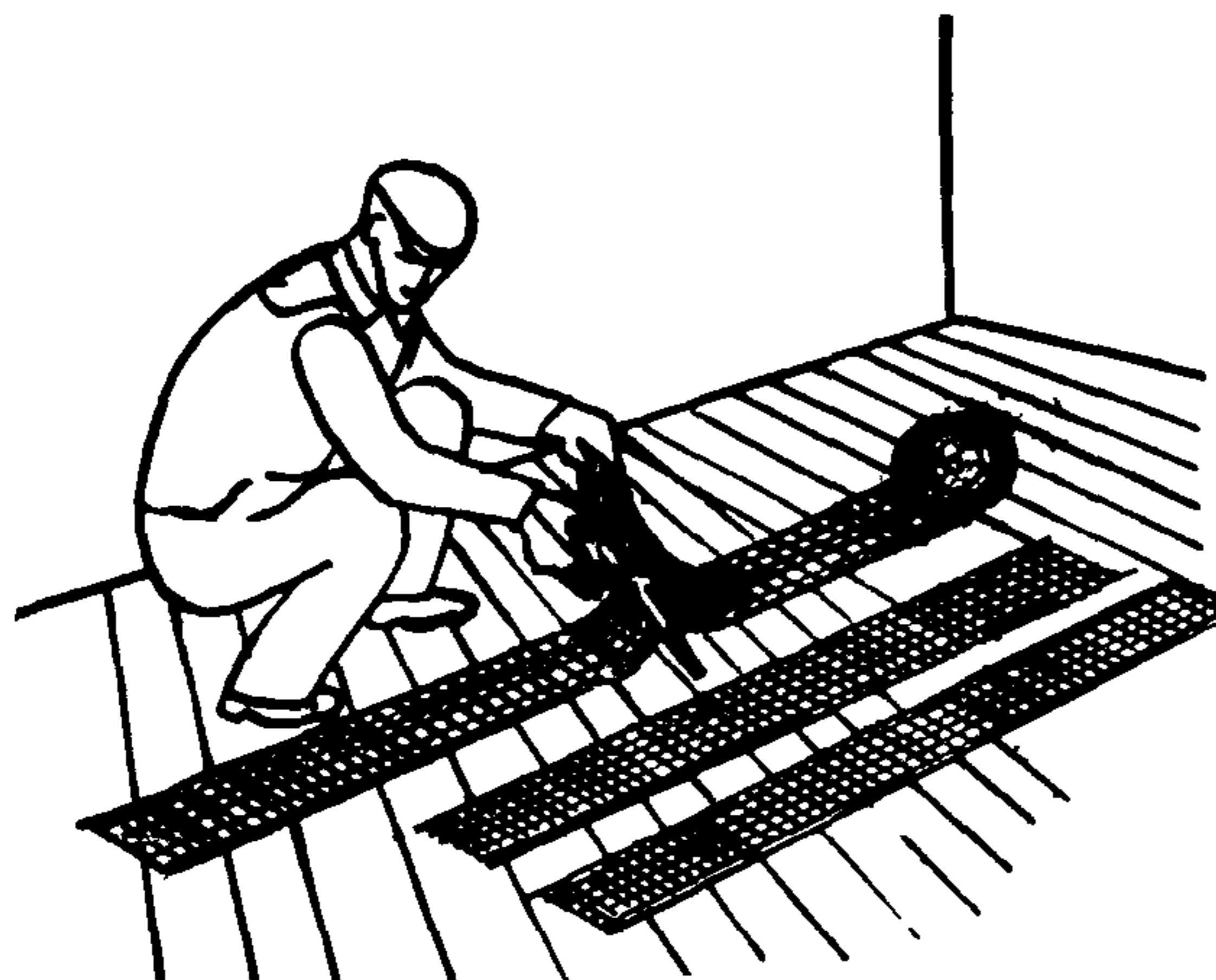
Штукатур Ш<sub>1</sub> раскатывает рулон сетки и, отмерив полосы шириной 15 см, отрезает их ножницами. Затем скатывает каждую полосу в рулон и подносит рулоны к месту работы
