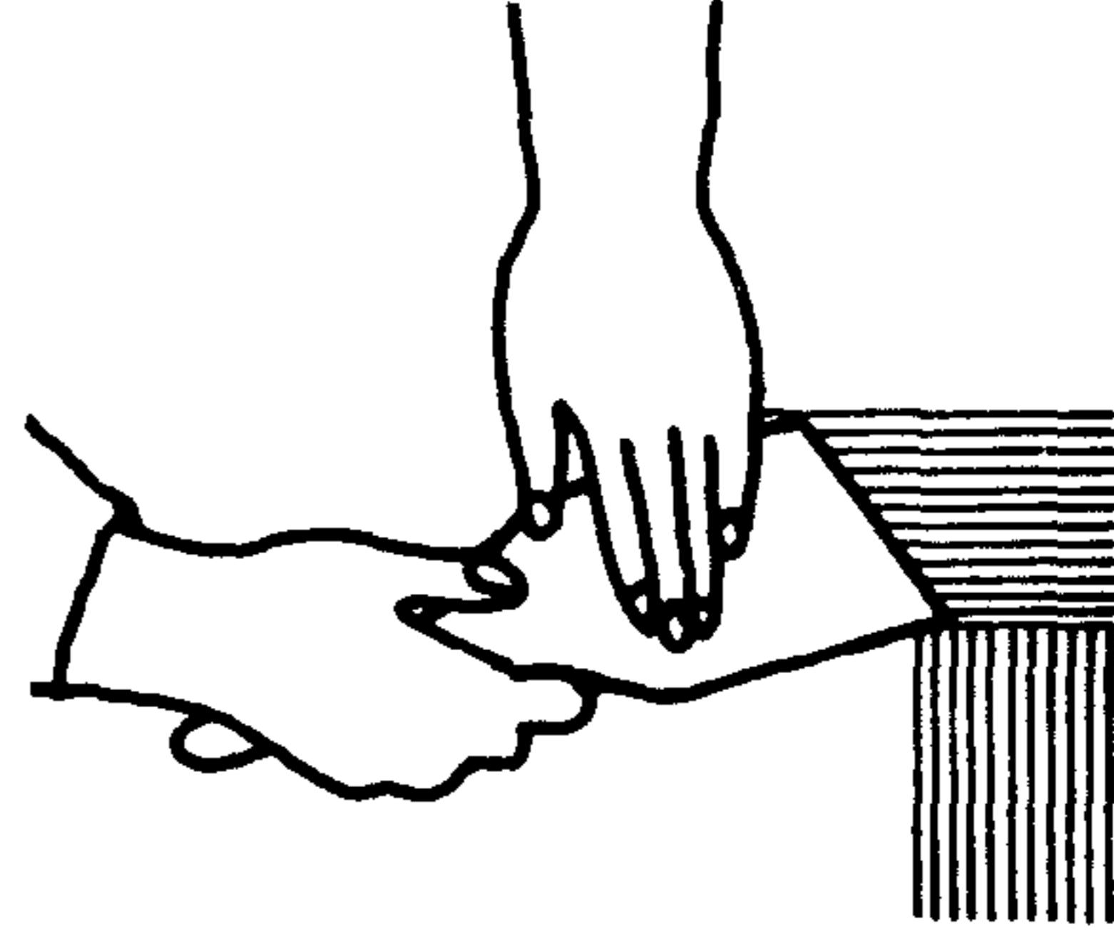
**2 НАНЕСЕНИЕ ВТОРОГО СЛОЯ ШПАКЛЕВКИ ПО ПЕРВОМУ СЛОЮ; 348 мин; шпатели, ящик со шпаклевкой**
