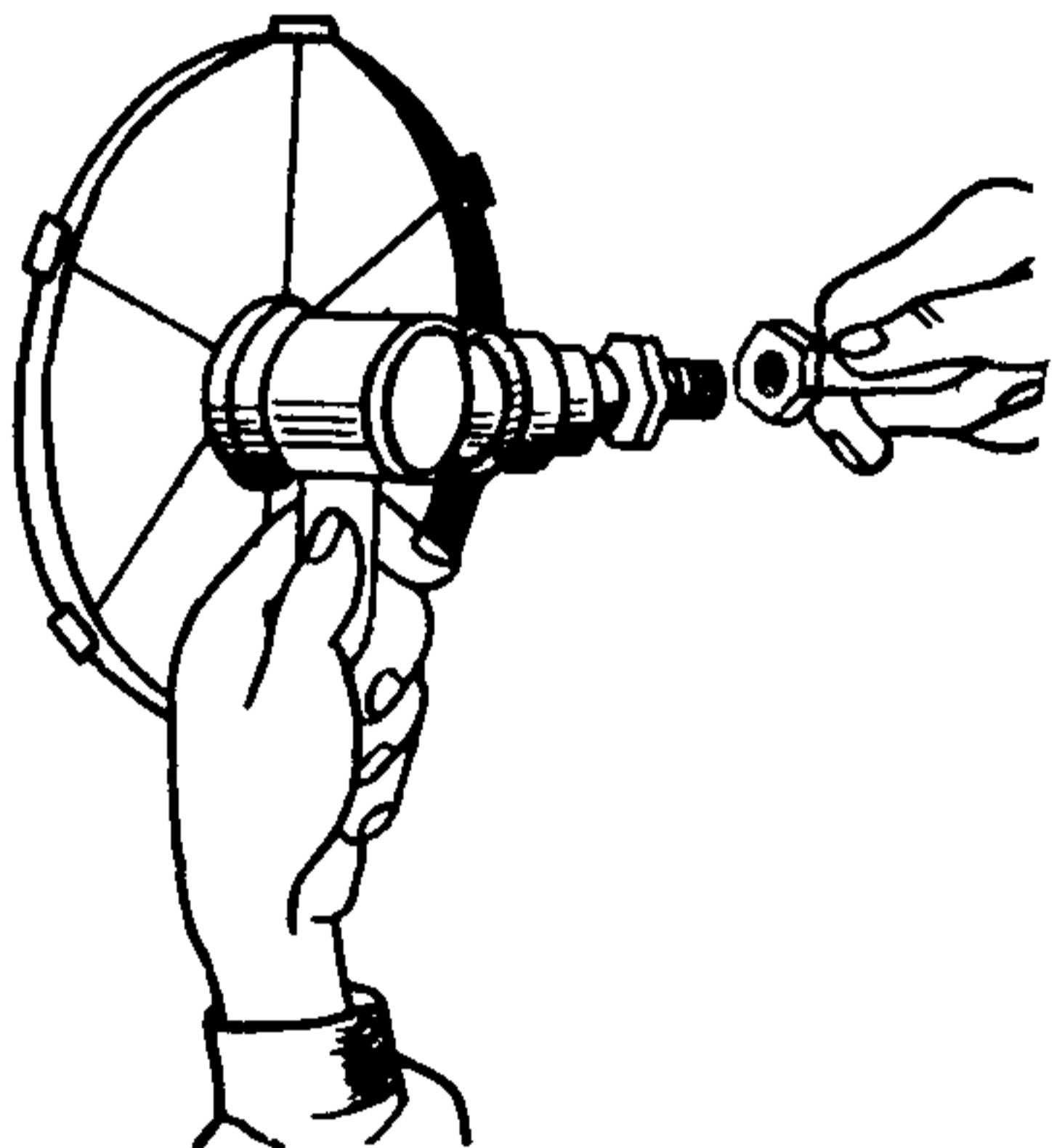
Маляры подключают затирочные машины к воздухопроводам компрессоров. Каждый маляр, держа машину левой рукой за рукоятку, правой навинчивает накидную гайку на штуцер, после чего гаечным ключом довертыивает ее до отказа. Маляр  $M_1$  работает со столика, а маляр  $M_2$  — с пола.
