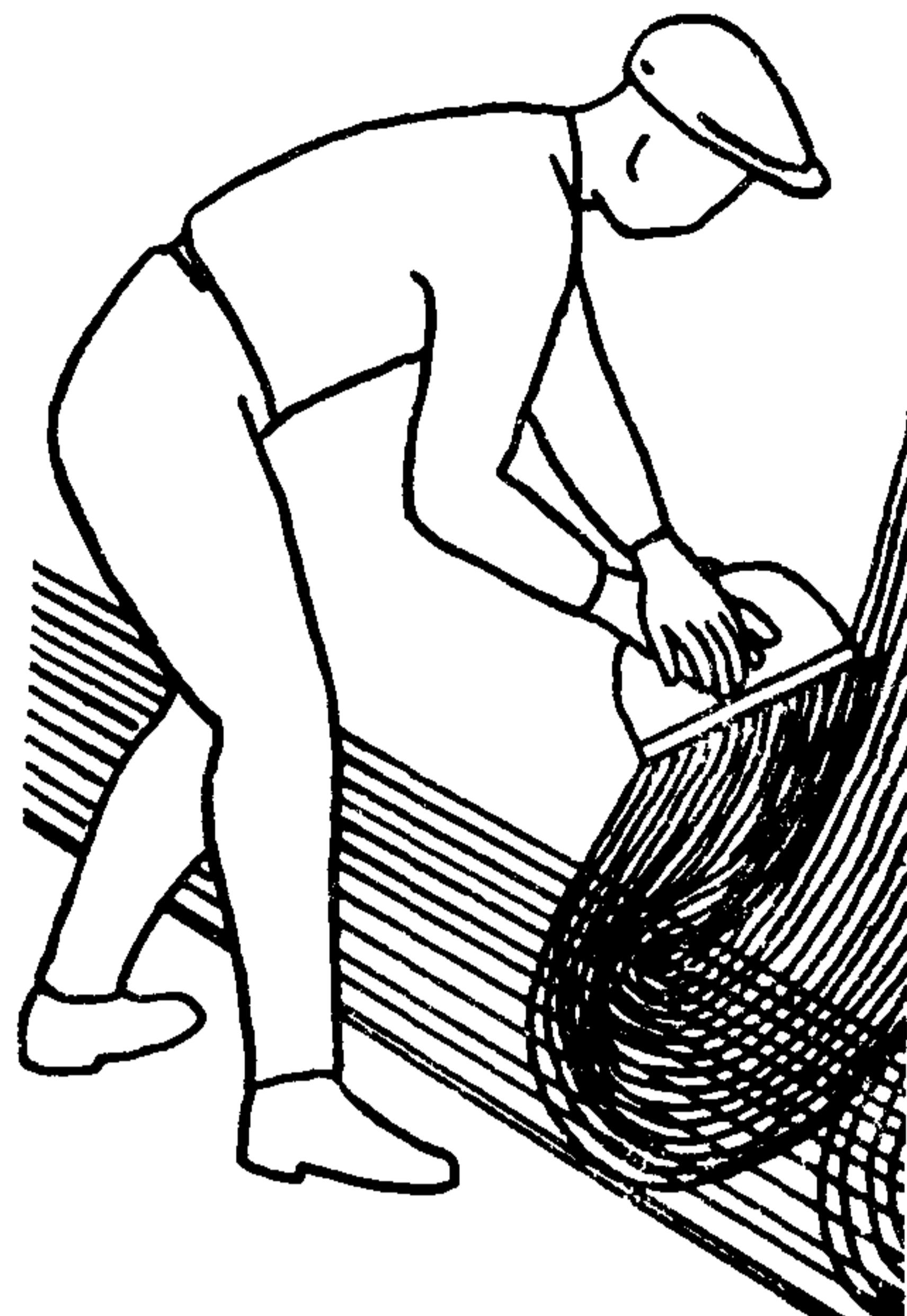
2 СПЛОШНАЯ ШЛИФОВКА СТЕН; 78 мин;  $M_1$ ,  $M_2$ ; пневматические затирочные машины, компрессоры, столик-подмости
