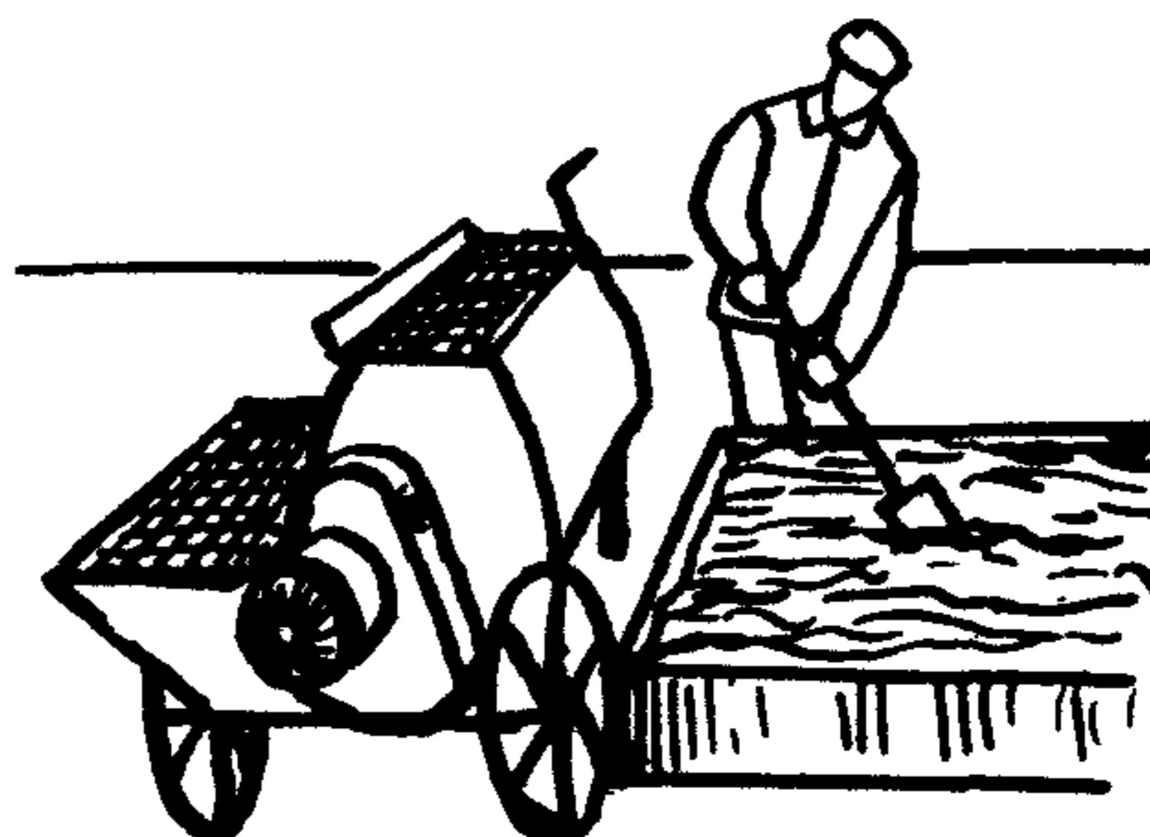
Бетонщики  $B_5$  и  $B_6$ , стоя с двух сторон приемного ящика, загружают лопатами раствор в растворомешалку
