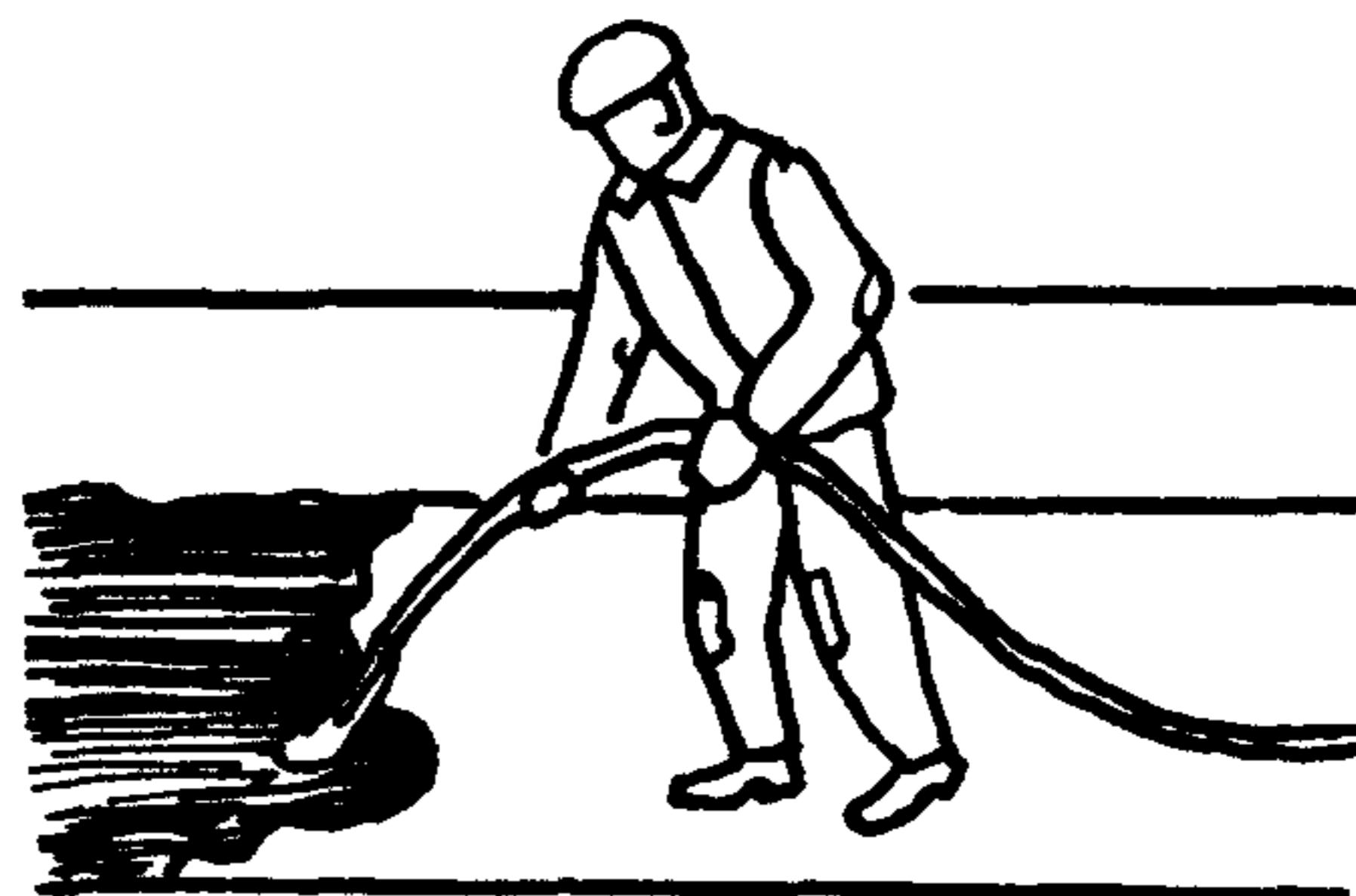
Бетонщик  $B_4$ , поддерживая левой рукой шланг снизу, правой держит его у выходного отверстия и наносит на основание раствор параллельными полосами шириной 30–40 см. Бетонщик  $B_3$  переносит шланги
