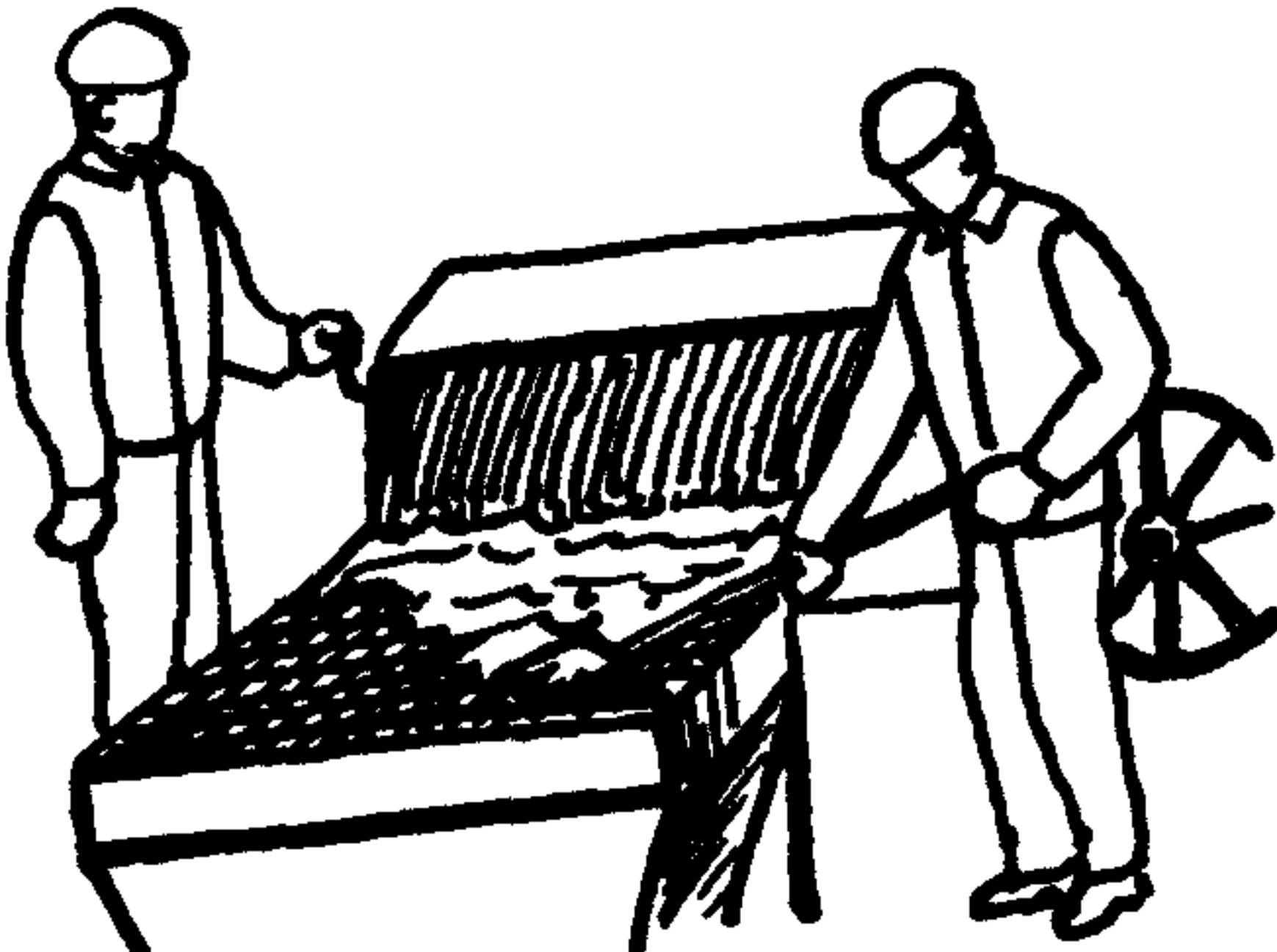
Машинист М включает вибросито и, поворачивая рычагом барабан растворомешалки, выгружает раствор на вибросито. Затем он возвращает барабан в исходное положение. Бетонщик Б<sub>5</sub> в это время лопатой сгребает отходы раствора, оставшиеся на сетке вибросита
