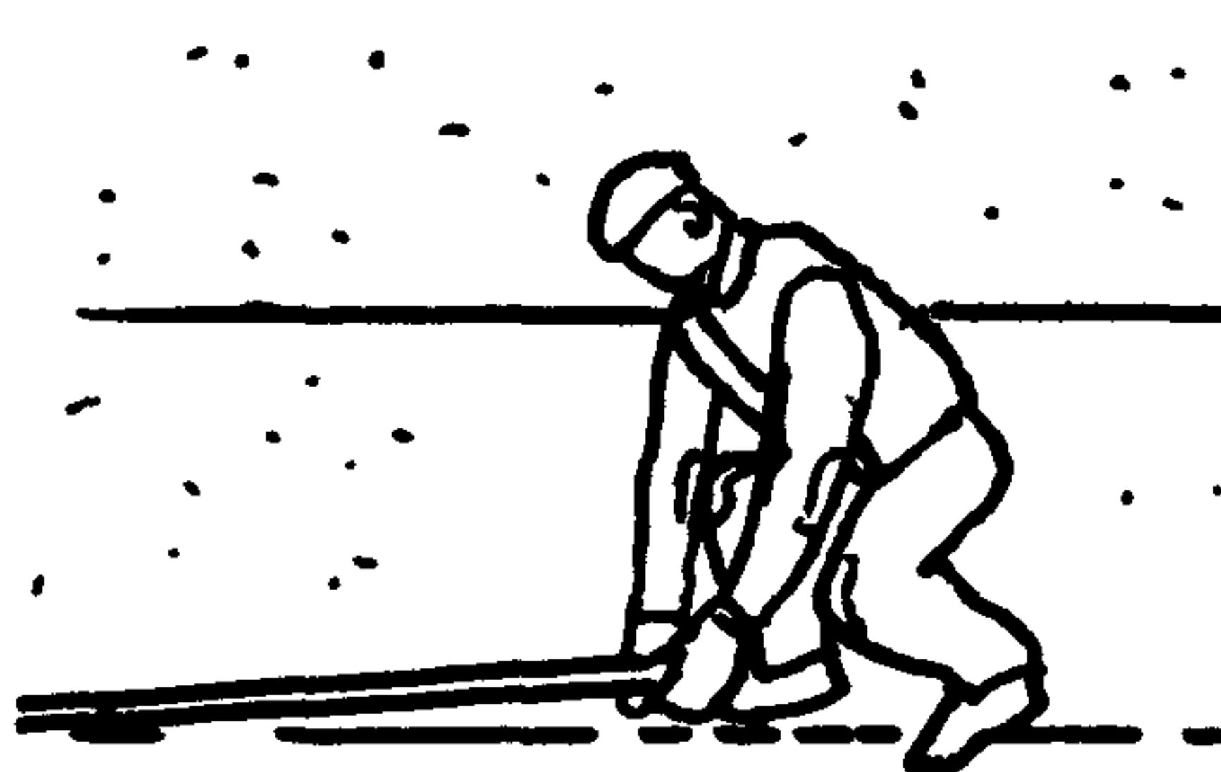
Бетонщики Б<sub>1</sub> и Б<sub>2</sub> берут концы реек, утопленных в растворе и поднимают их вверх, после чего относят к новому месту укладки
