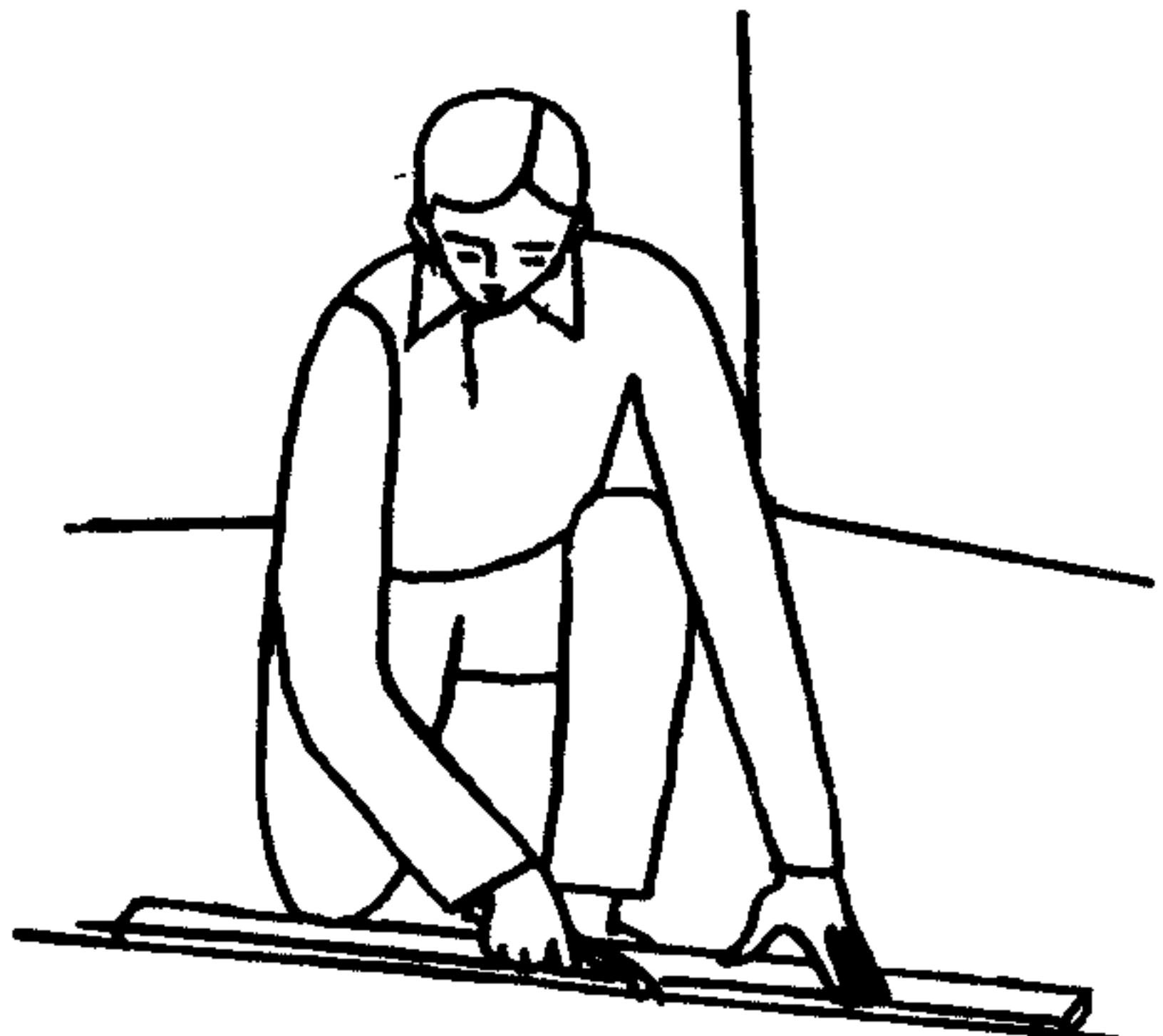
Облицовщики подкладывают под стык полотнищ линолеума ленты из кровельной стали, а сверху кладут линейку. Плотно прижимая линейку к линолеуму, они прорезают оба полотнища одновременно
