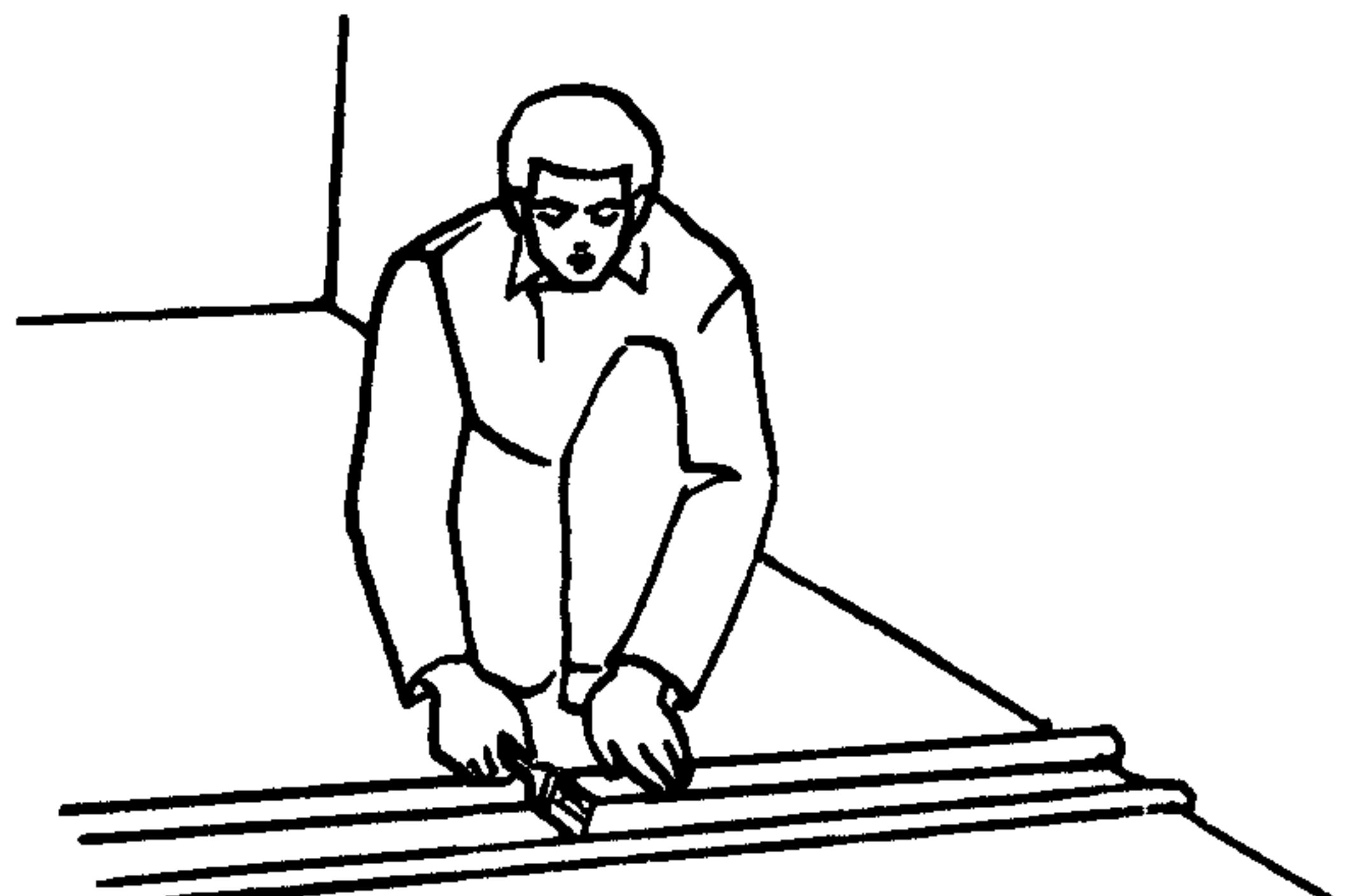
Облицовщики отгибают кромки полотнищ, кистью наносят на основание клей, а затем плотно прижимают кромки к намазанному основанию
