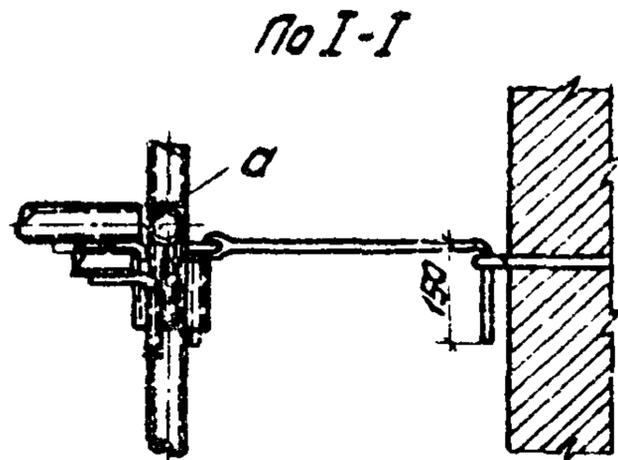
Анкеры Л-13 закладывают в возводимую стену, когда уровень кладки достигнет отметки верхних патрубков стойки. В этот момент в патрубках устанавливают крюк Л-11 или Л-12, на него надевают анкер Л-13 и укладывают в шов, после чего кладку продолжают.
