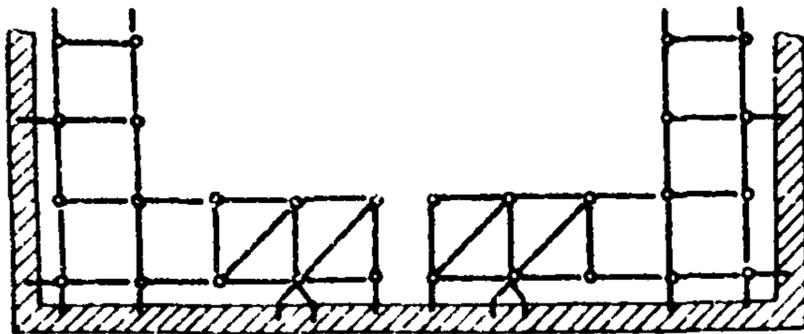
Выбор схемы зависит от очертания здания в плане. Оси стоек лесов разбивают, начиная от угла здания. Расстояние между стойками менее 2 м допускается только в случае особой необходимости. Расположение щитов настила для приведенных здесь схем показано на листе 4.
