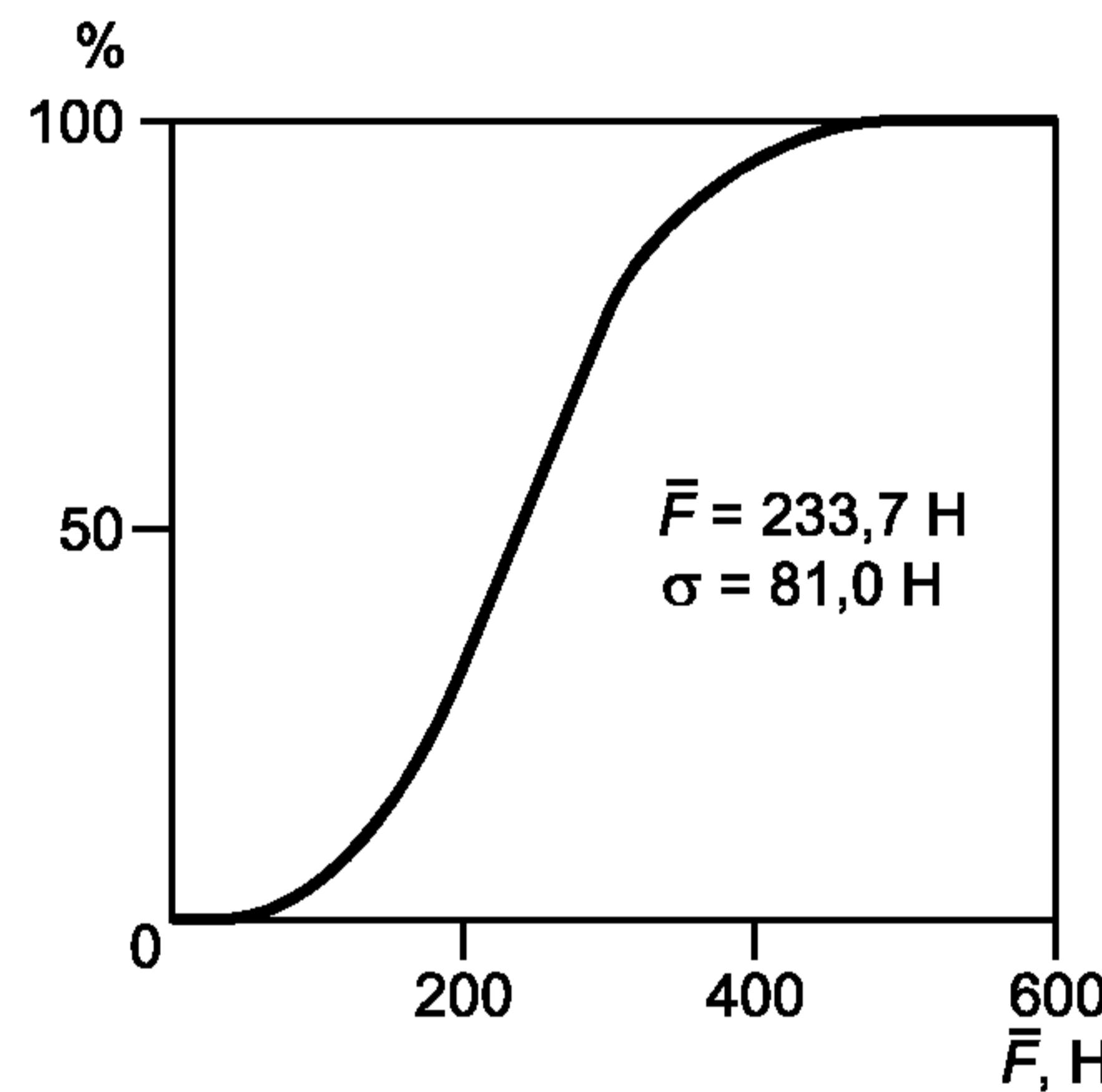
Рисунок А.1 — Пример параметров распределения усилий
