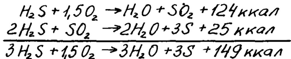
В качестве катализатора применяется боксит или глинозем. Выход серы в процессе достигает 95+98%. На расход катализатора влияют:
