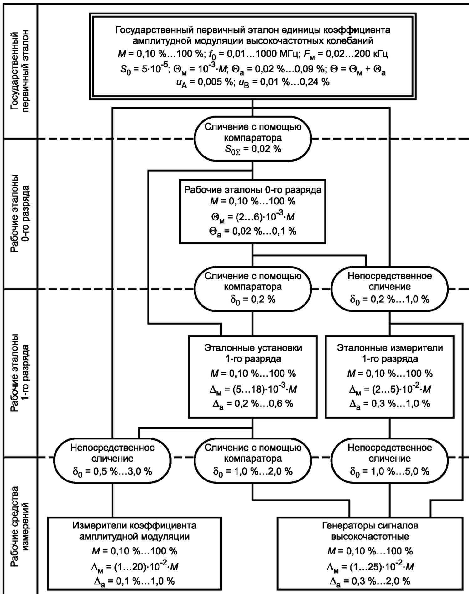
Примечание –  $\delta_0$  – погрешность передачи единицы коэффициента амплитудной модуляции.
