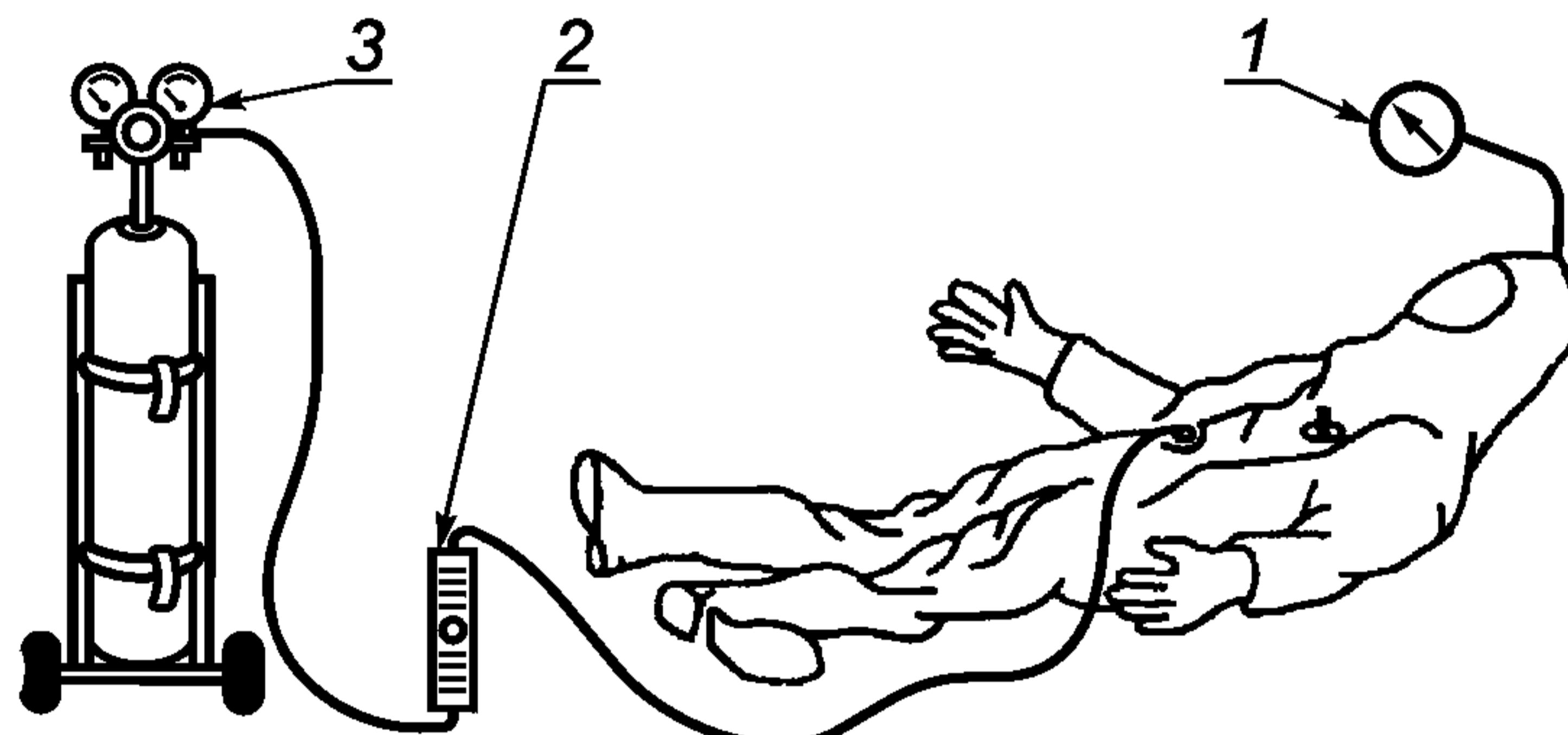
1 — манометр; 2 — расходомер; 3 — источник сжатого воздуха
