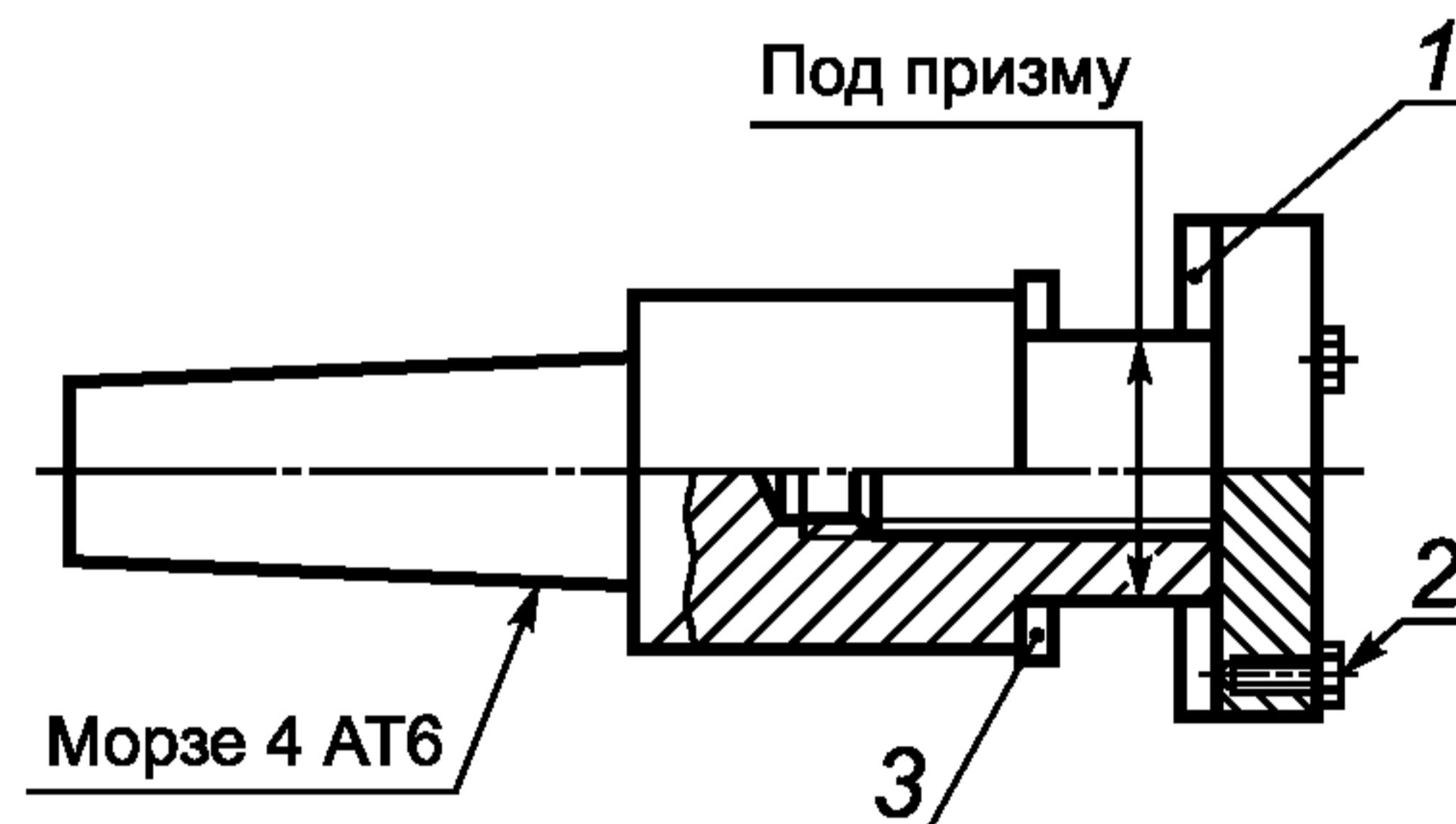
1 — шайба стальная; 2 — винт юстировочный; 3 — шайба фторопластовая
