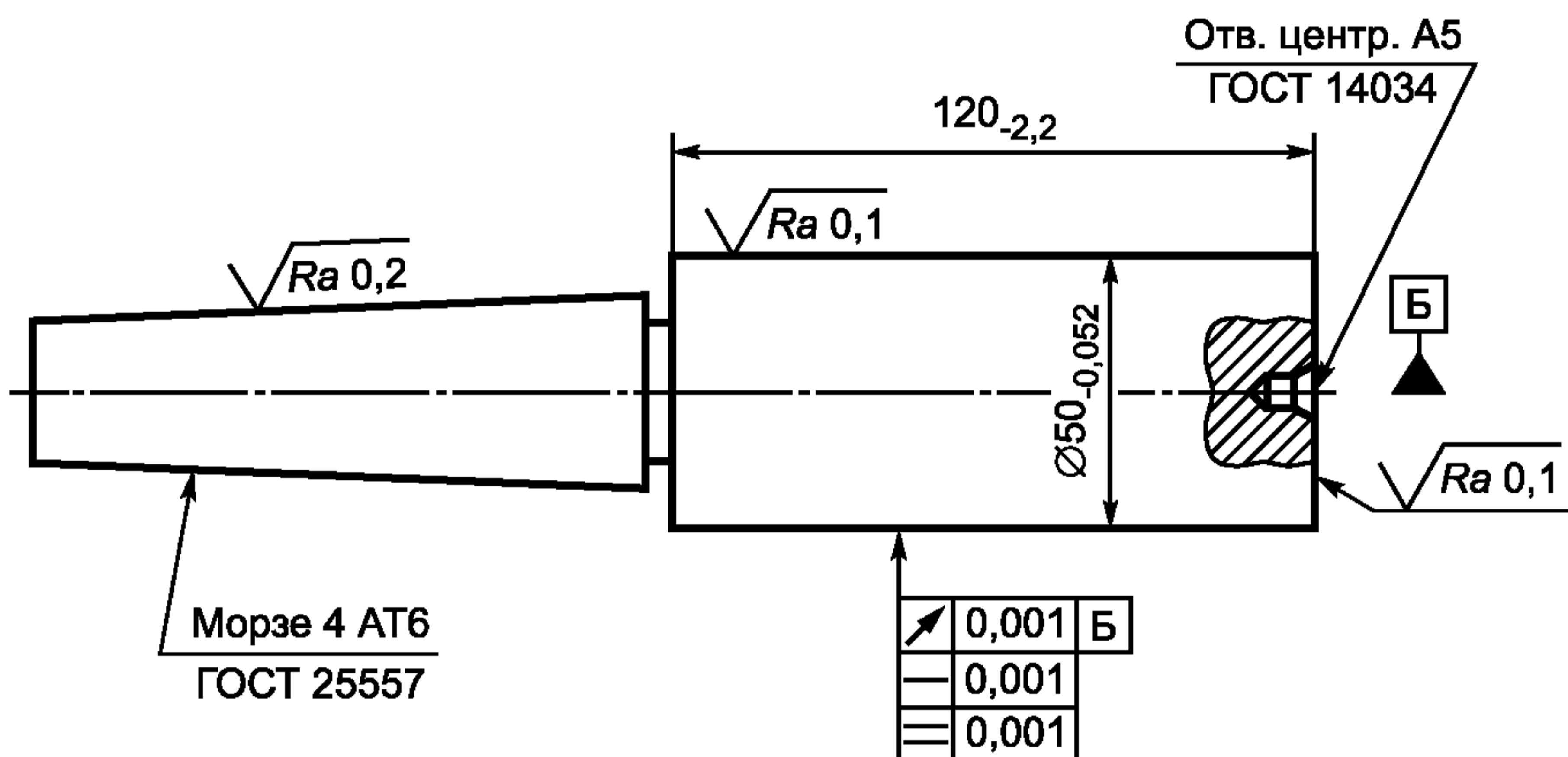
**П р и м е ч а н и е** — Материал — ХВГ по ГОСТ 5950. Твердость (61—65)  $HR_c$ . Параметр шероховатости  $R_a$  неуказанных поверхностей не более 1,6 мкм на базовой длине 0,8 мм.
