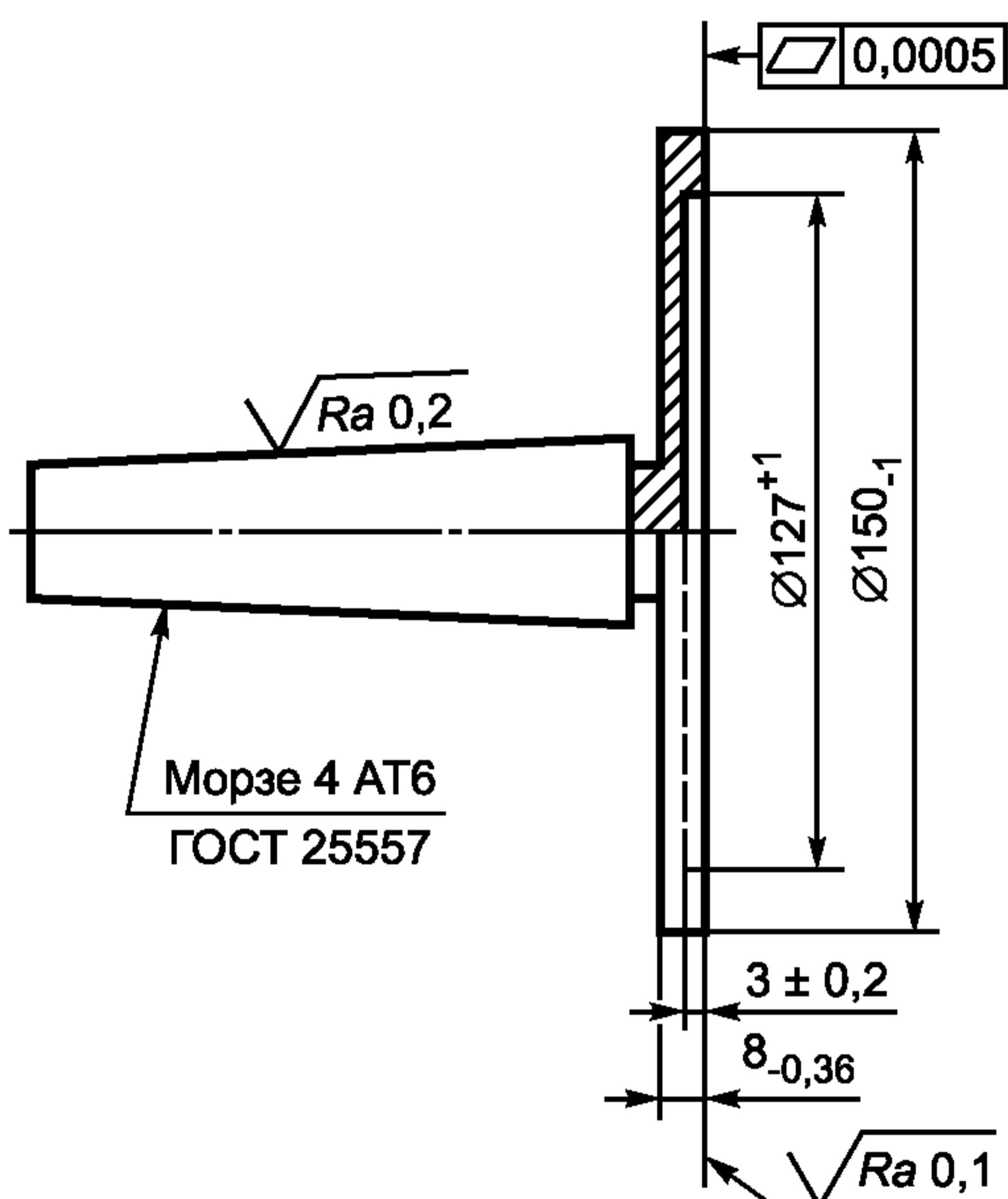
**П р и м е ч а н и е** — Материал — ХВГ по ГОСТ 5950. Твердость (61—65)  $HR_c$ . Параметр шероховатости  $R_a$  неуказанных поверхностей не более 1,6 мкм на базовой длине 0,8 мм. Торцевое биение на диаметре 140 мм не более:
