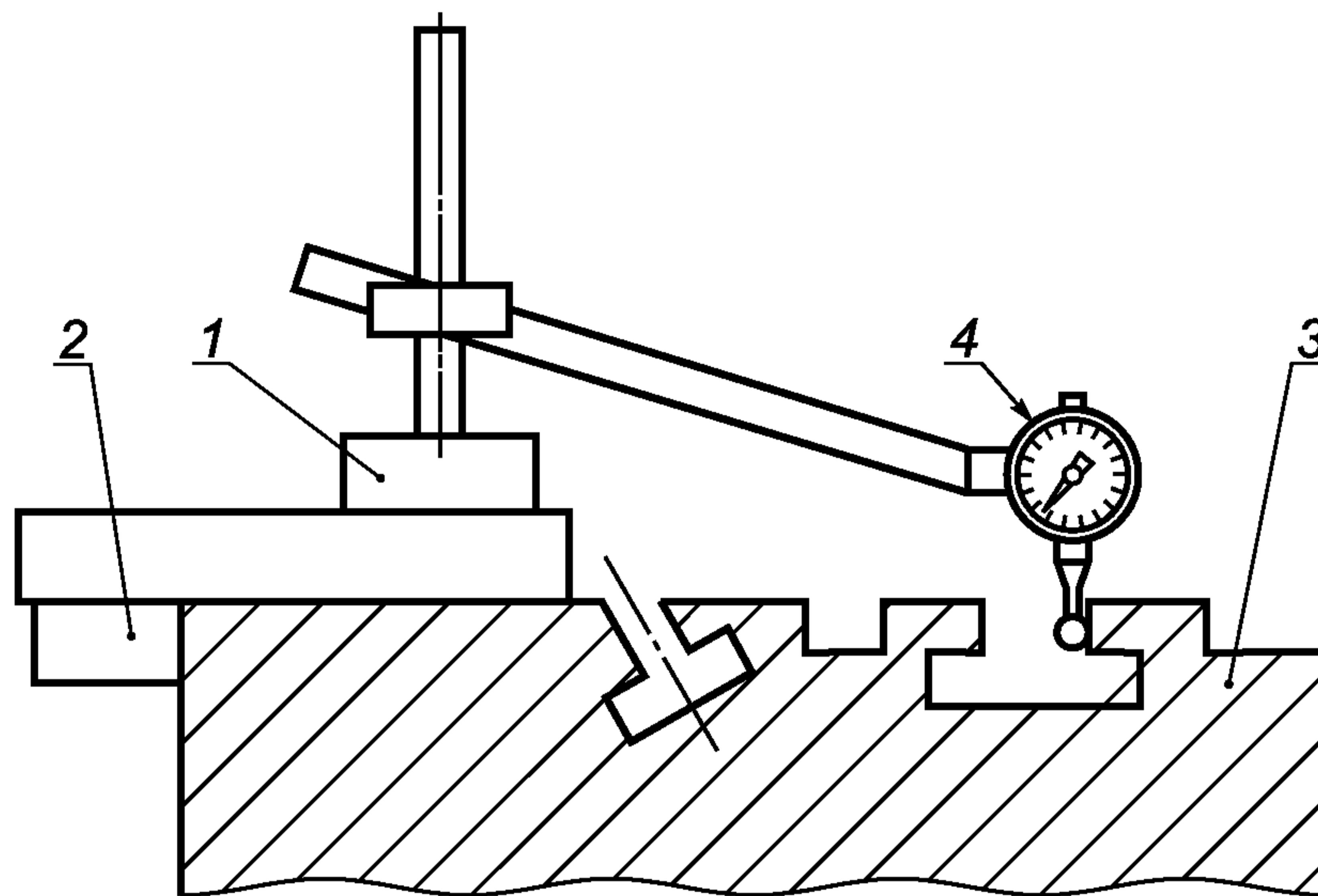
1 — штатив; 2 — упор; 3 — станина; 4 — рычажно-пружинная измерительная головка
