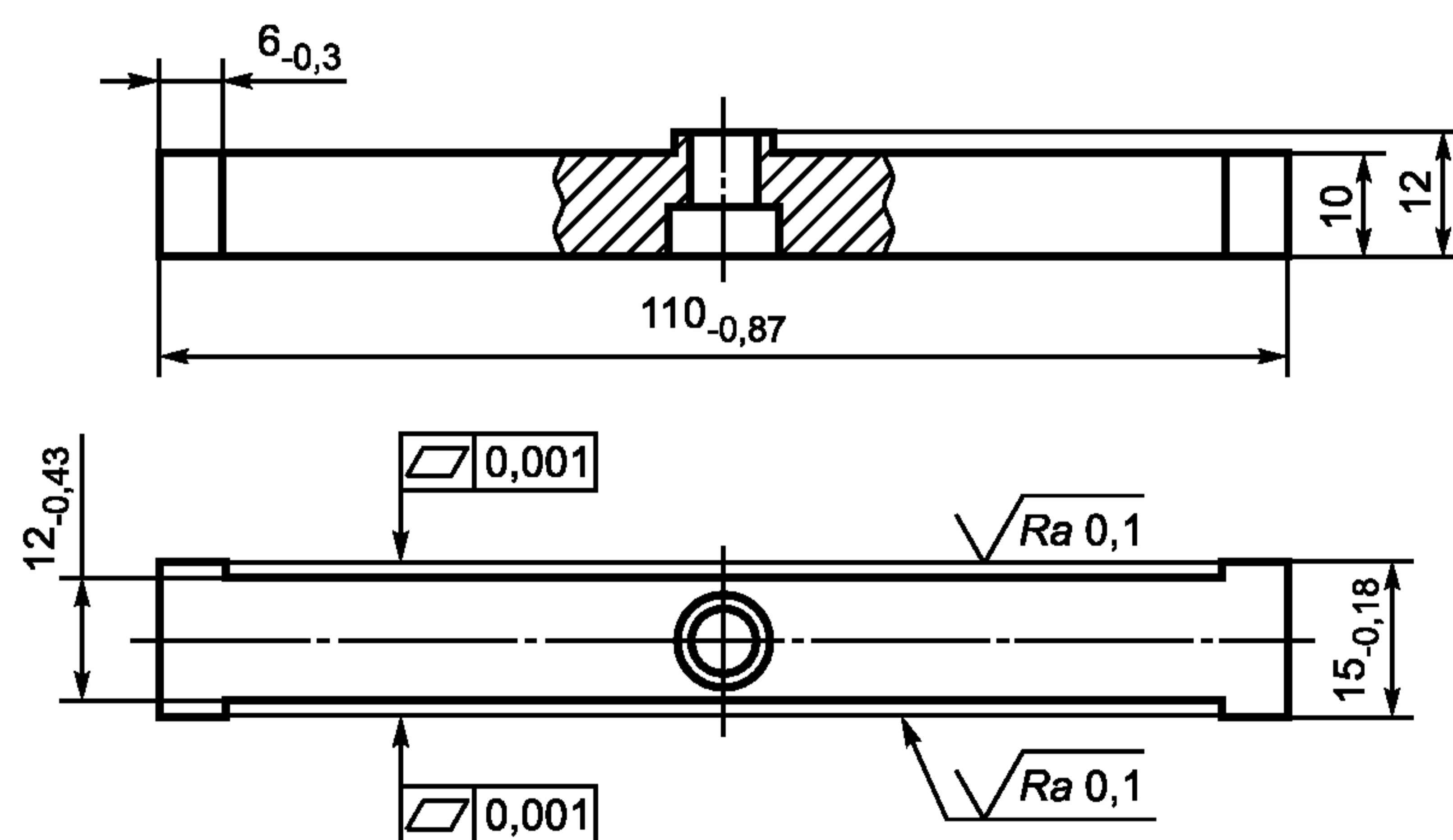
П р и м е ч а н и е — Материал — ХВГ по ГОСТ 5950. Твердость (61—65)  $HR_C$ . Параметр шероховатости  $R_a$  неуказанных поверхностей не более 1,6 мкм на базовой длине 0,8 мм. Покрытие — химическое оксидирование.
