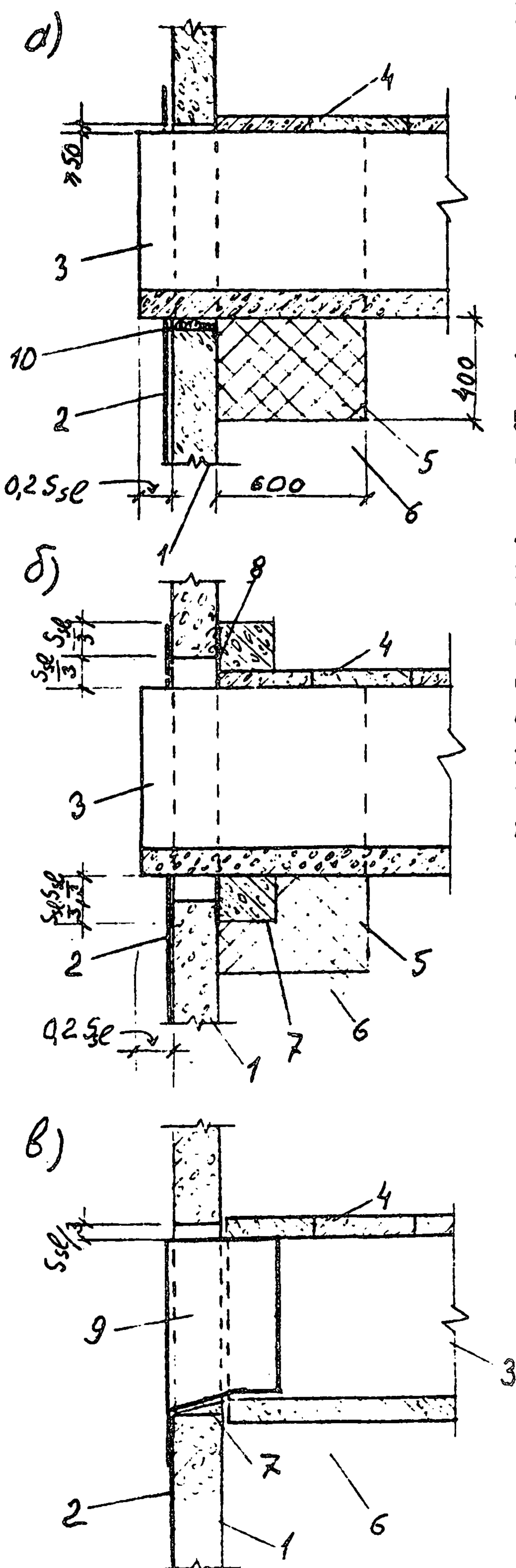
Рис. 2.5. Вход лотка поддона или канала в контрольный колодец.
