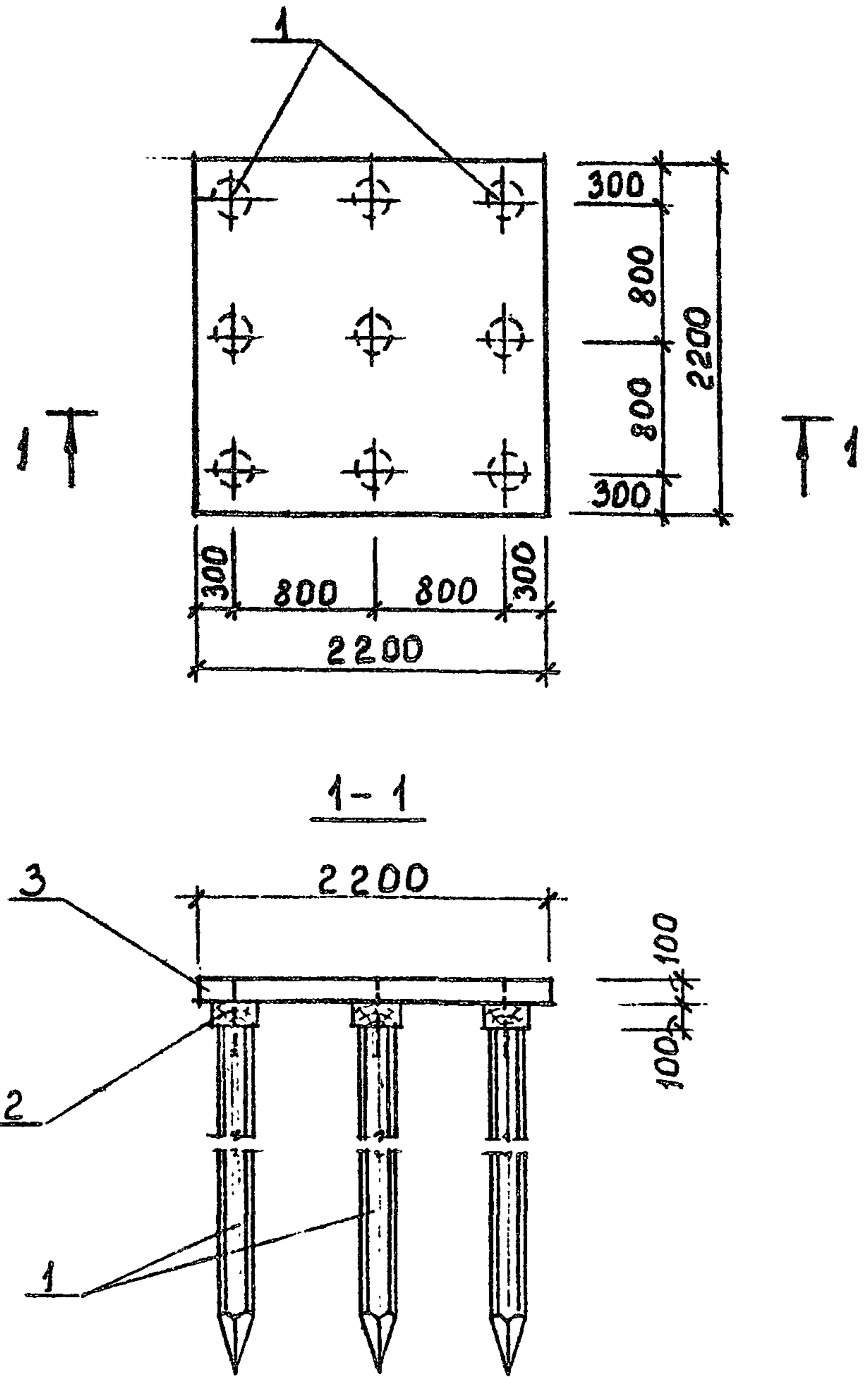
Рис. 4.8. Деревянное свайное основание для колодцев диаметром 1500мм.
