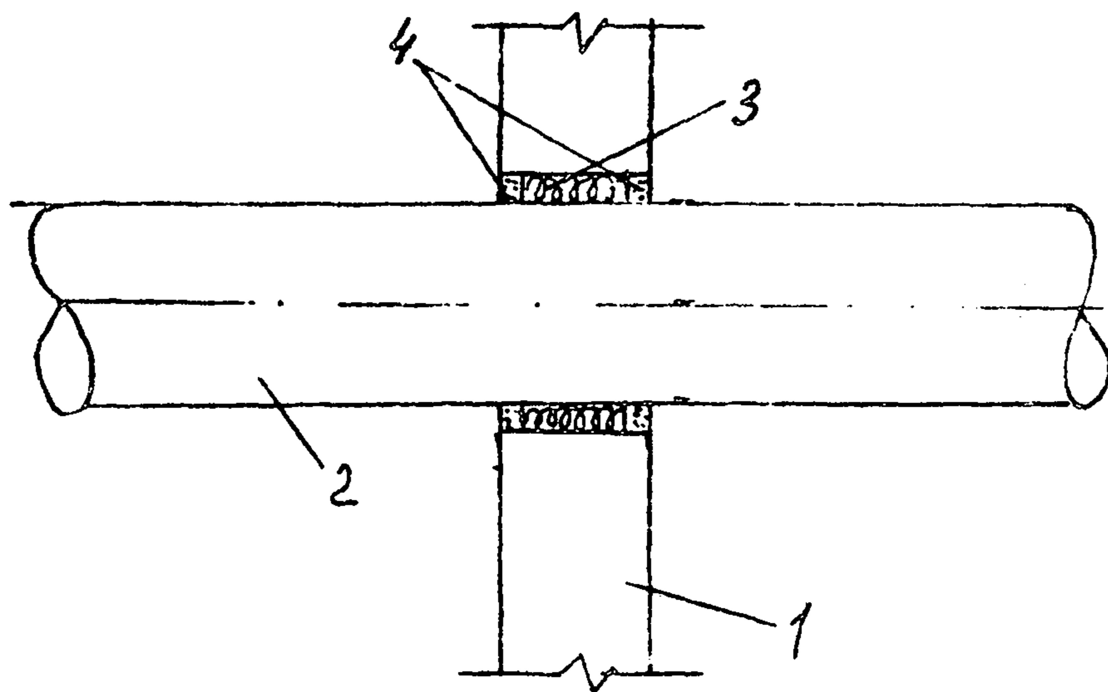
Рис. 2.7. Эластичная заделка трубы.
