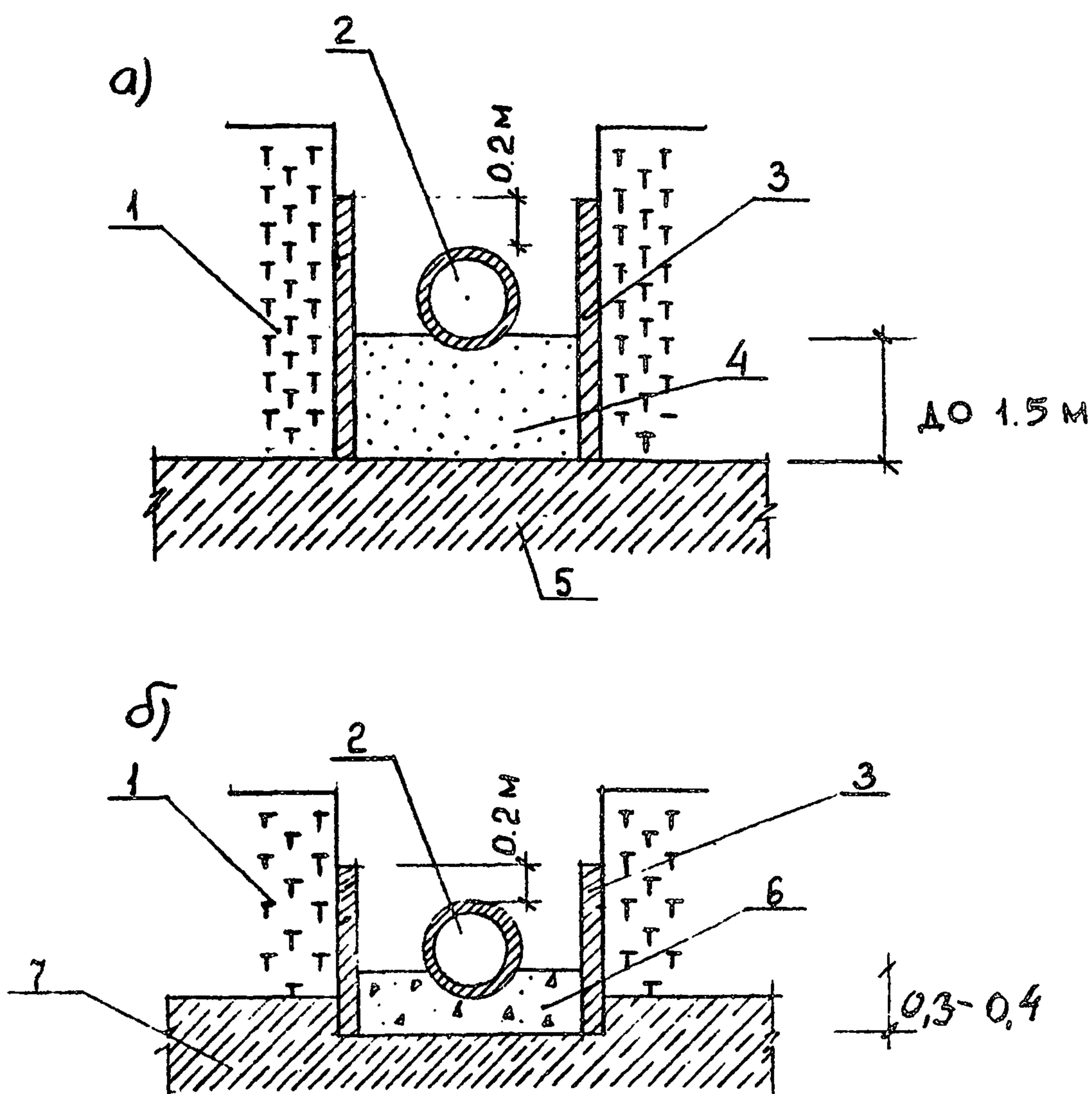
Рис. 4.1. Траншейная прокладка трубопроводов.
