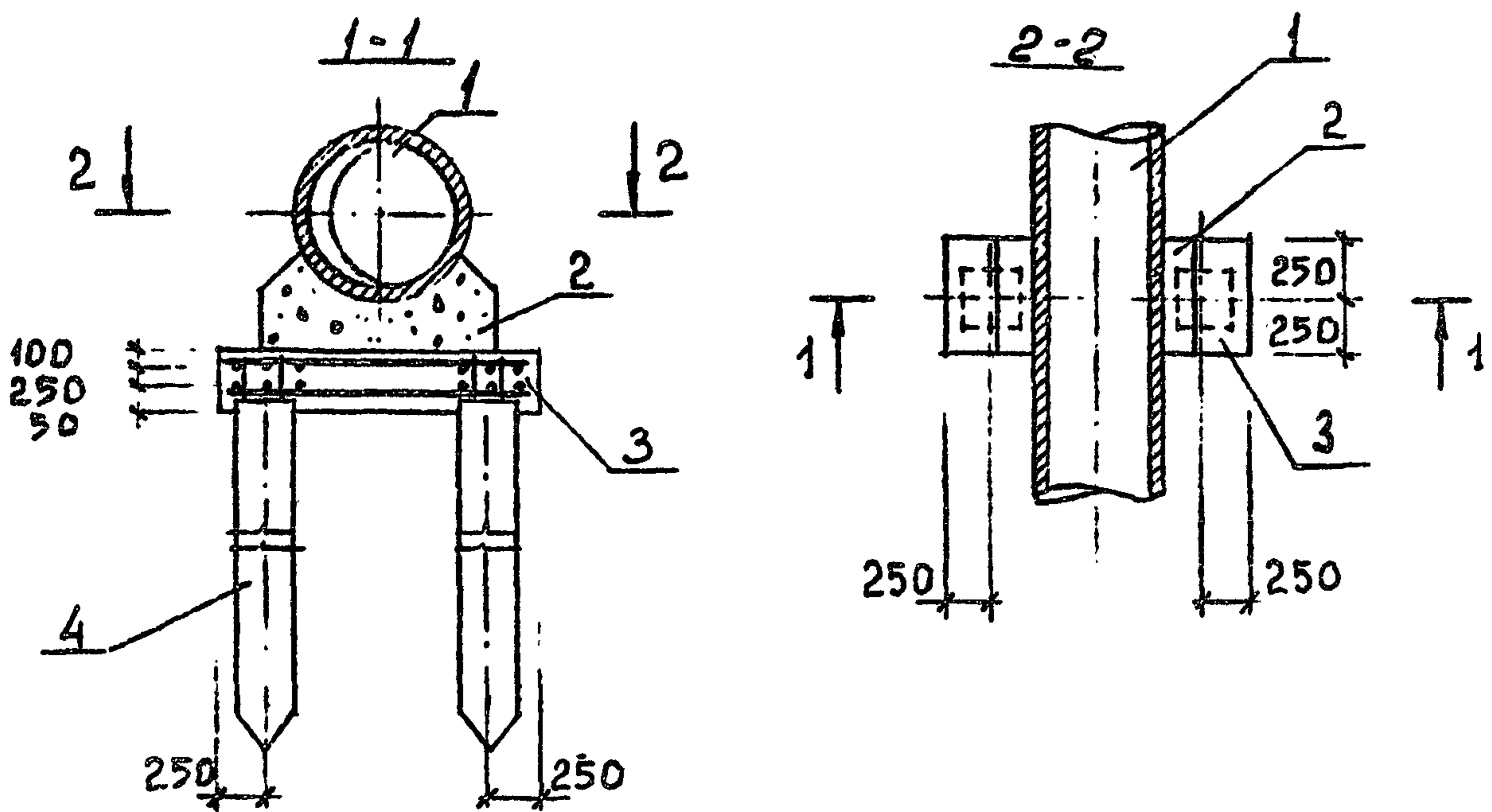
Рис. 4.3. Железобетонное свайное основание трубопроводов.
