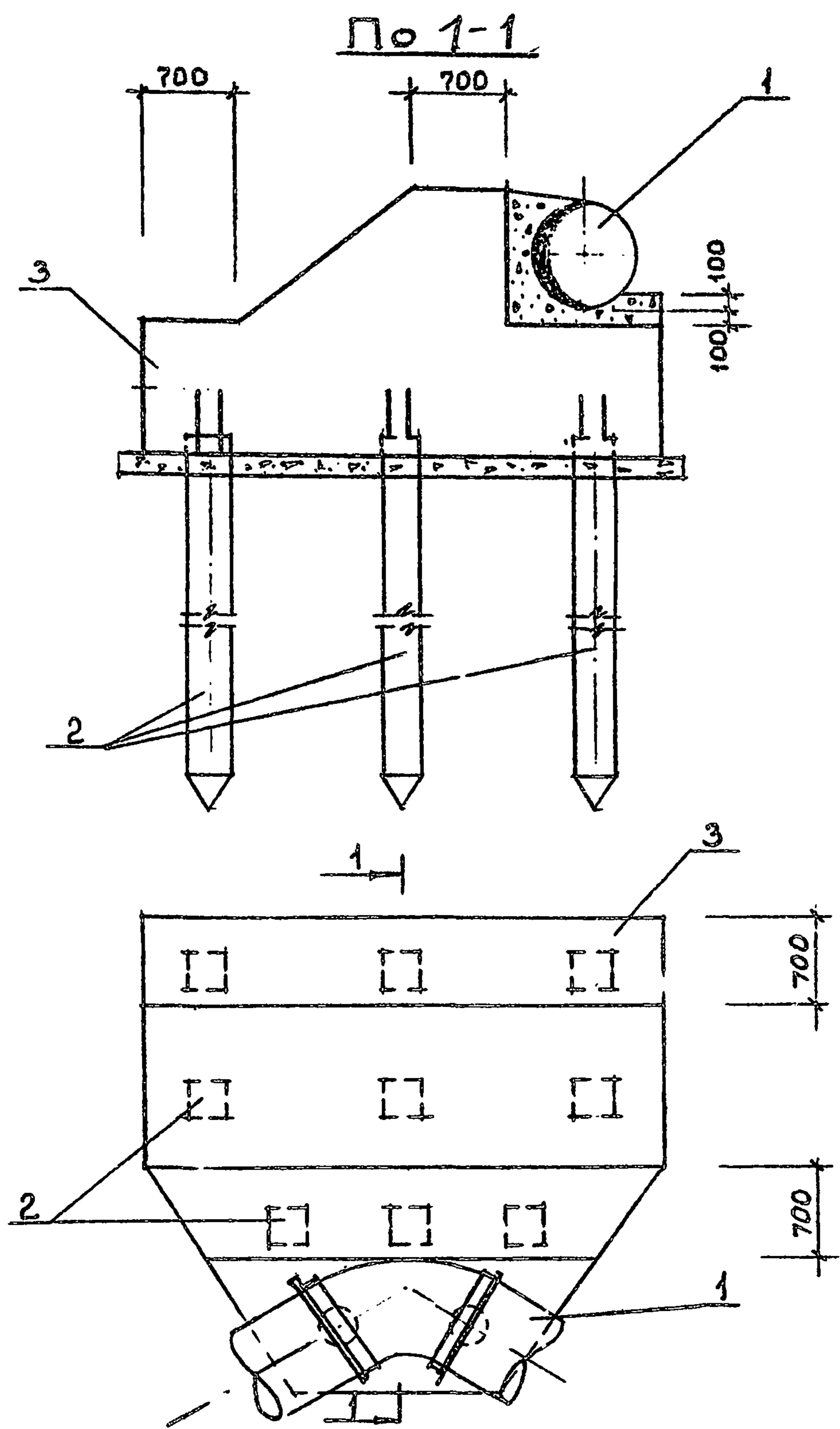
Рис. 4.6. Горизонтальный упор на свайном основании.
