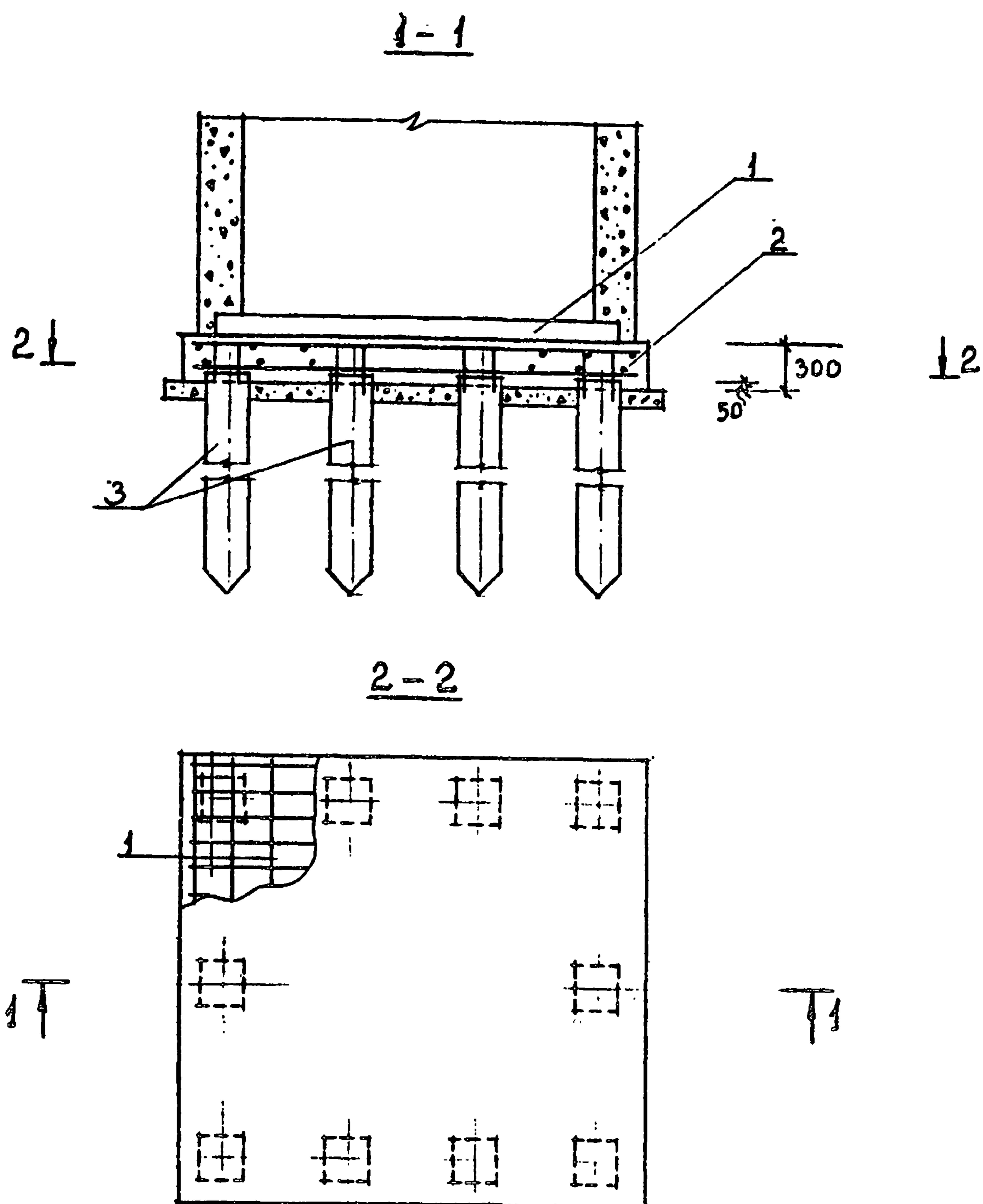
Рис. 4.9. Железобетонное свайное основание прямоугольных колодцев.
