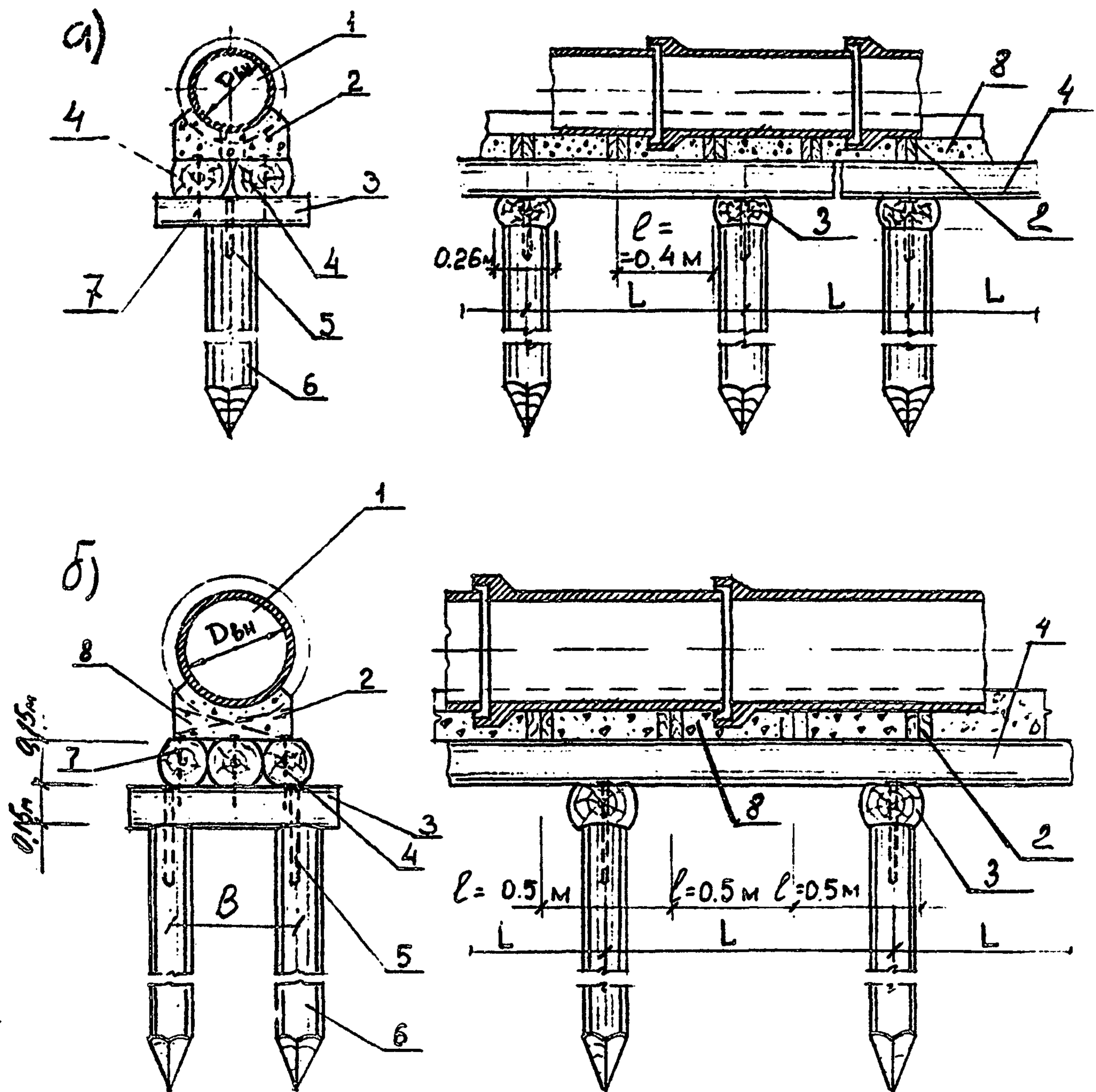
Рис. 4.5. Деревянное основание для трубопровода канализации.
