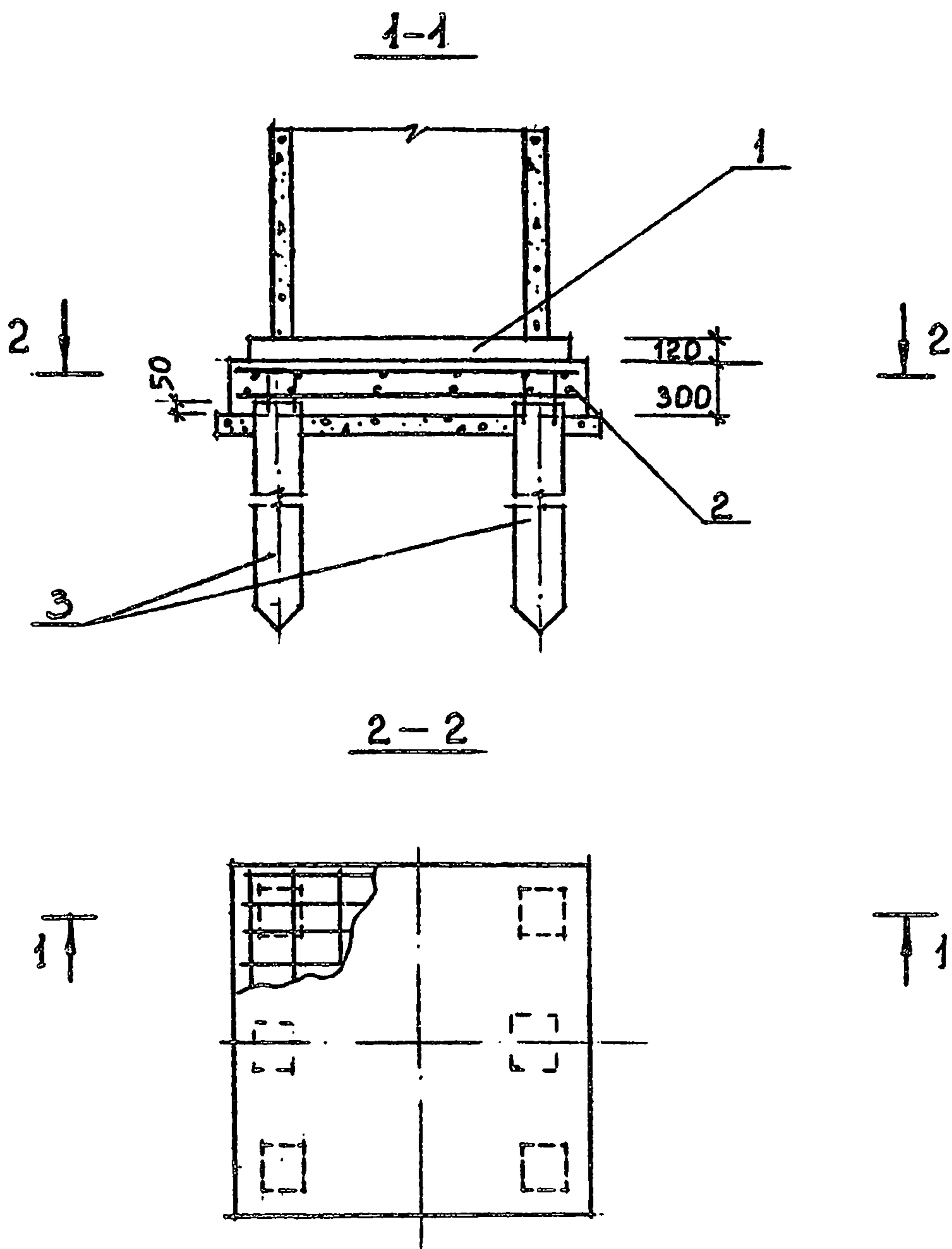
Рис. 4.7. Железобетонное свайное основание круглых колодцев.
