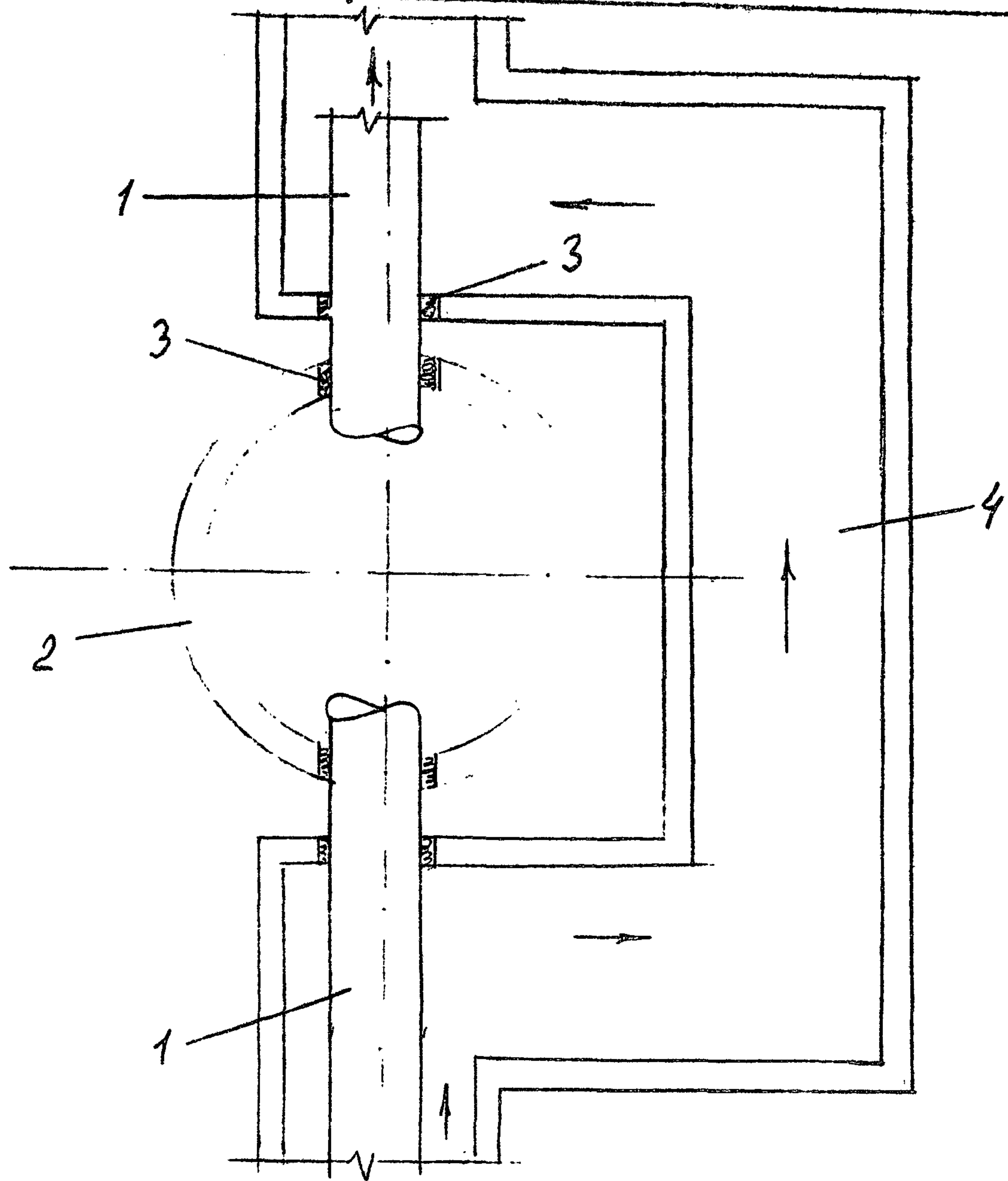
Рис. 2.2. Обход поддоном или каналом сетевого колодца.
