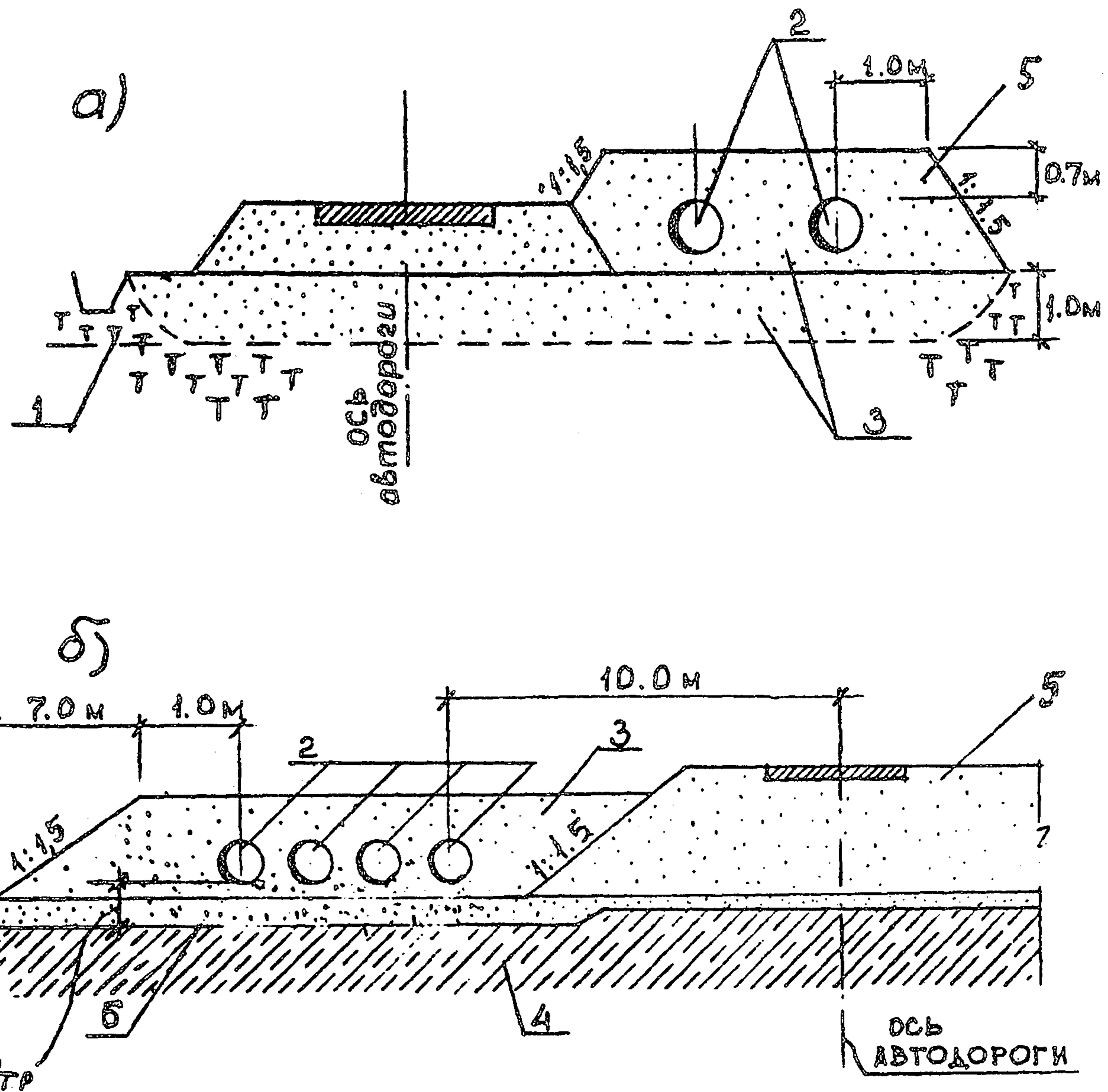
Рис. 4.2. Прокладка трубопроводов в насыпи.
