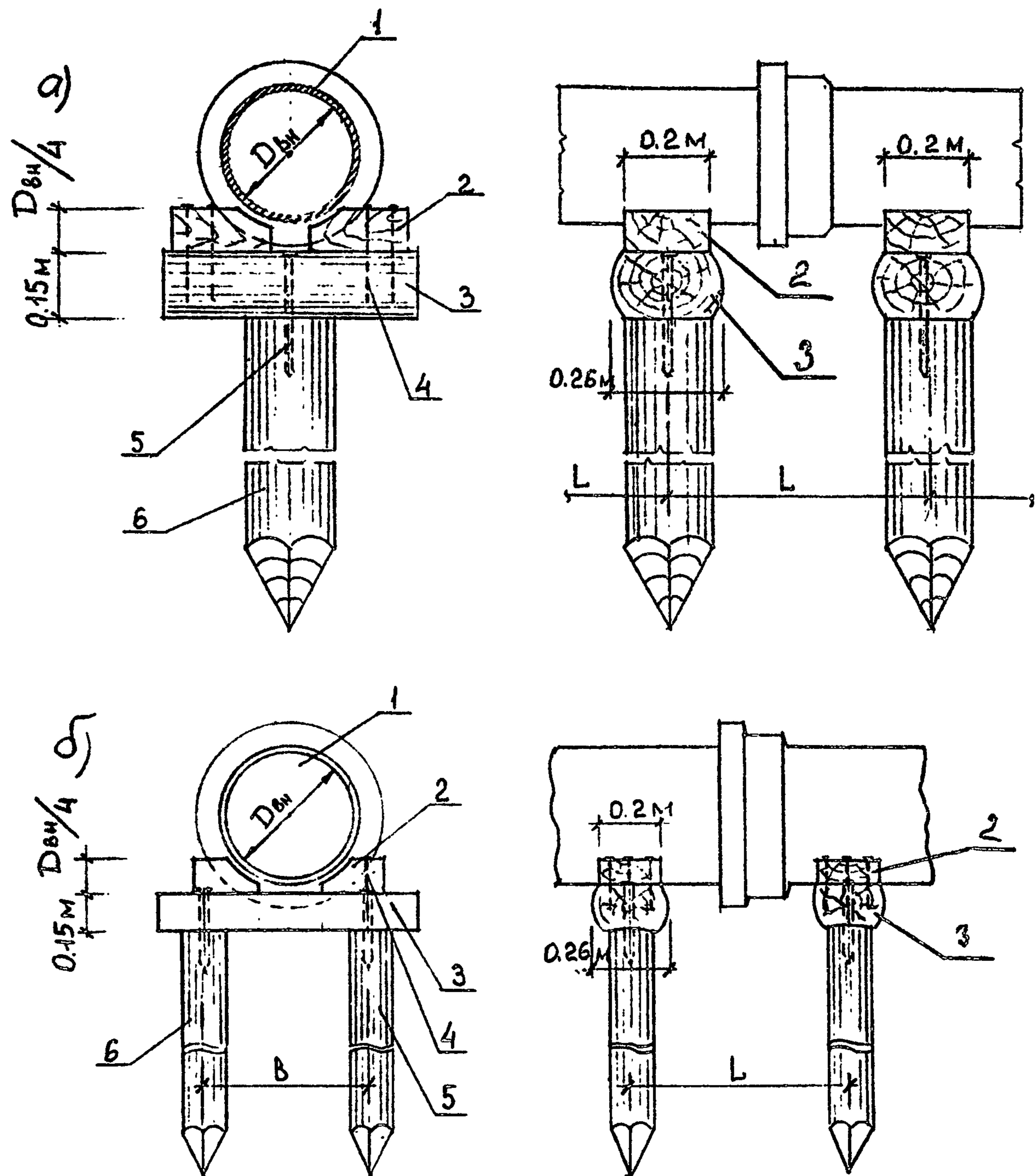
Рис. 4.4. Деревянное свайное основание для трубопровода водопровода.
