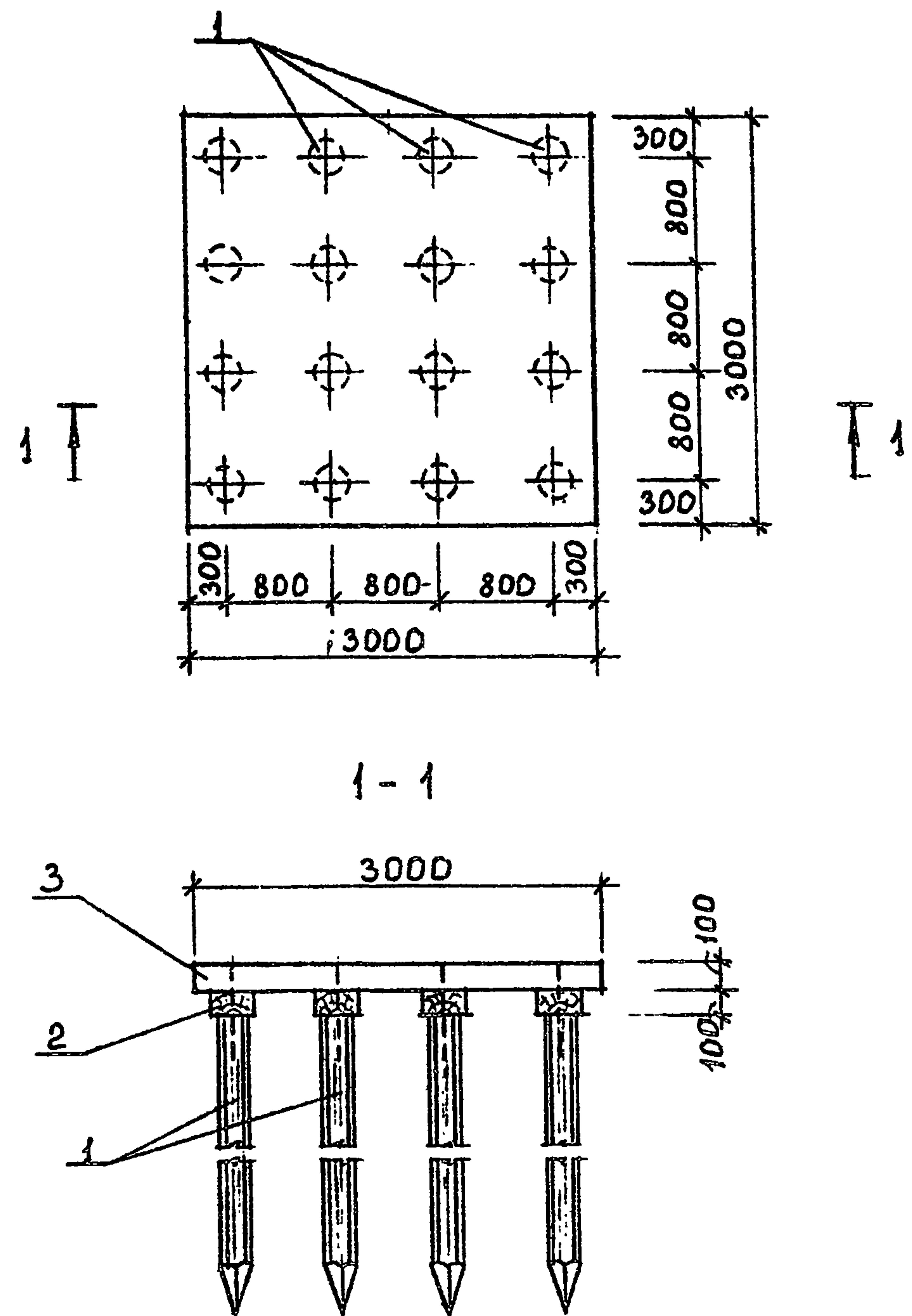
Рис. 4.10. Деревянное свайное основание прямоугольных колодцев 2000x2500 и 2500 x 2500 мм.
