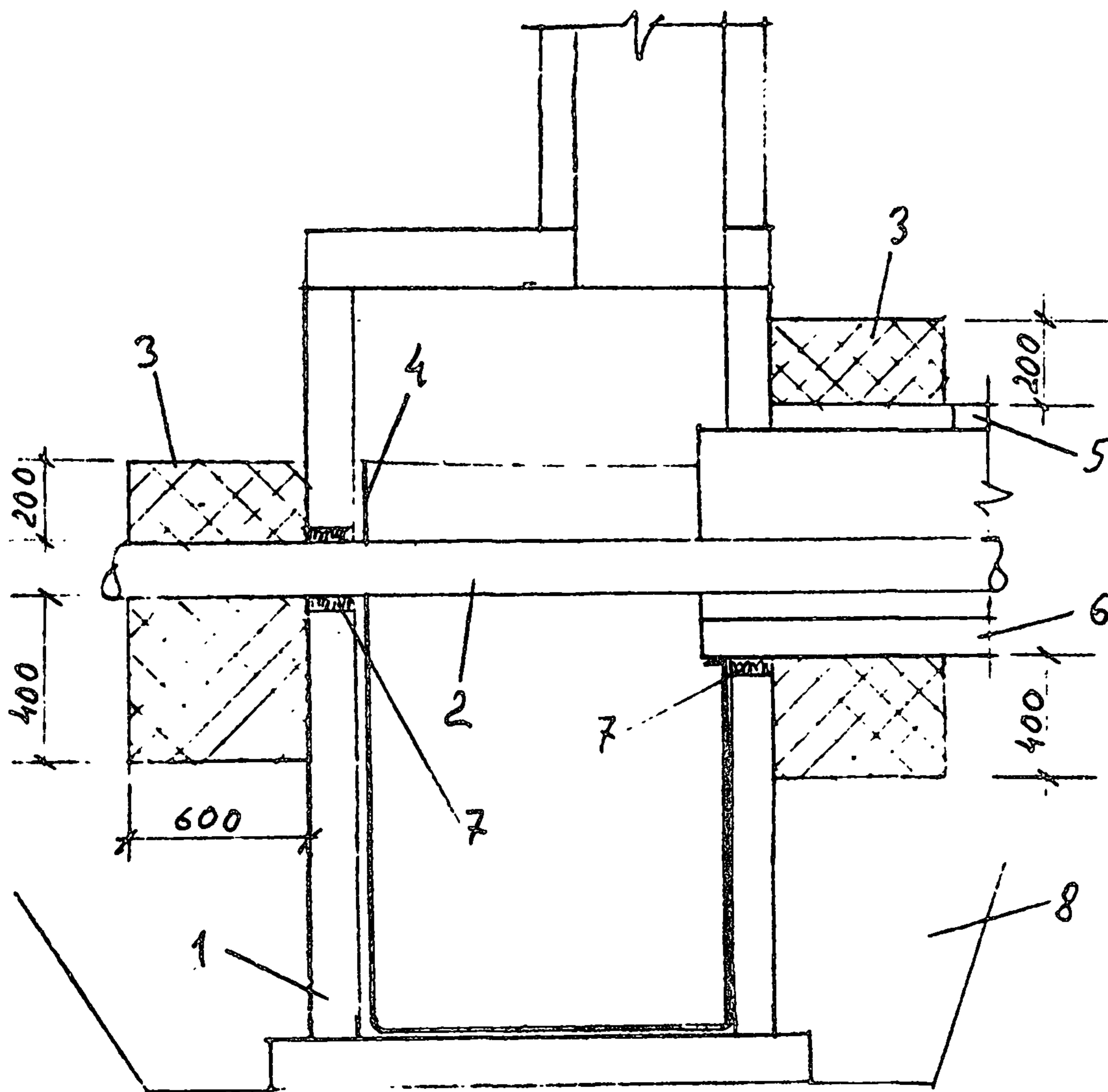
Рис. 2.4. Контрольный колодец на воде в здание.
