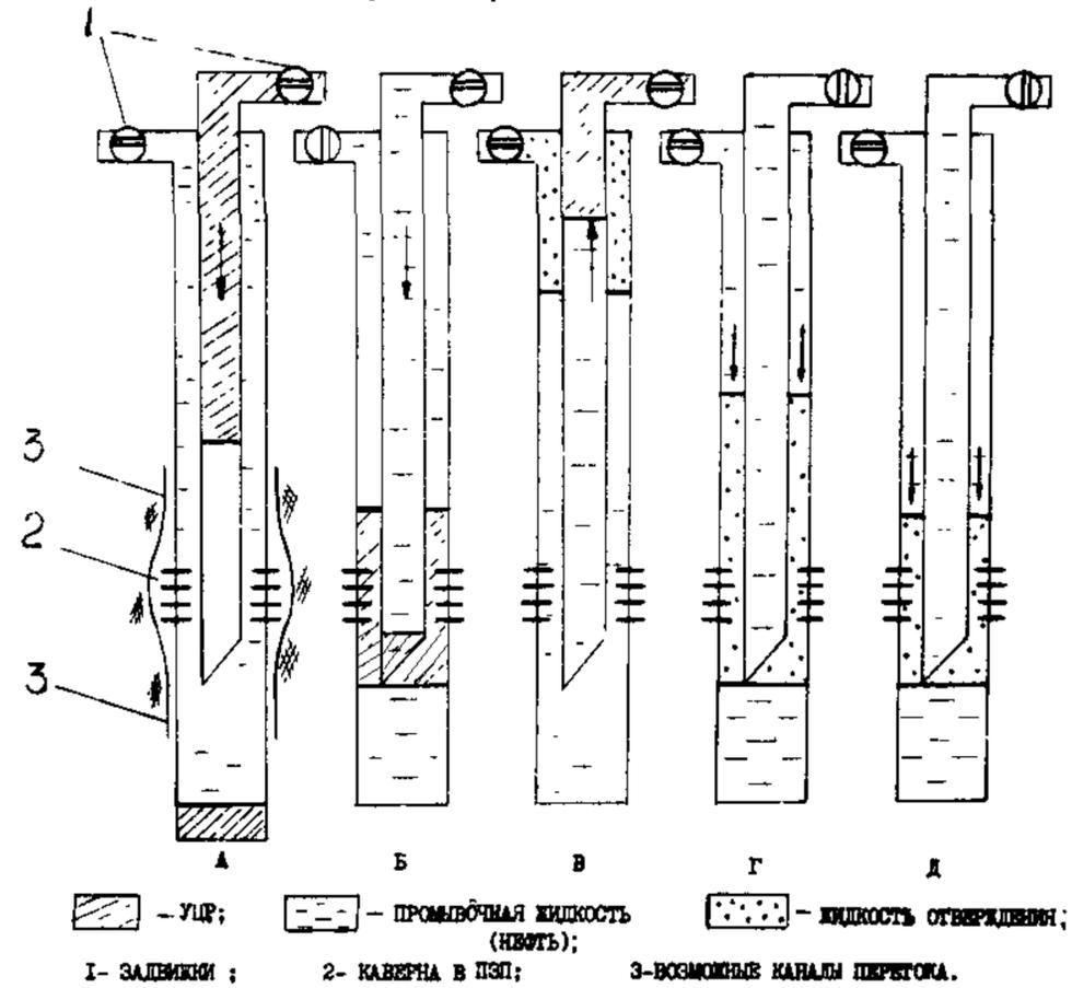
1 - задвижки; 2 - каверна в ПЗП; 3 - возможные каналы перетоков в заколонном пространстве;
