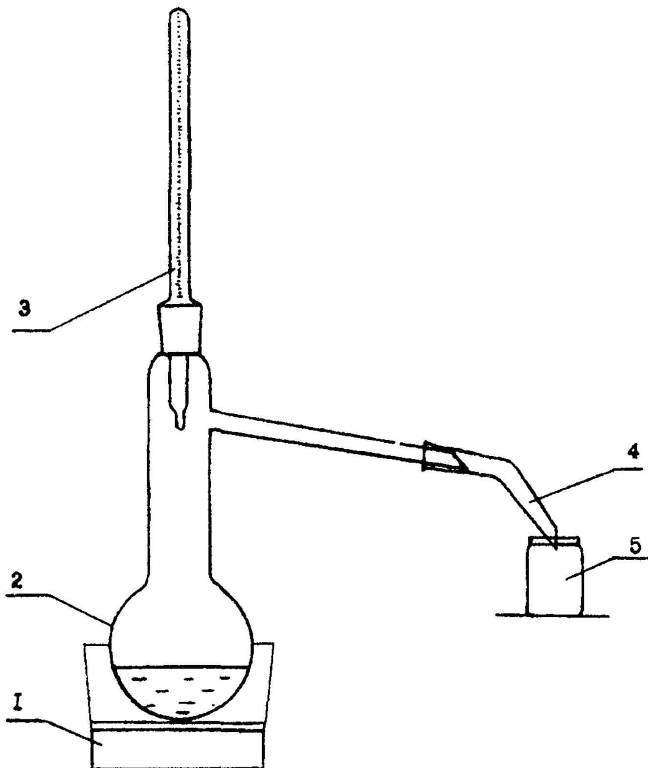
**Рис. 1.** Схема перегонки фенола.
