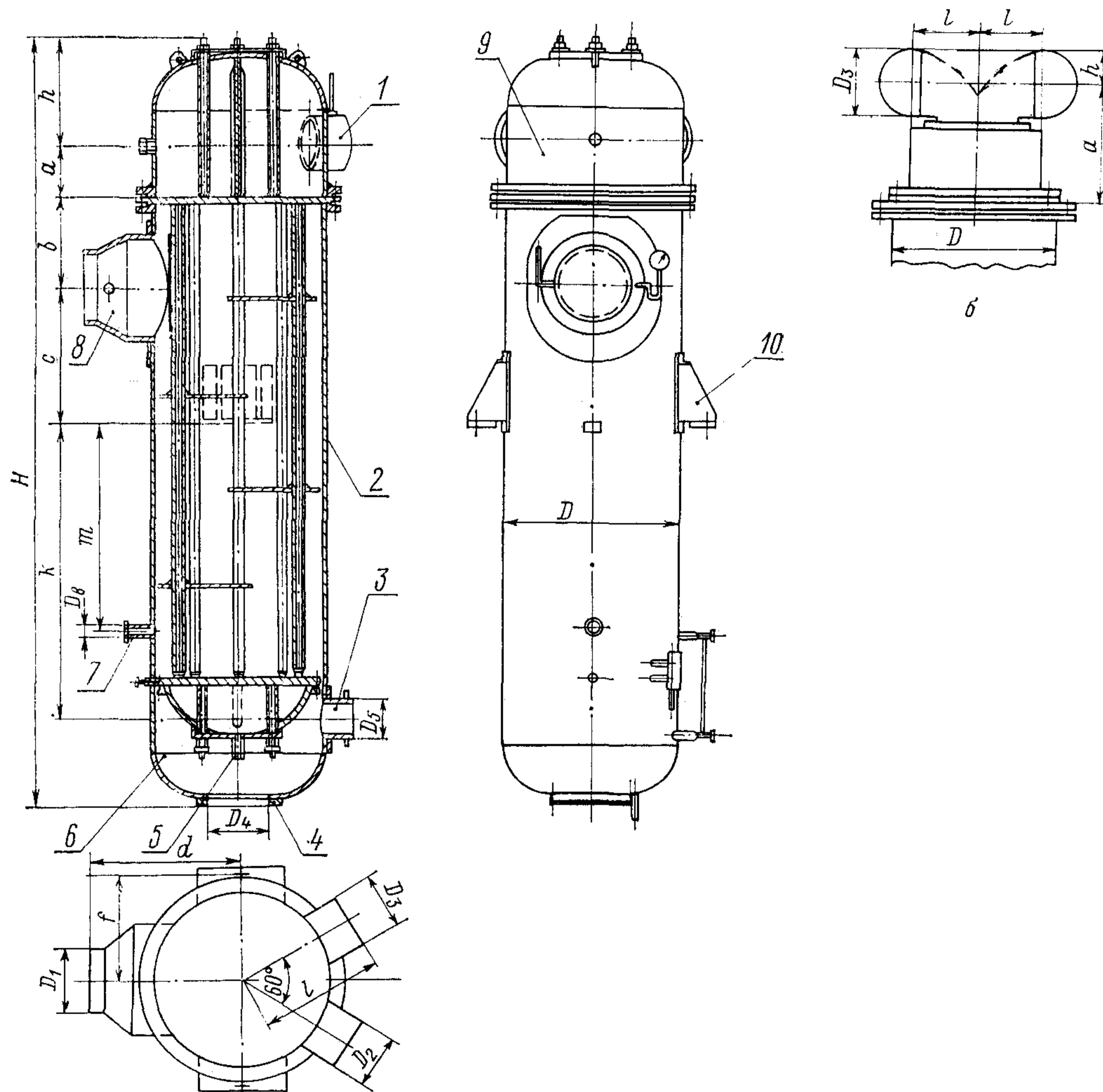
*a — общий вид; б — исполнение верхней водяной камеры для ПСВ-315-3-23, ПСВ-315-14-23, ПСВ-500-3-23 и ПСВ-500-14-23; 1 — патрубки входа и выхода воды; 2 — корпус; 3 — прием конденсата; 4 — выход конденсата греющего пара; 5 — слив воды из трубной системы; 6 — нижняя «плавающая» водяная камера; 7 — отсос воздуха; 8 — патрубок входа пара; 9 — верхняя водяная камера; 10 — опорная лапа*
