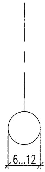
5.3.2 Цифрами обозначают координационные оси по стороне здания с большим количеством осей.
